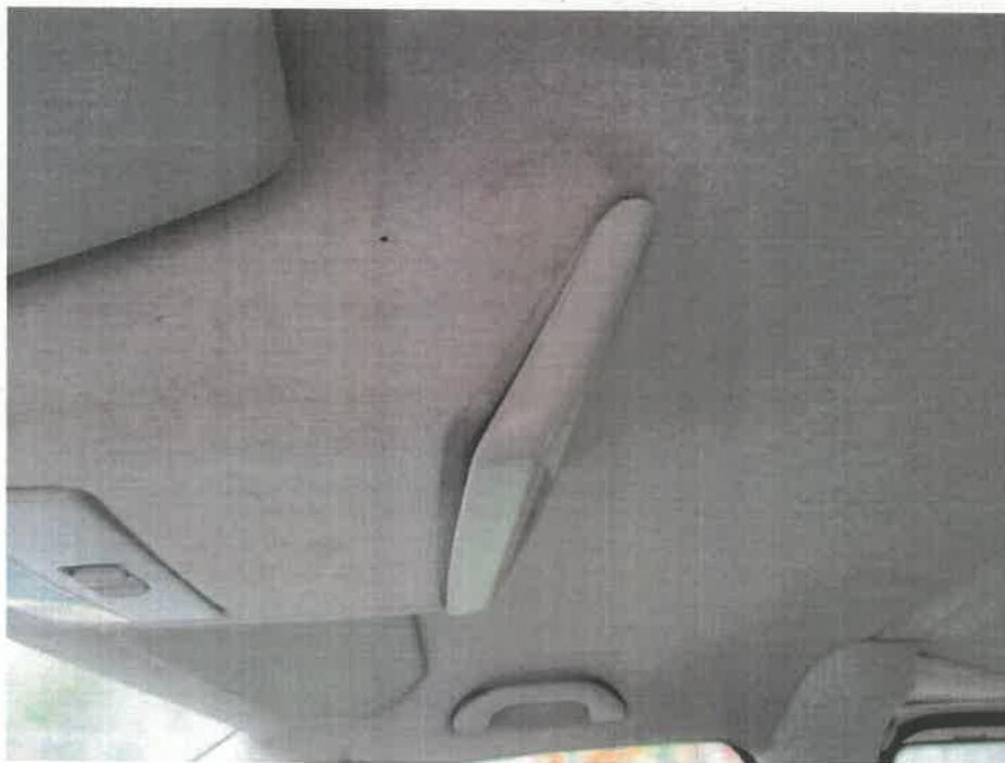
Bild 11 : Innenraum Verschmutzt und Blenden lose
