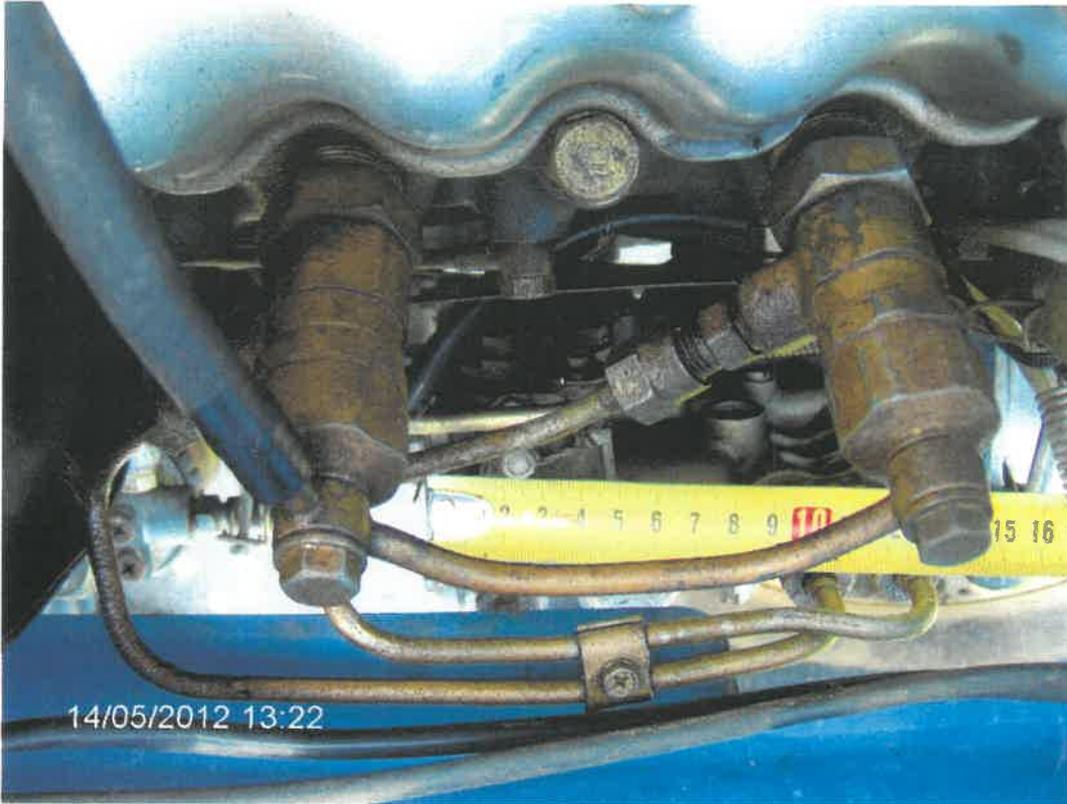
Bild 7: Regelgestänge (EP) in Leerlaufstellung
