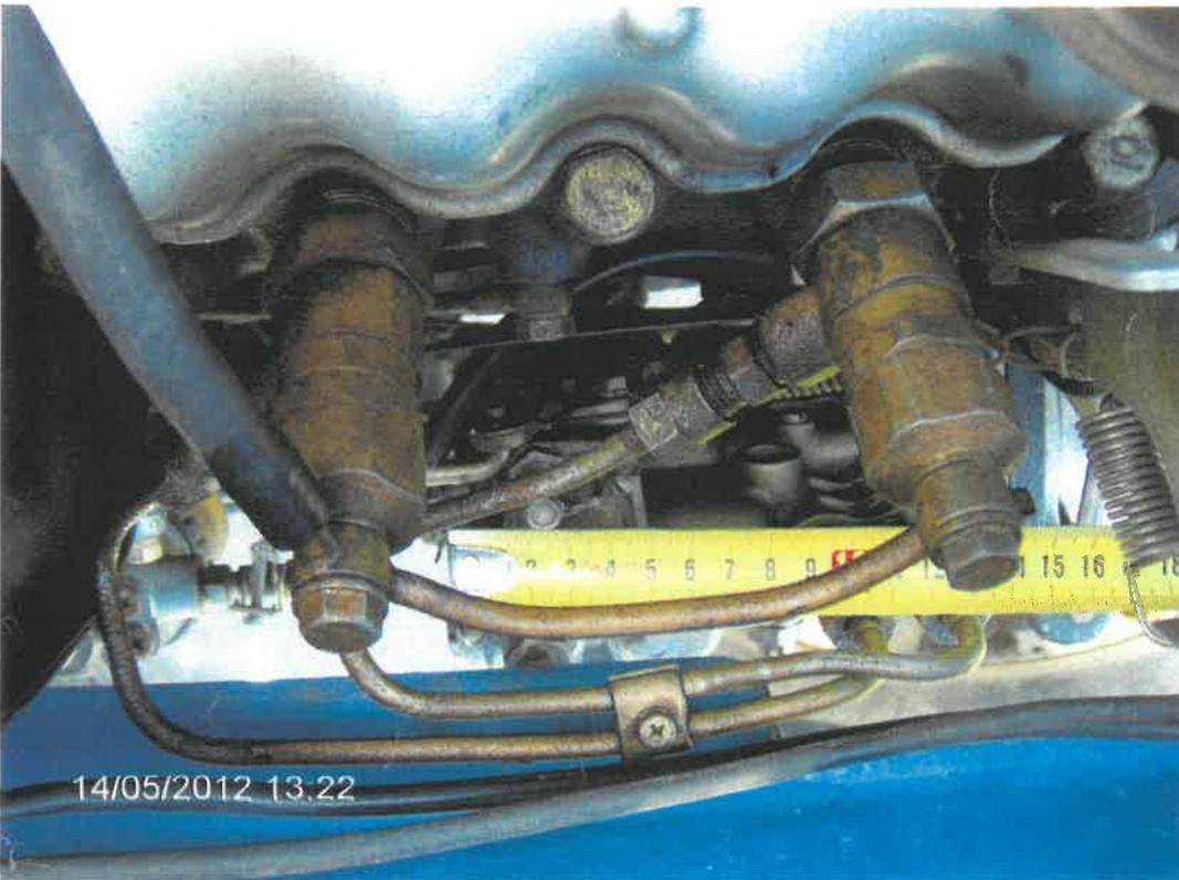
Bild 8: Regelgestänge (EP) in Stellung Volllast
