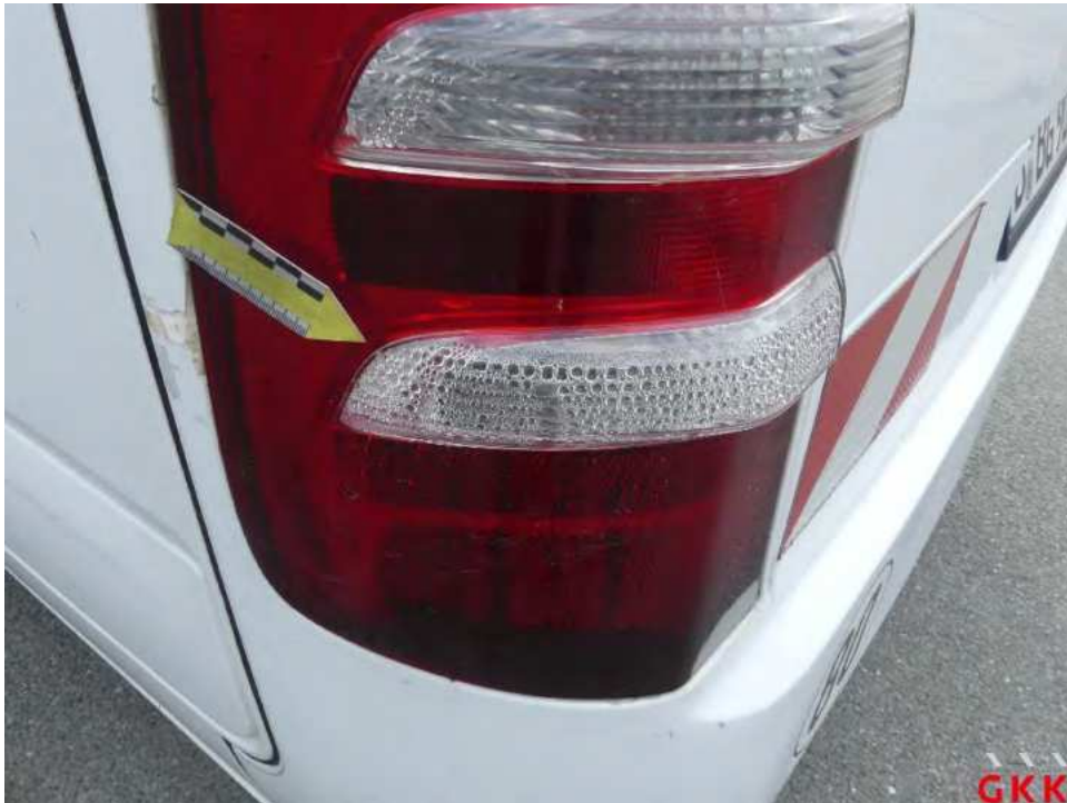
Bild 37 Rückleuchte links, außen, undicht, ersetzen
