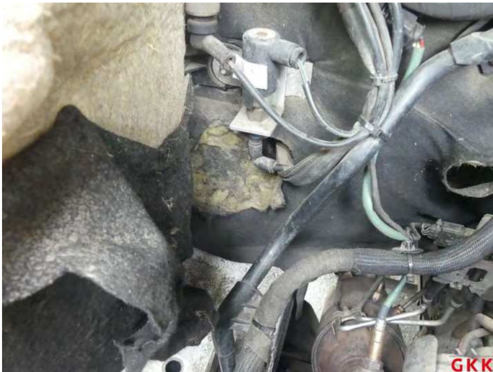
Bild 22 Motorraum, Dämmmatte, beschädigt, ersetzen
