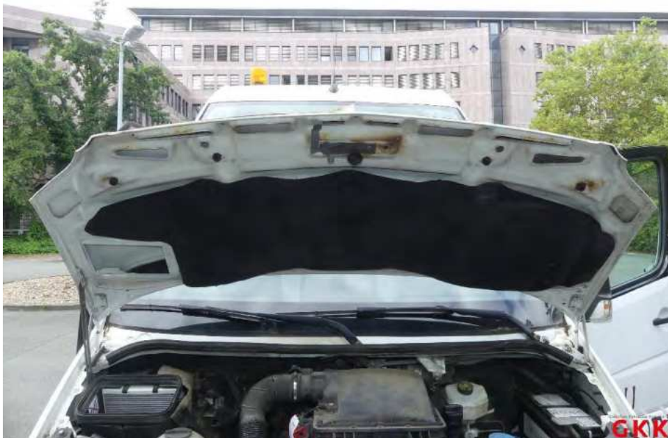
Bild 54 Motorhaube, korrodiert, instand setzen - lackieren
