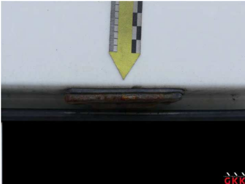
Bild 33 Kennzeichen hinten, Leuchte rechts, korrodiert, ersetzen
