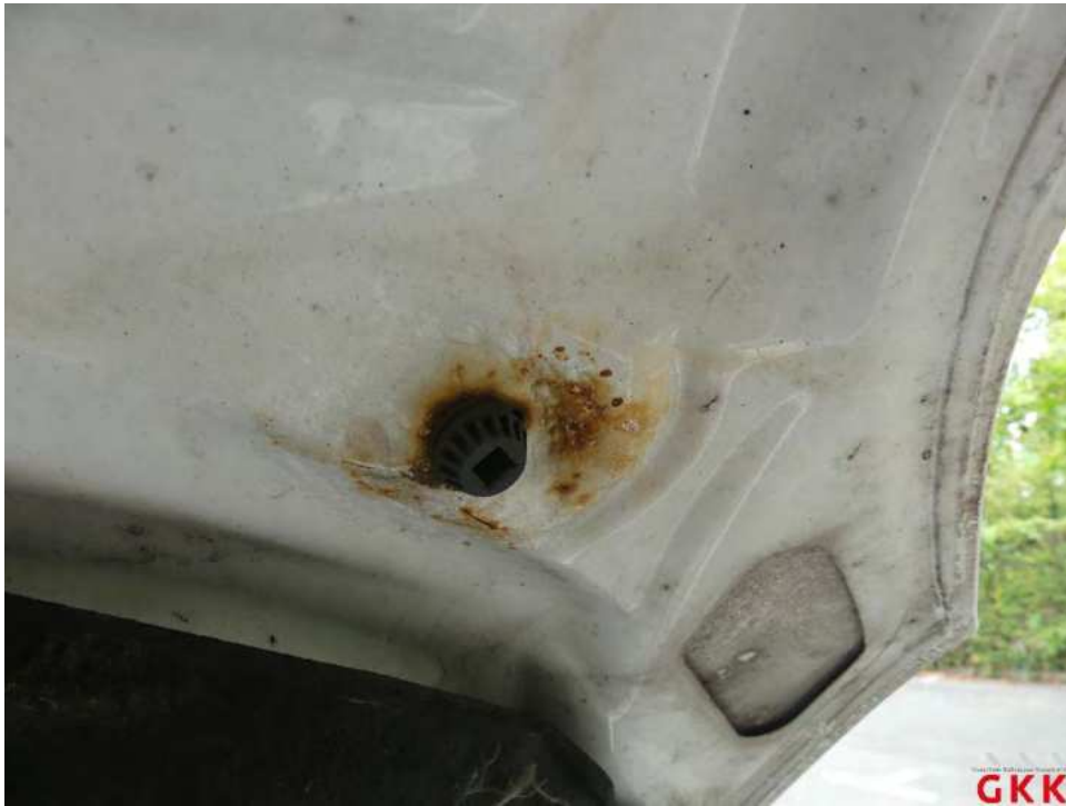
Bild 55 Motorhaube, korrodiert, instand setzen - lackieren
