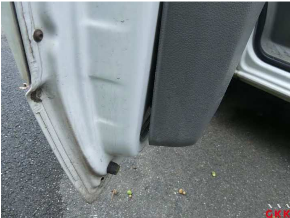
Bild 62 Tür vorne links, Innenverkleidung -Standard-, lose, instand setzen
