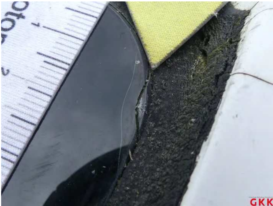
Bild 60 Frontscheibe, gerissen, ersetzen
