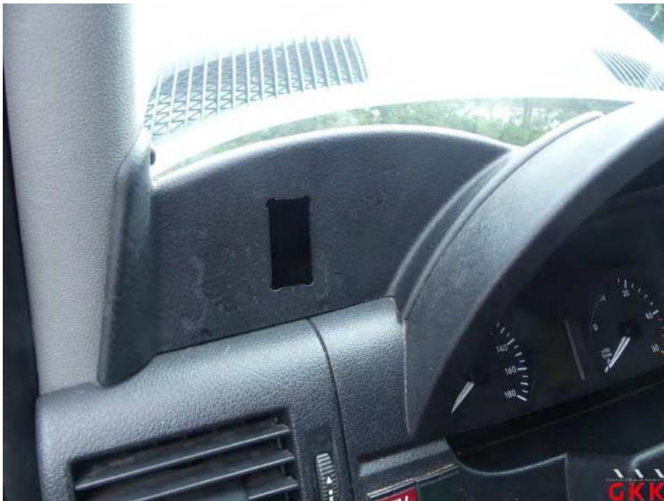
Bild 46 Armaturenbrett, Blende, fehlt, ersetzen
