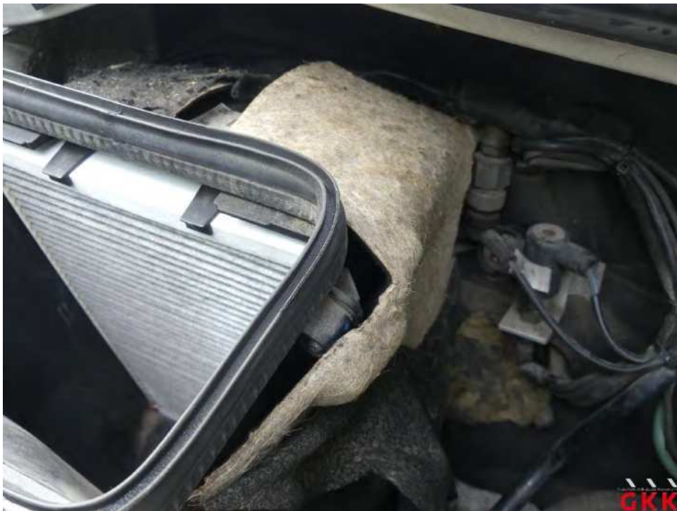
Bild 20 Motorraum, Dämmmatte, beschädigt, ersetzen
