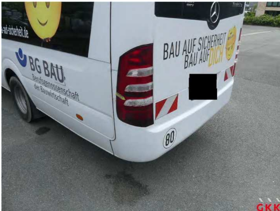
Bild 36 Rückleuchte links, außen, undicht, ersetzen
