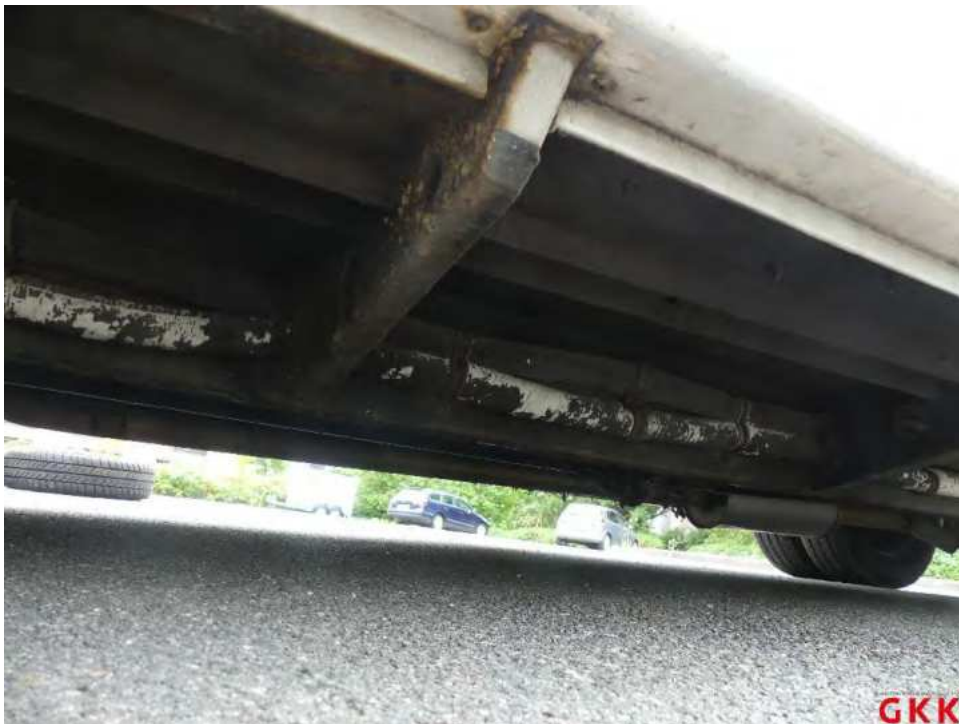
Bild 52 Fahrzeug, Rahmen, korrodiert, instand setzen - lackieren
