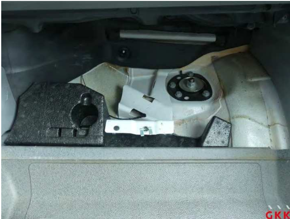
Bild 49 Reifenreparaturset, komplett, fehlt, ersetzen
