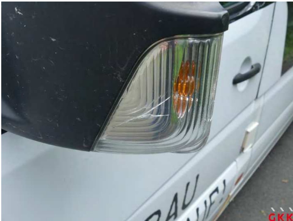
Bild 24 Spiegelgehäuse links, Blinker, beschädigt, ersetzen
