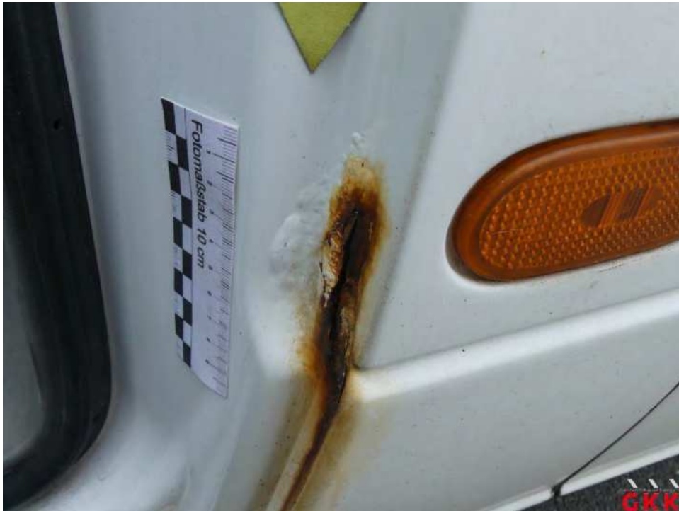
Bild 41 B- Säule links, beschädigt, instand setzen - lackieren
