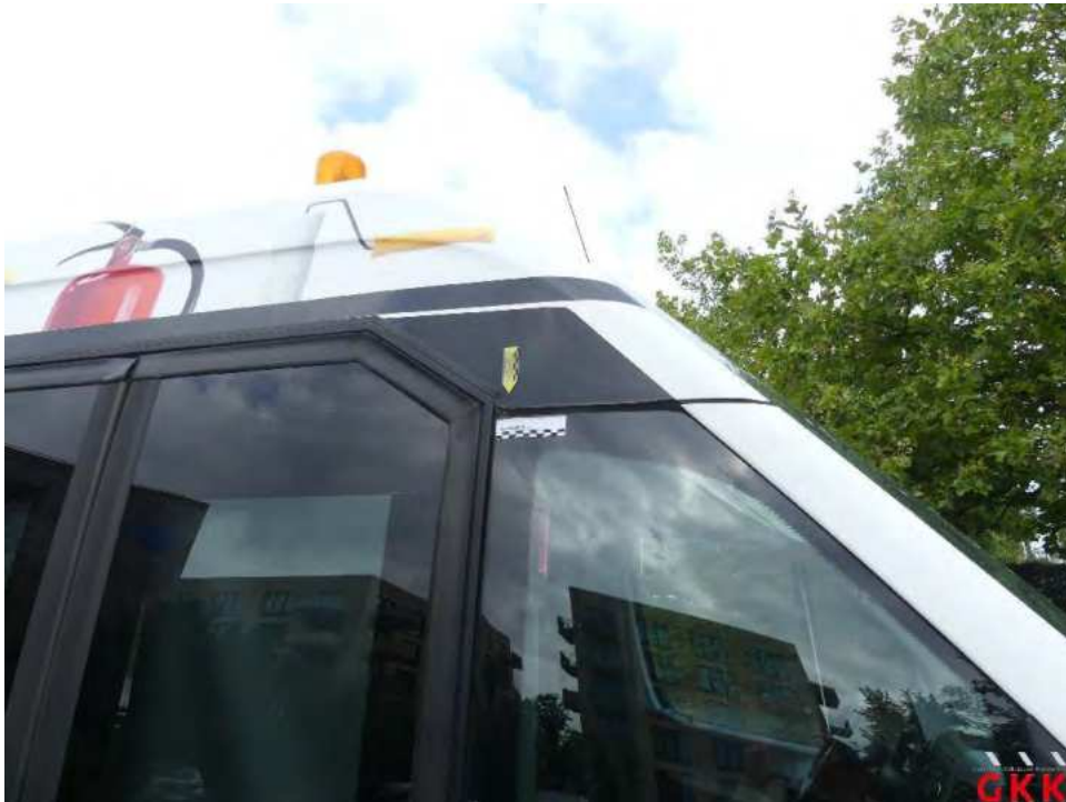
Bild 25 Dach, Holm rechts, beschädigt, instand setzen - lackieren
