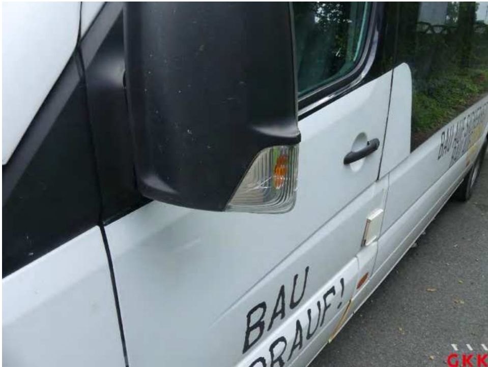
Bild 23 Spiegelgehäuse links, Blinker, beschädigt, ersetzen
