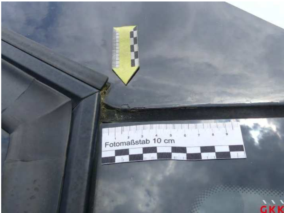
Bild 26 Dach, Holm rechts, beschädigt, instand setzen - lackieren
