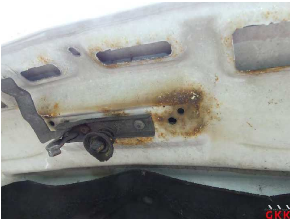
Bild 56 Motorhaube, korrodiert, instand setzen - lackieren
