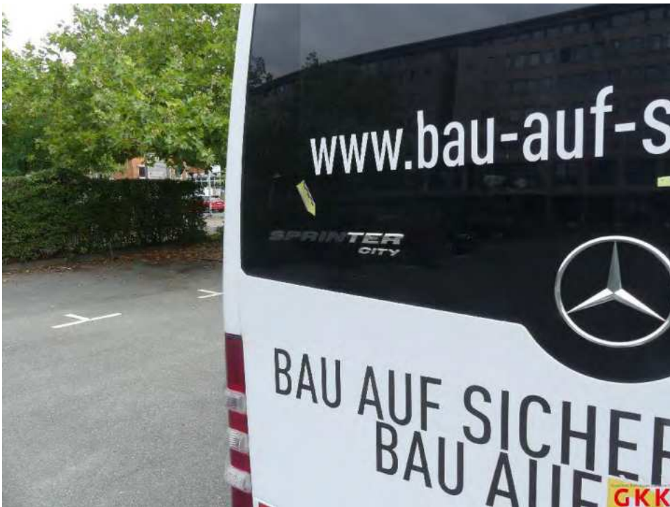
Bild 34 Schriftzug Sprinter, beschädigt, ersetzen
