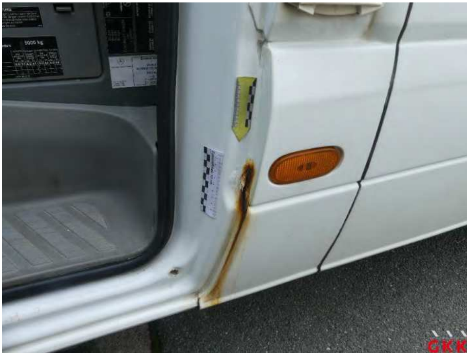
Bild 40 B- Säule links, beschädigt, instand setzen - lackieren
