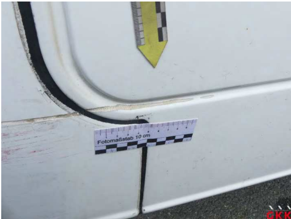
Bild 28 Seitenwand rechts, beschädigt, instand setzen - lackieren
