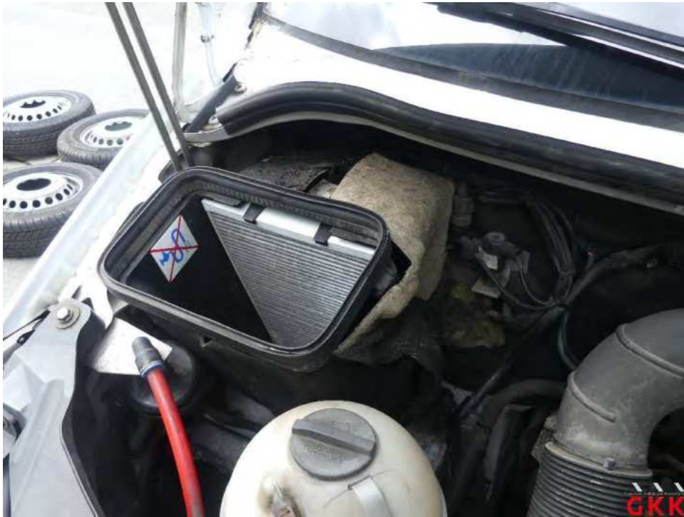
Bild 19 Motorraum, Dämmmatte, beschädigt, ersetzen
