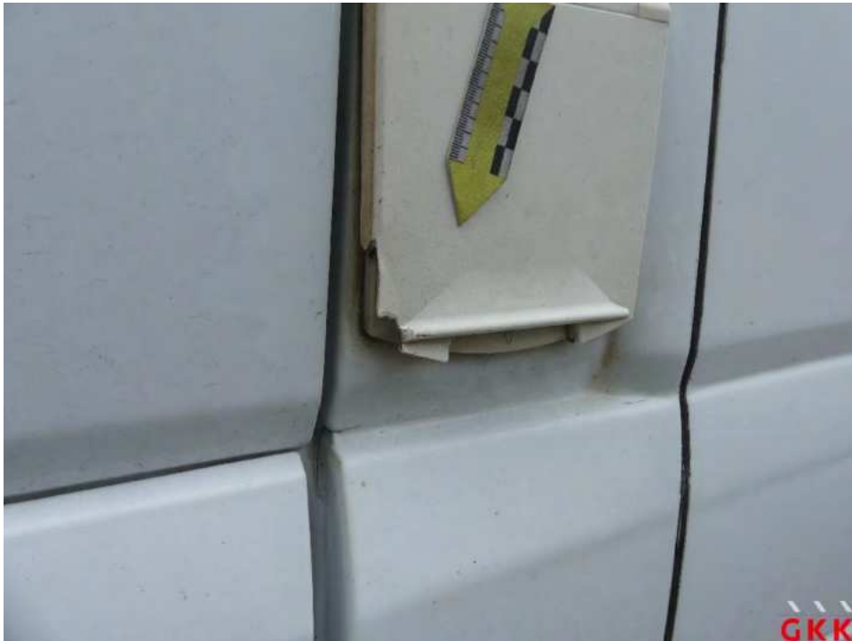
Bild 39 Steckdose vorne links, beschädigt, ersetzen
