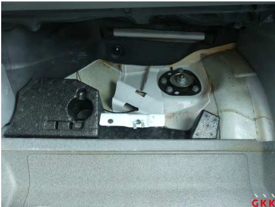
Bild 50 Werkzeug, komplett, fehlt, ersetzen
