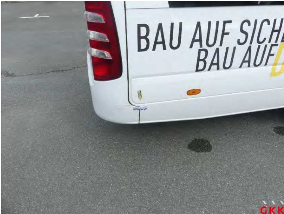
Bild 27 Seitenwand rechts, beschädigt, instand setzen - lackieren
