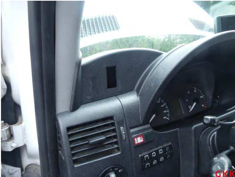
Bild 45 Armaturenbrett, Blende, fehlt, ersetzen
