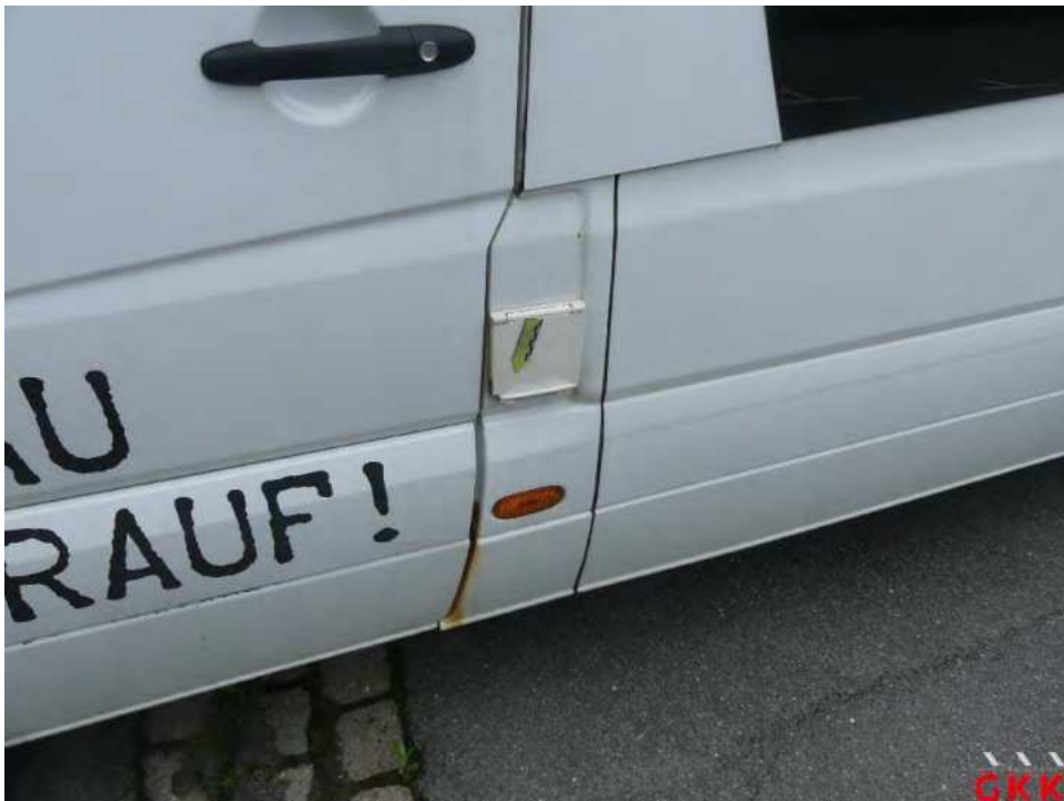
Bild 38 Steckdose vorne links, beschädigt, ersetzen
