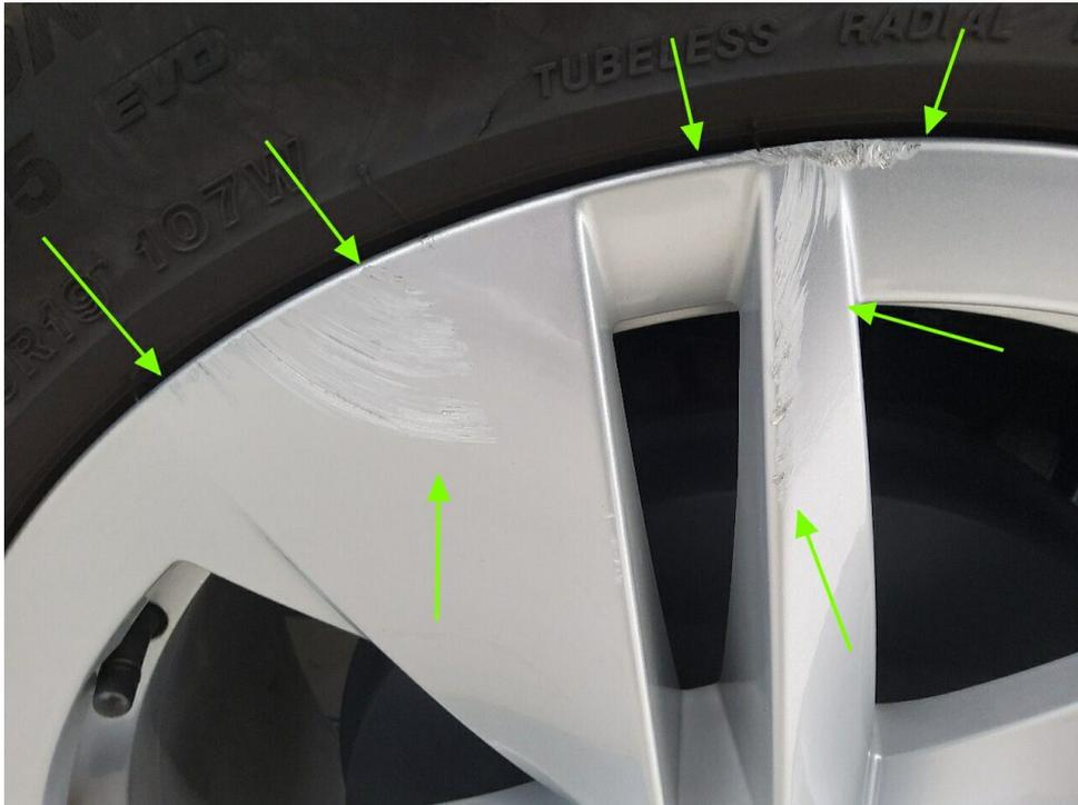
Bild 11 : Felge hinten links, zerkratzt
