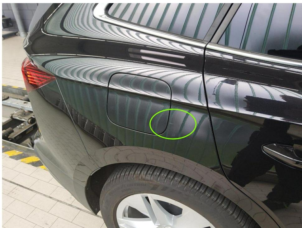
Bild 8 : Seitenteil hinten rechts Lackierung, verschrammt, polieren
