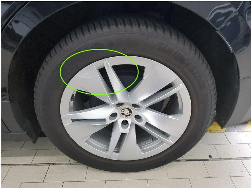
Bild 10 : Felge hinten links, zerkratzt
