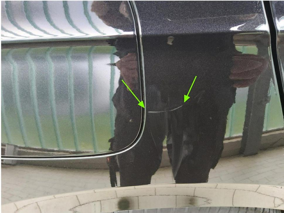
Bild 9 : Seitenteil hinten rechts Lackierung, verschrammt, polieren
