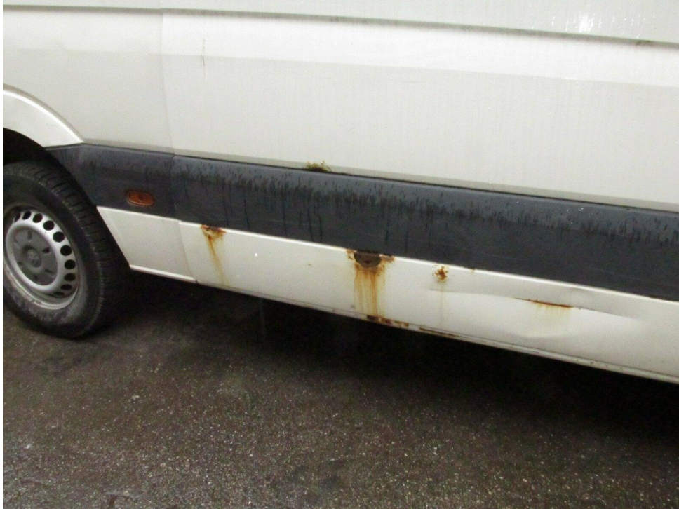
Bild 5 : Schiebetüre rechts durchgerostet, Verriegelung defekt
