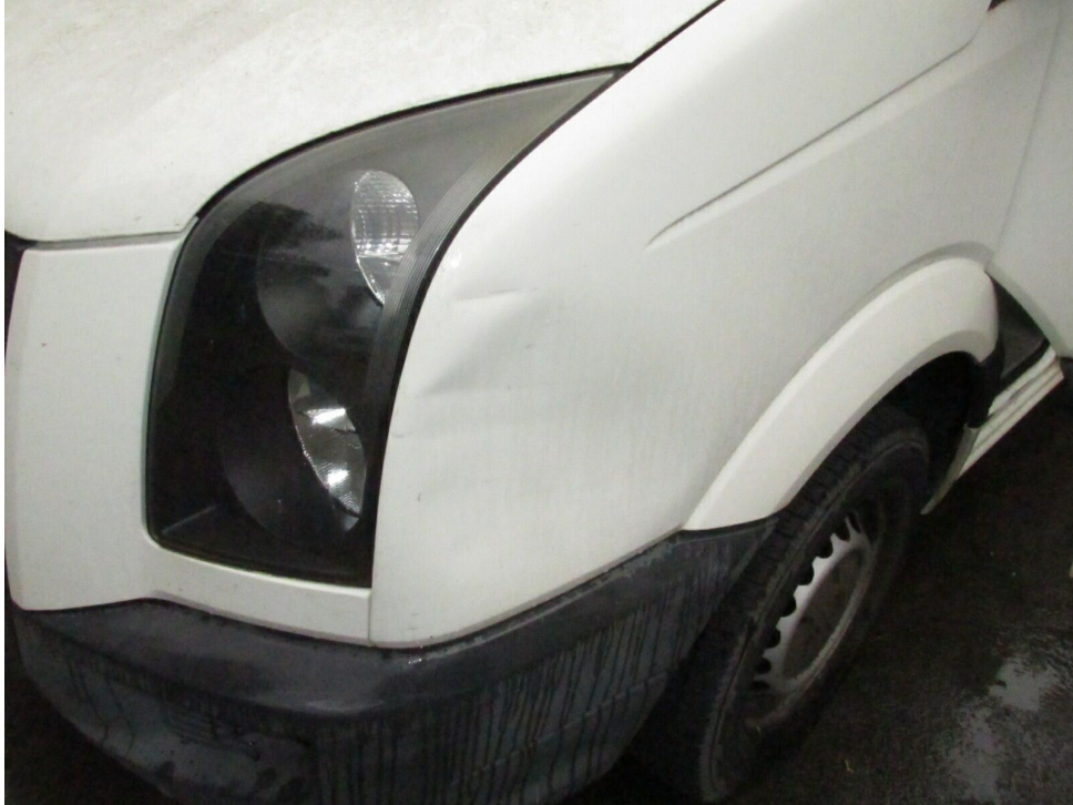
Bild 9 : Kotflügel vorne links eingedellt
