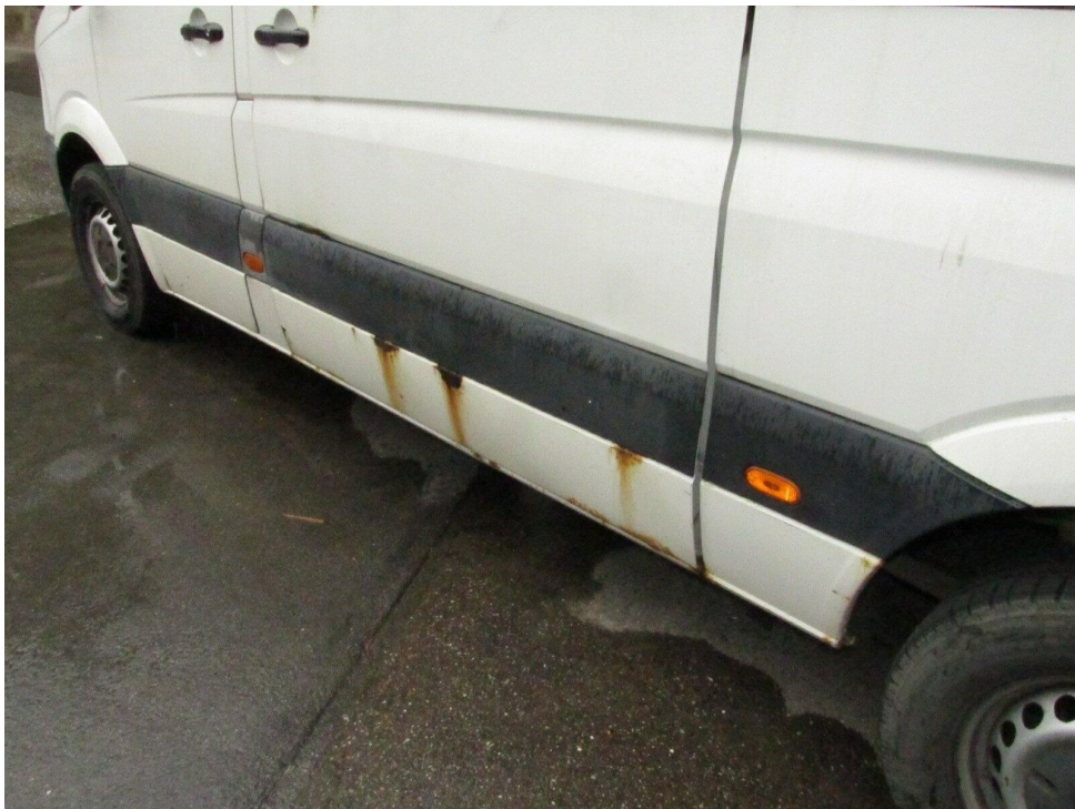
Bild 6 : Schiebetüre links stark korrodiert
