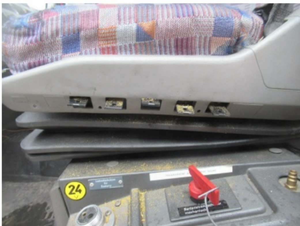
Bild 27 : Bedienkonsole Sitz vorne links beschädigt
