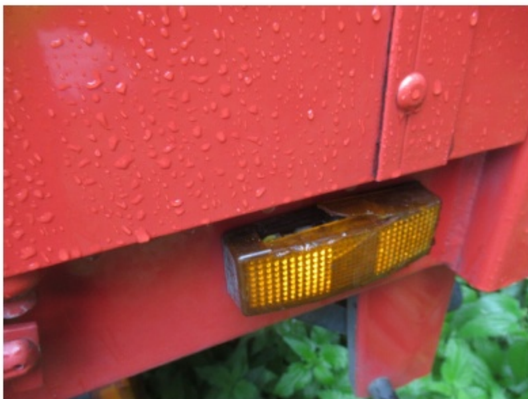
Bild 29 : Begrenzungsleuchte hinten links gebrochen
