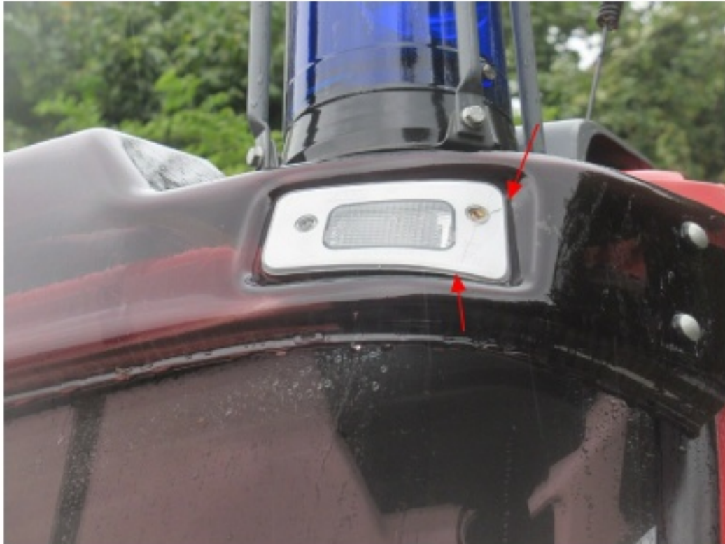
Bild 32 : Dachleuchte vorne links gebrochen
