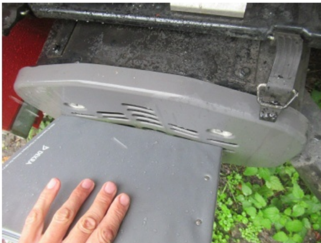
Bild 30 : Stauklappe rechts deformiert
