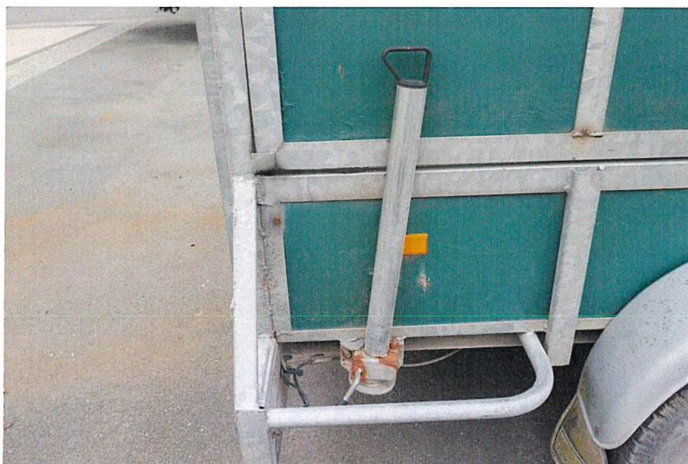
Stützrohr und Halterung hr verformt
