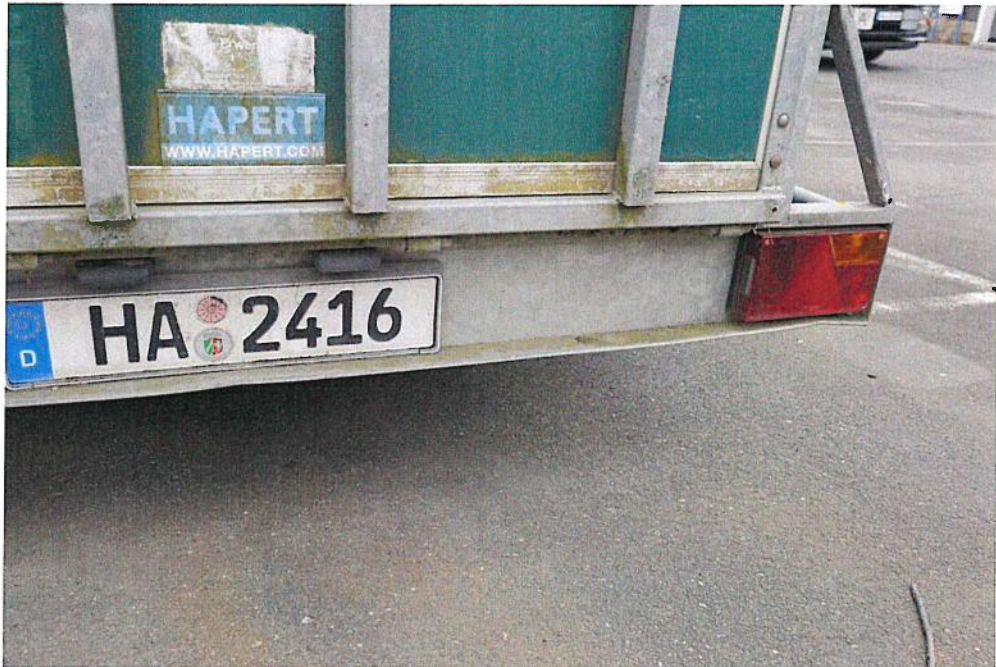
geringfügige Verformungen Abschlussquerträger
