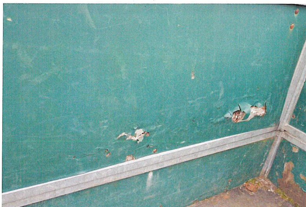
Bordwänderhöhlungen morsch (Löcher)
