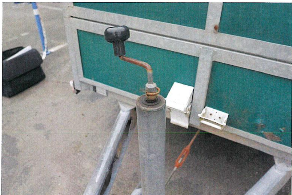
Splint Stützrad fehlt, 1 Unterlegkeil fehlt
