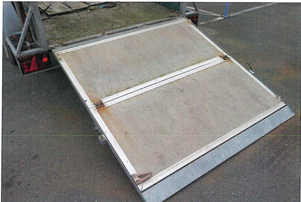
Ansicht Heckklappe/-rampe, Platten beschädigt
