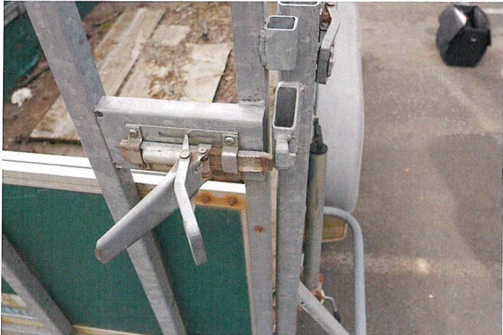
Verschluss Heckklappe mit leichtem Versatz, daher schwergängig
