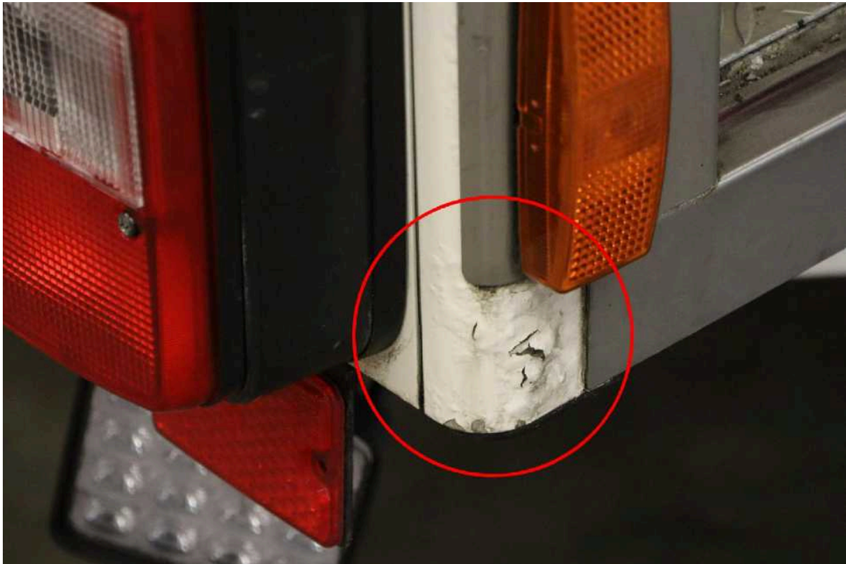
Bild 11: Rostansatz Aufbauecke hinten rechts
