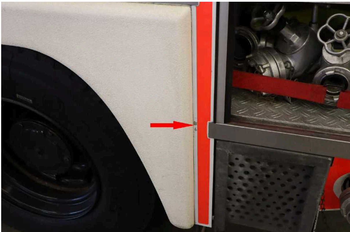
Bild 12: Lackierung an der Aufbausäule links hinter der Hinterachse abgestoßen mit Rostunterwanderung
