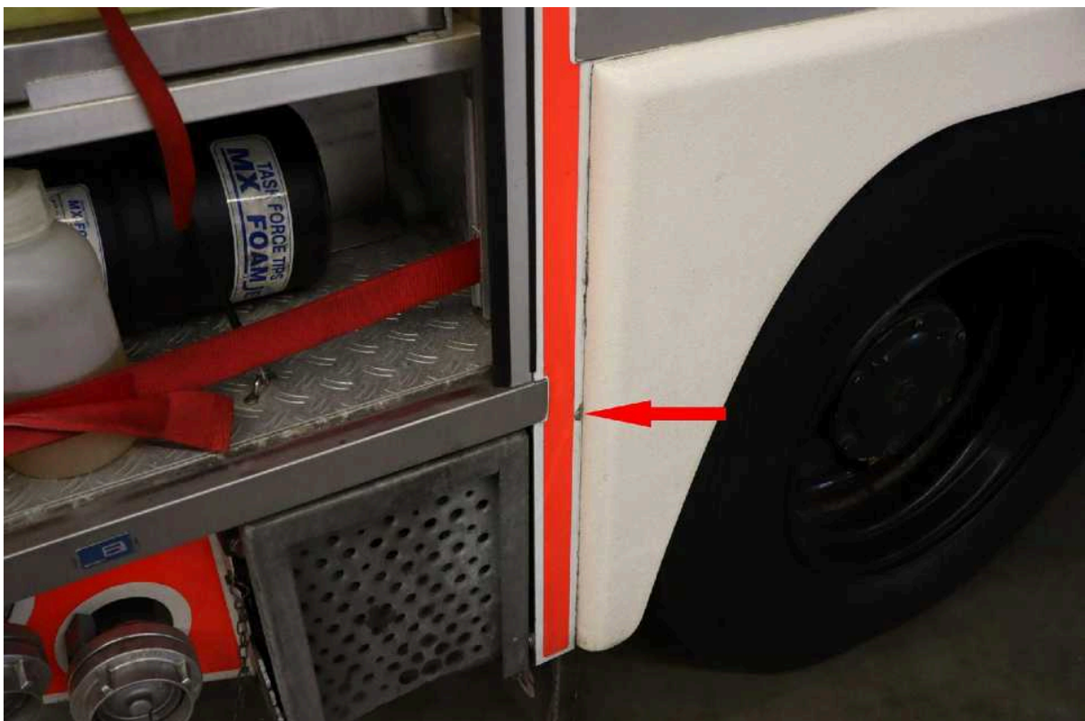
Bild 10: Lackierung an der Aufbausäule rechts hinter der Hinterachse abgestoßen mit Rostunterwanderung
