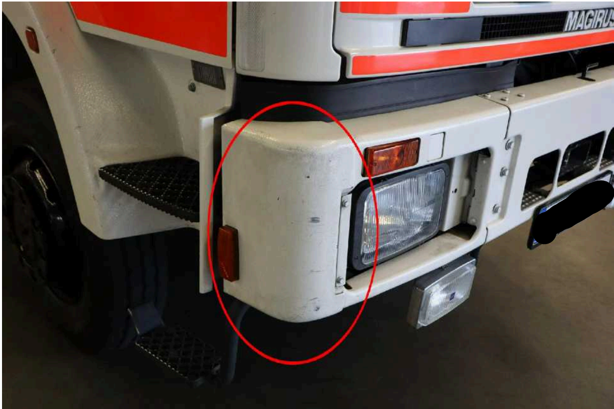
Bild 9: Stoßfängerabdeckung vorn rechts verschrammt
