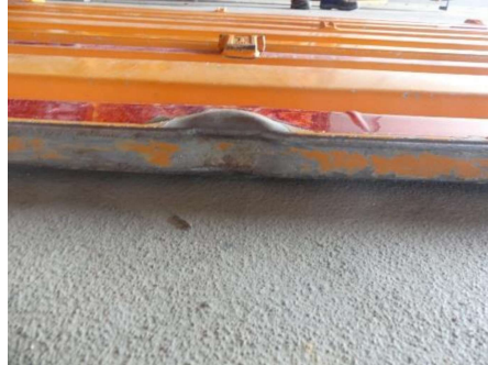
Ladebordwand hinten verformt
