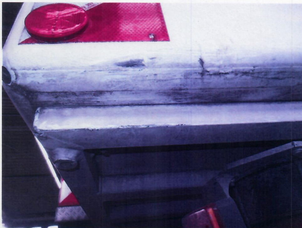
Bild 8 : Kasten gerissen bzw. gebrochen
