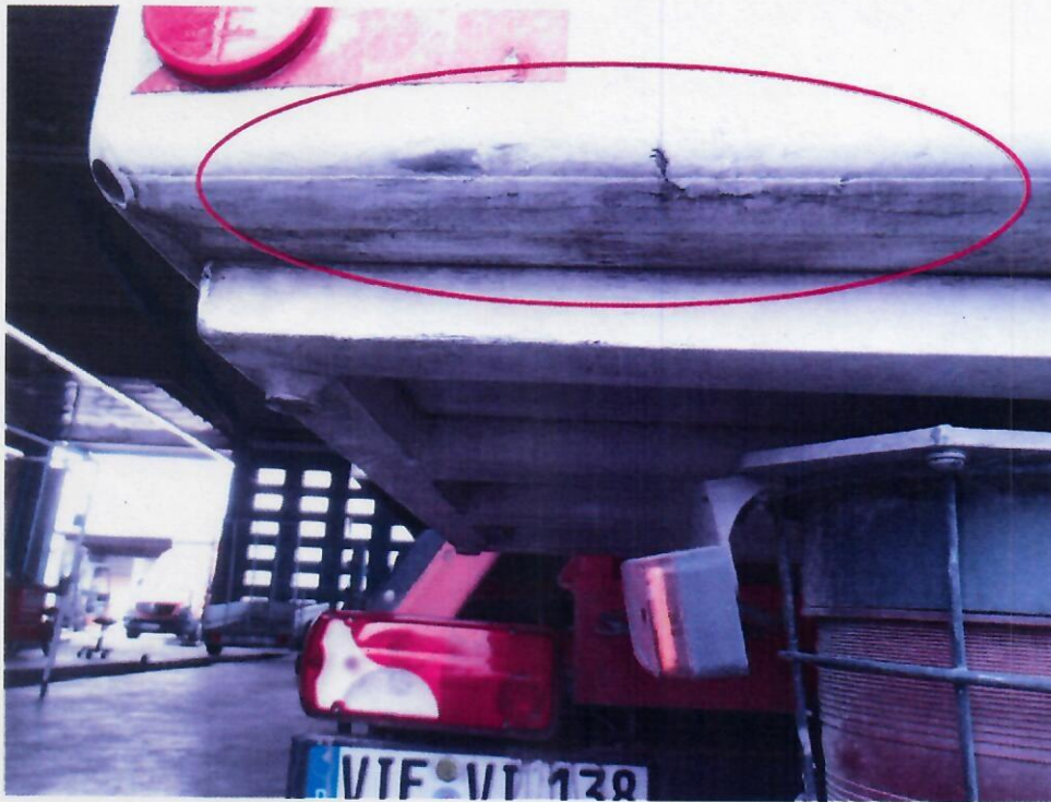
Bild 7 : Kasten gerissen bzw. gebrochen
