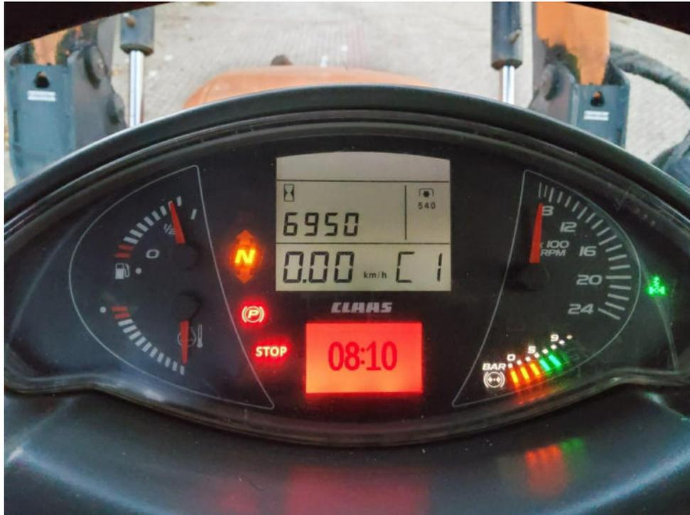
Bild 5 : Kombiinstrument
