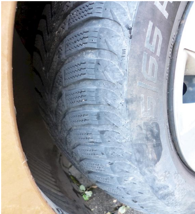
Bild 10, alle Winterreifen abgefahren
