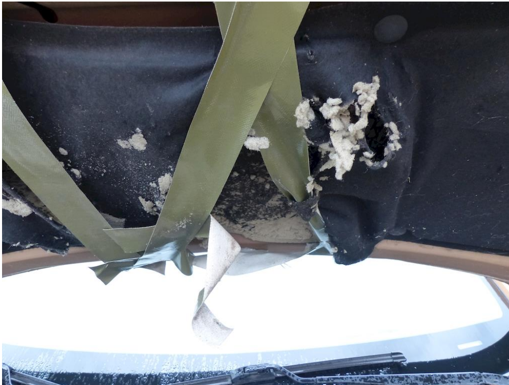
Bild 9, Dämmatte Motorhaube beschädigt
