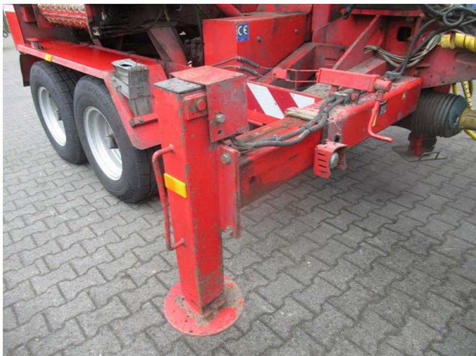
Bild 7 : hydraulische Abstützung
