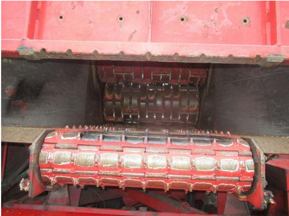
Bild 8 : Schnittguteinzugsband, max. Einzug 40 cm
