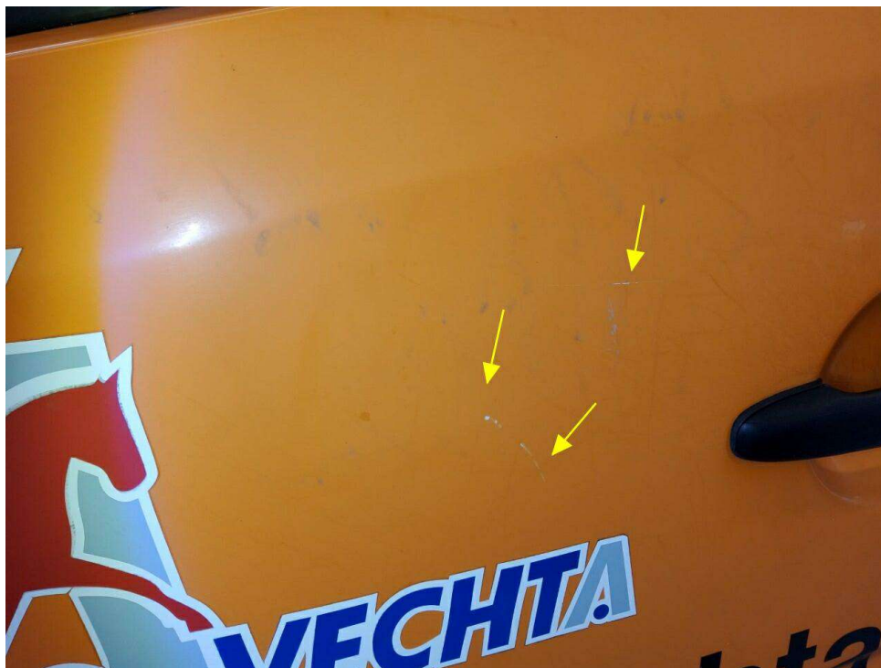
Bild 7 : Tür vorne links Lackierung, zerkratzt, lackieren mit Lackaufbau
