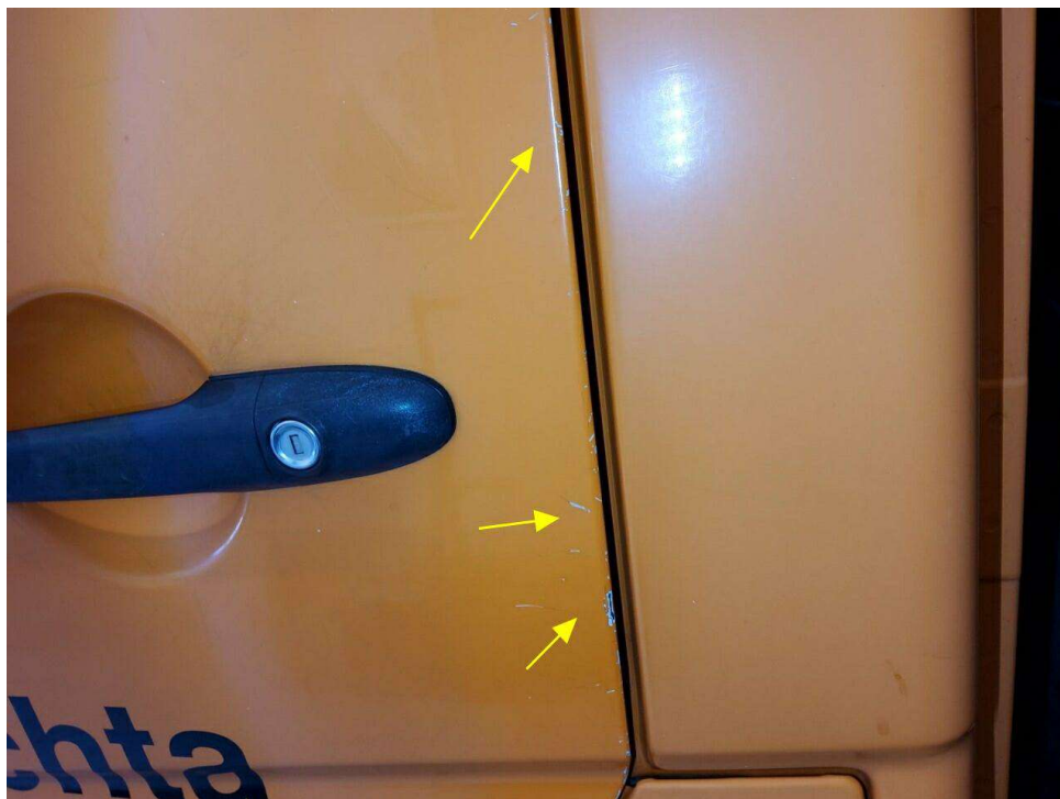
Bild 6 : Tür vorne links Lackierung, zerkratzt, lackieren mit Lackaufbau
