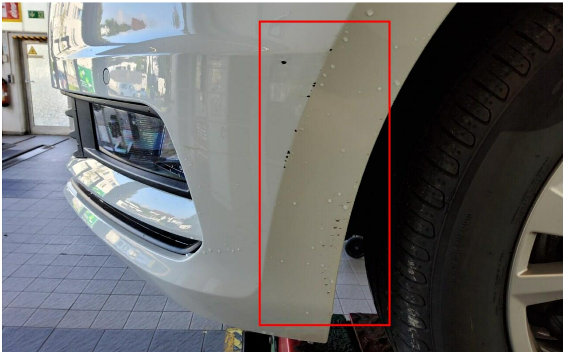
Bild 5 : Stoßfänger vorne Lackierung, verschrammt, smart repair
