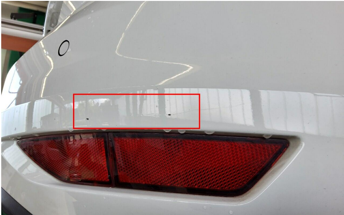
Bild 5 : Stoßfänger hinten rechts verschrammt, auslegen und polieren
