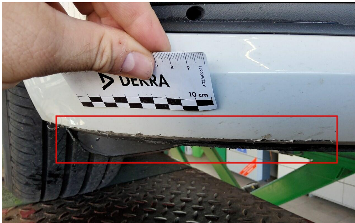
Bild 7 : Anfahrsschaden Stoßfänger vorne
