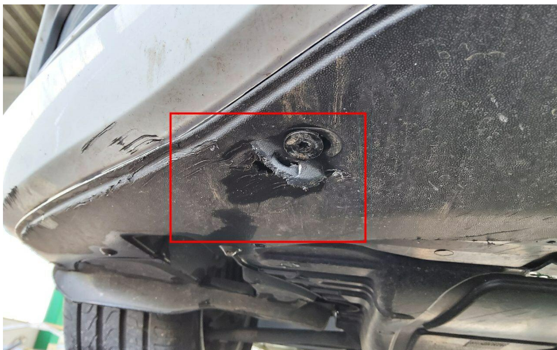
Bild 8 : Anfahrsschaden Stoßfänger vorne
