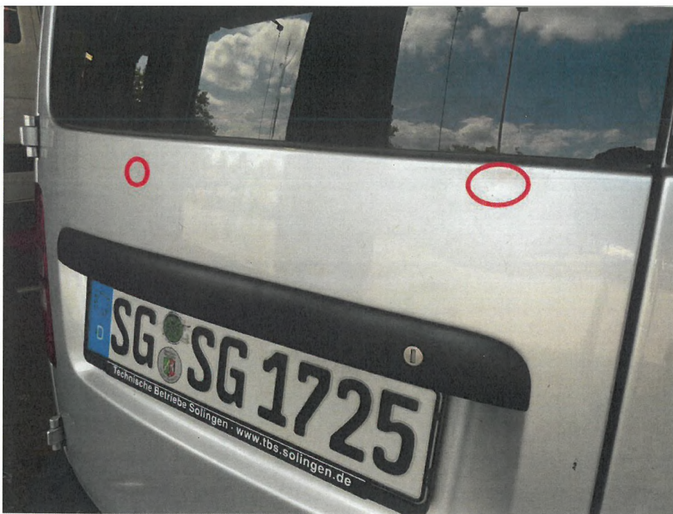
Foto 13: Laderaumtür hinten links mit 2 Dellen
