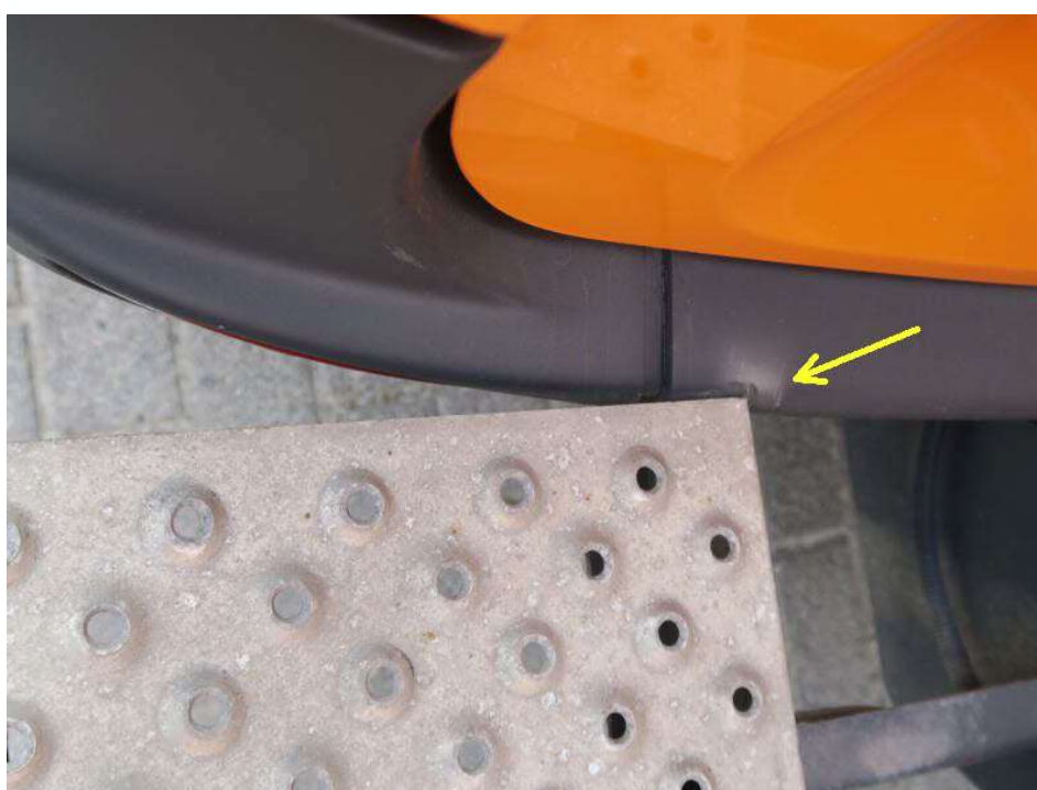
Bild 22 Beschädigung Stoßfänger hinten
