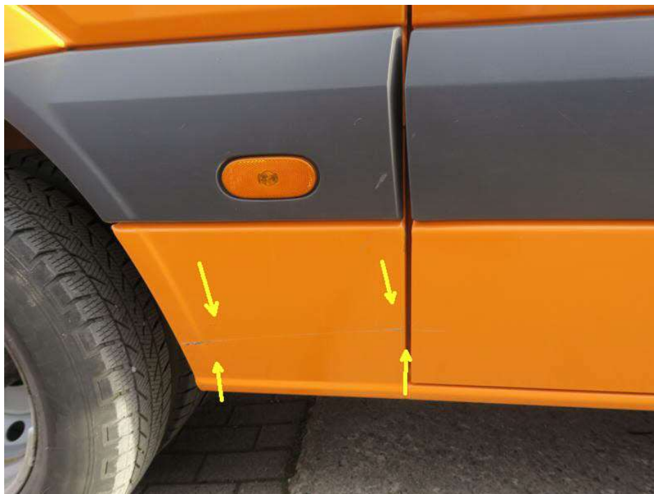
Bild 19 Lackbeschädigung Seitenwand hinten rechts
