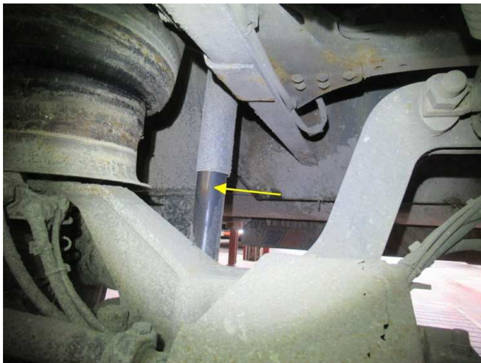
Bild 20 : Stoßdämpfer hinten undicht
