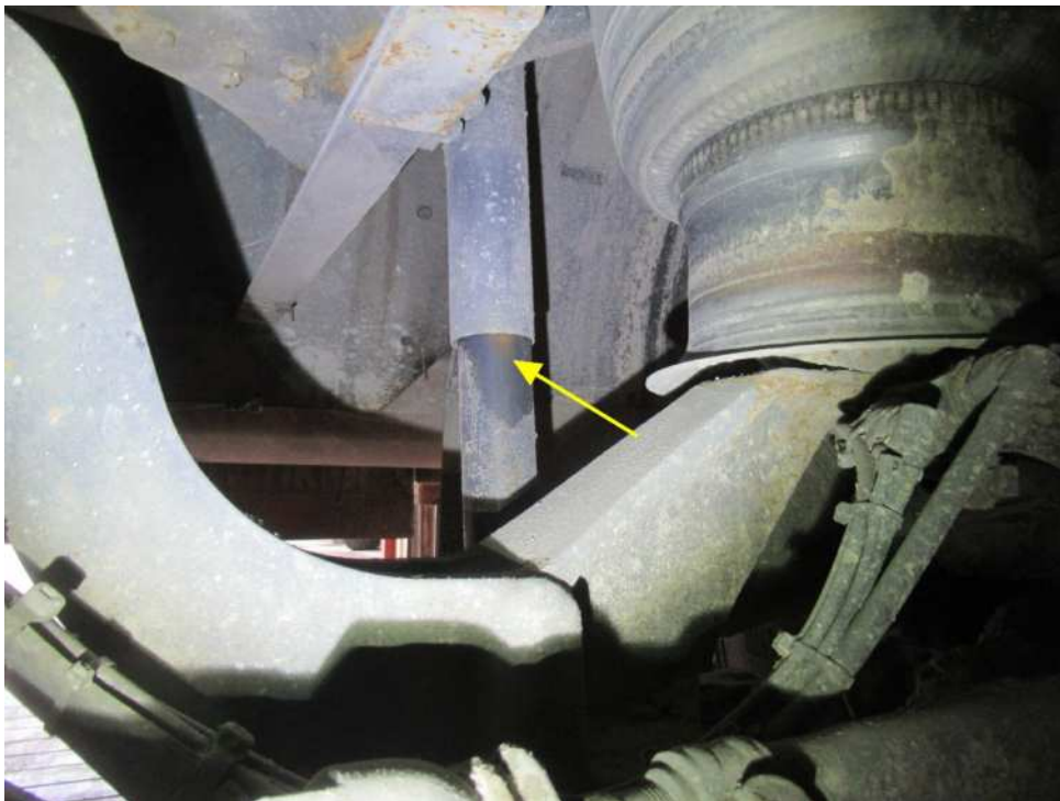
Bild 19 : Stoßdämpfer hinten undicht
