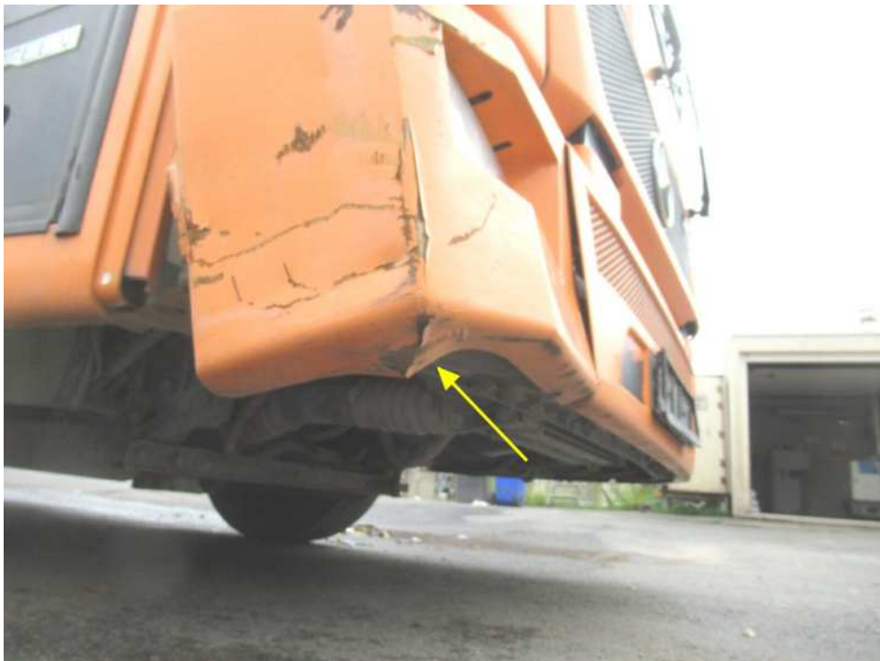
Bild 14 : Stoßfänger vorne rechts abgeknickt
