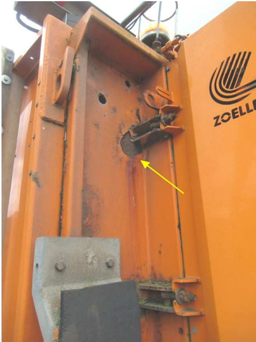
Bild 15 : diverse Rostunterwanderungen am gesamten Fahrzeug
