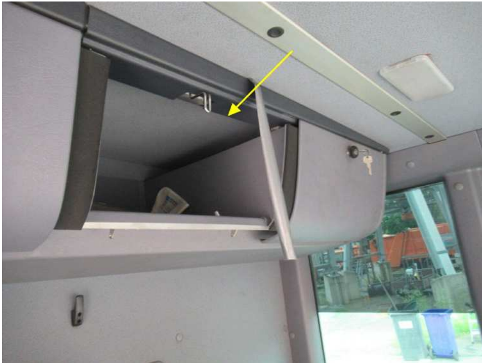
Bild 11 : Klappe Dachbox fehlt
