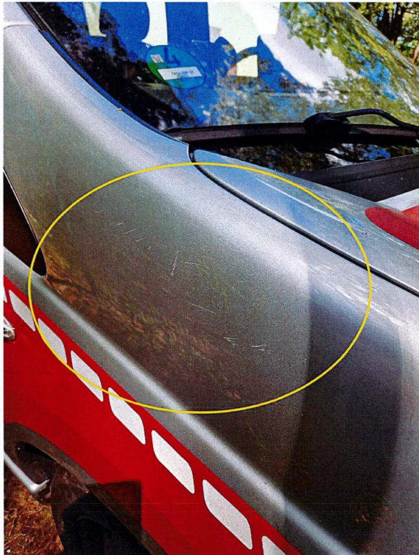
Bild 7 : Kotflügel VR verschrammt
