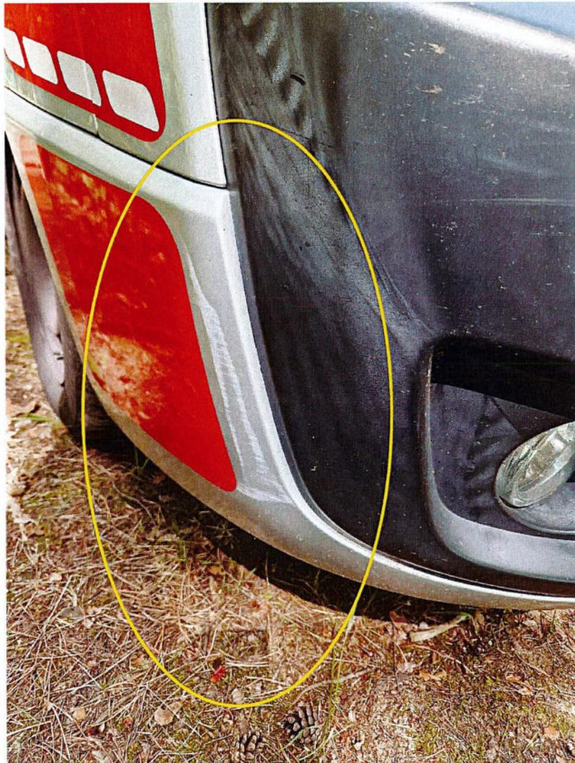
Bild 6 : Stoßfänger VR beschädigt
