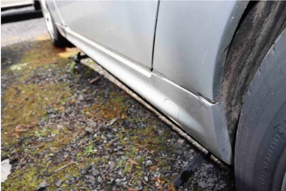
Bild 29 Lose Schwellerverkleidung links
