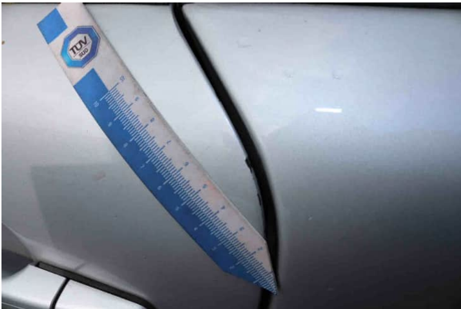
Bild 32 Lackschaden Tür links
