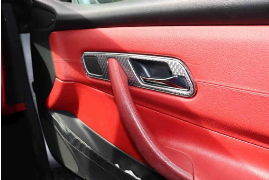
Bild 37 Abgenutzte Zuziehilfe rechts
