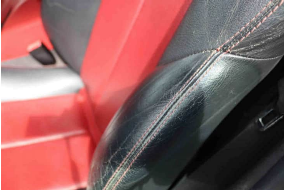
Bild 41 Beschädigter Sitzbezug links
