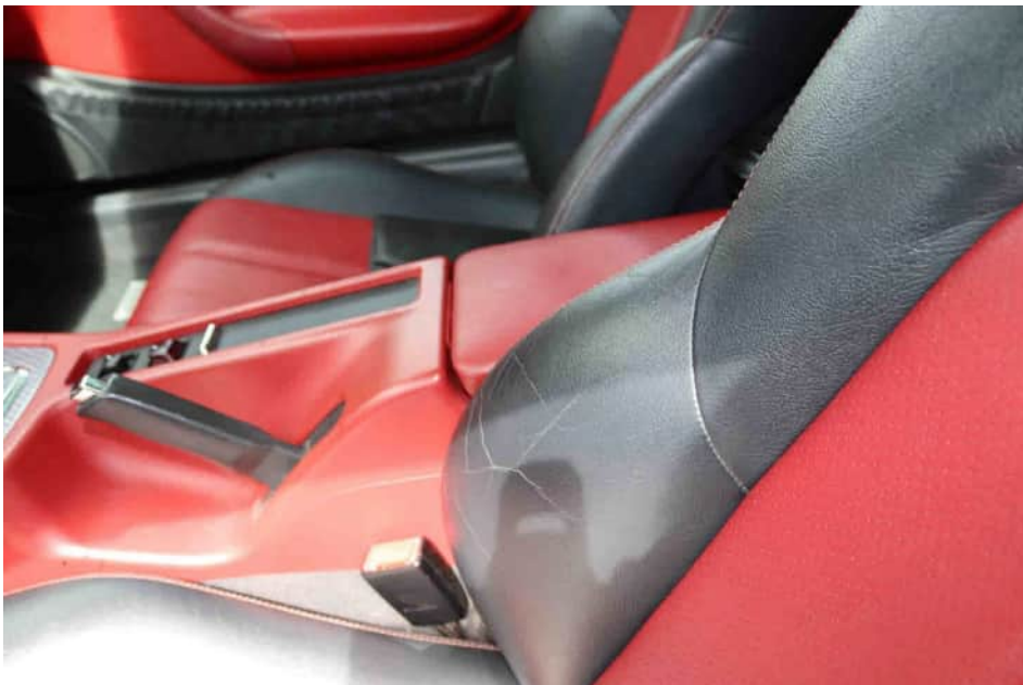
Bild 42 Beschädigter Sitzbezug links
