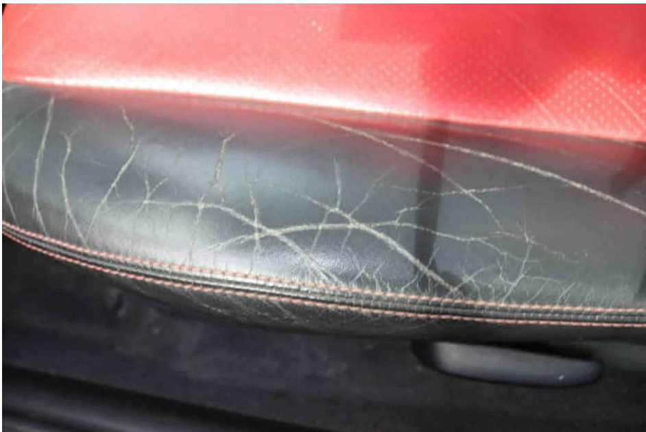
Bild 40 Beschädigter Sitzbezug links
