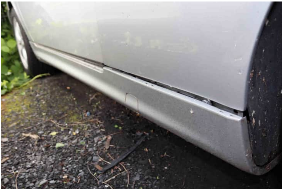
Bild 30 Lose Schwellerverkleidung links
