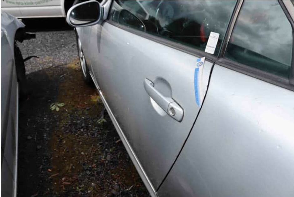
Bild 31 Lackschaden Tür links
