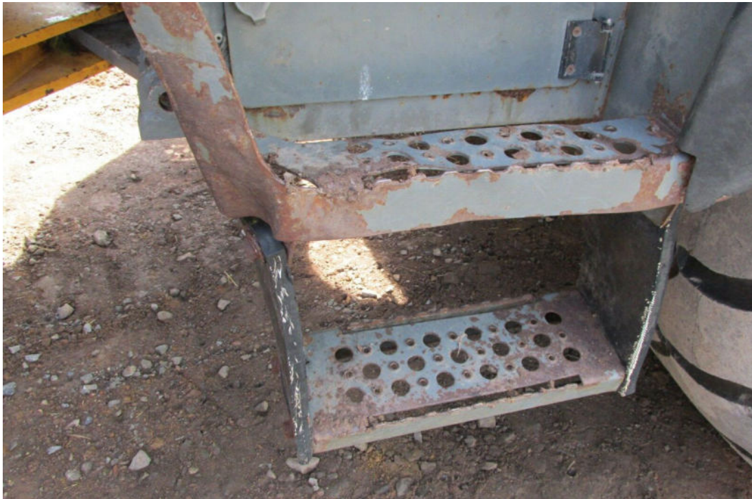
Bild 10 : Einstieg links deformiert
