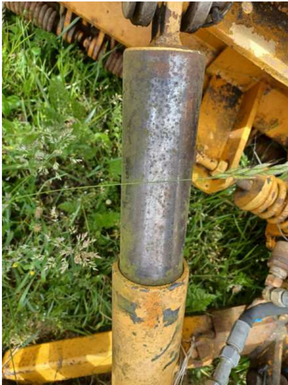
Bild: Arbeitszylinder beschädigt
