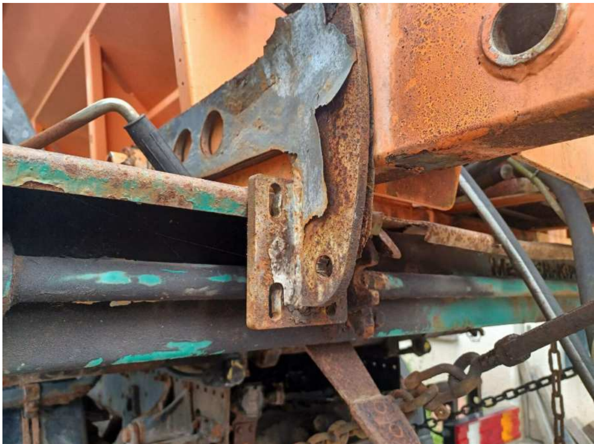
Bild: Meiler-Kipper verschlissen
