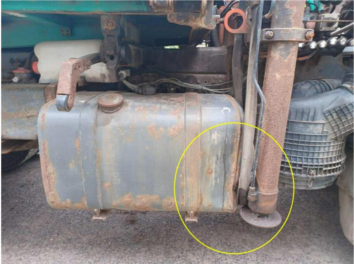
Bild: Anbauteile eingedrückt/beschädigt
