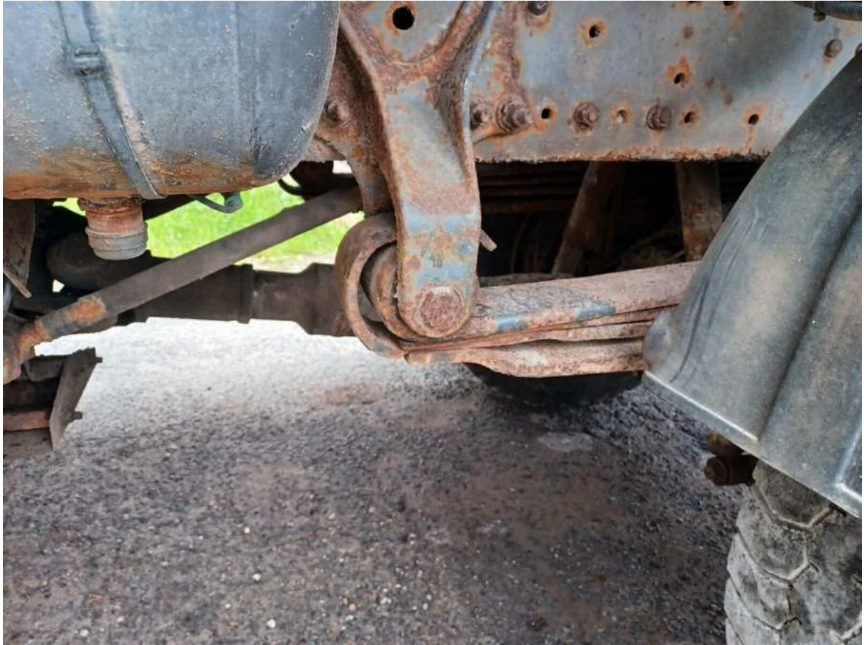
Bild: Rahmen starker Rostansatz
