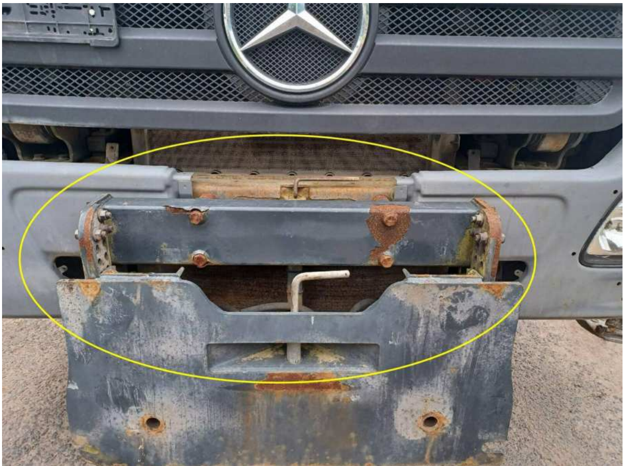
Bild: Anbauteile eingedrückt/beschädigt
