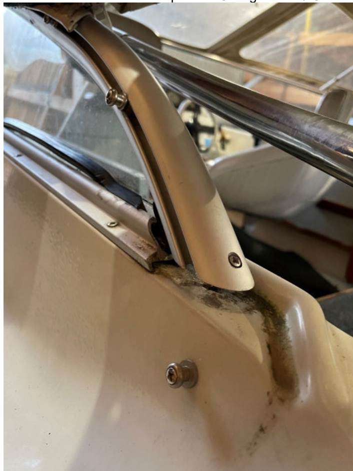
Ansicht Backbord – Umrandung Scheibe aus GFK gerissen/Dichtung verrutscht
