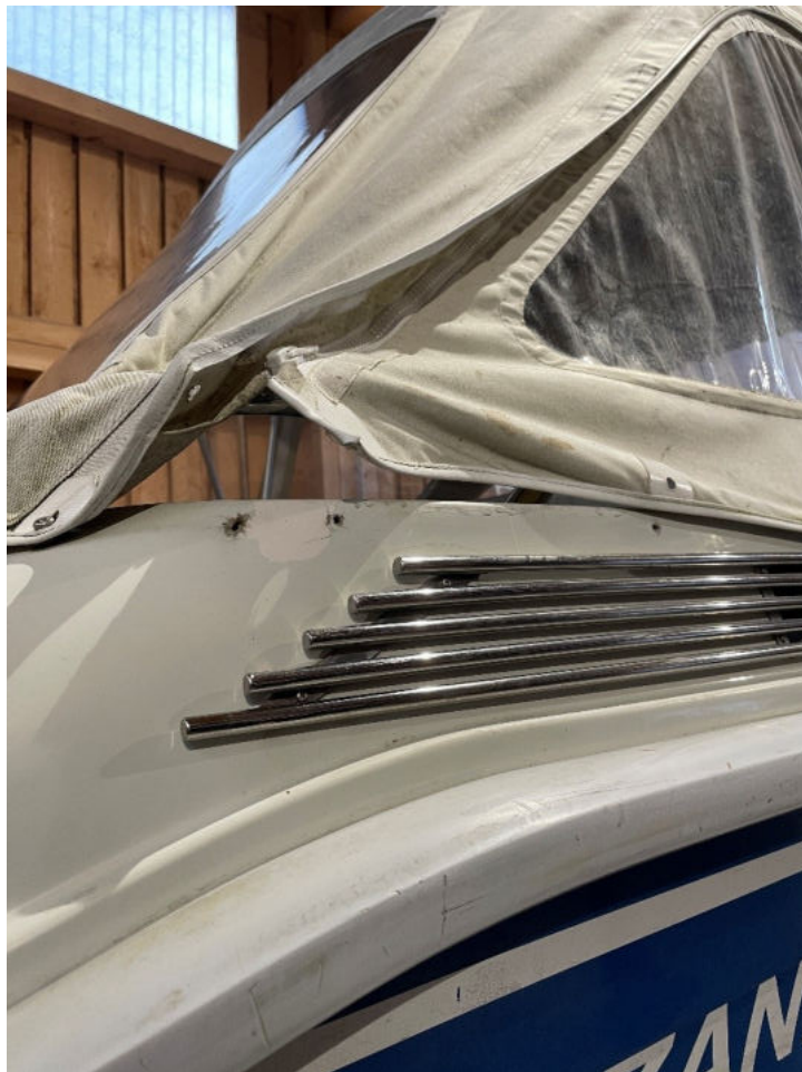
Ansicht Steuerbord – Druckknöpfe aus GFK gerissen / GFK rissig
