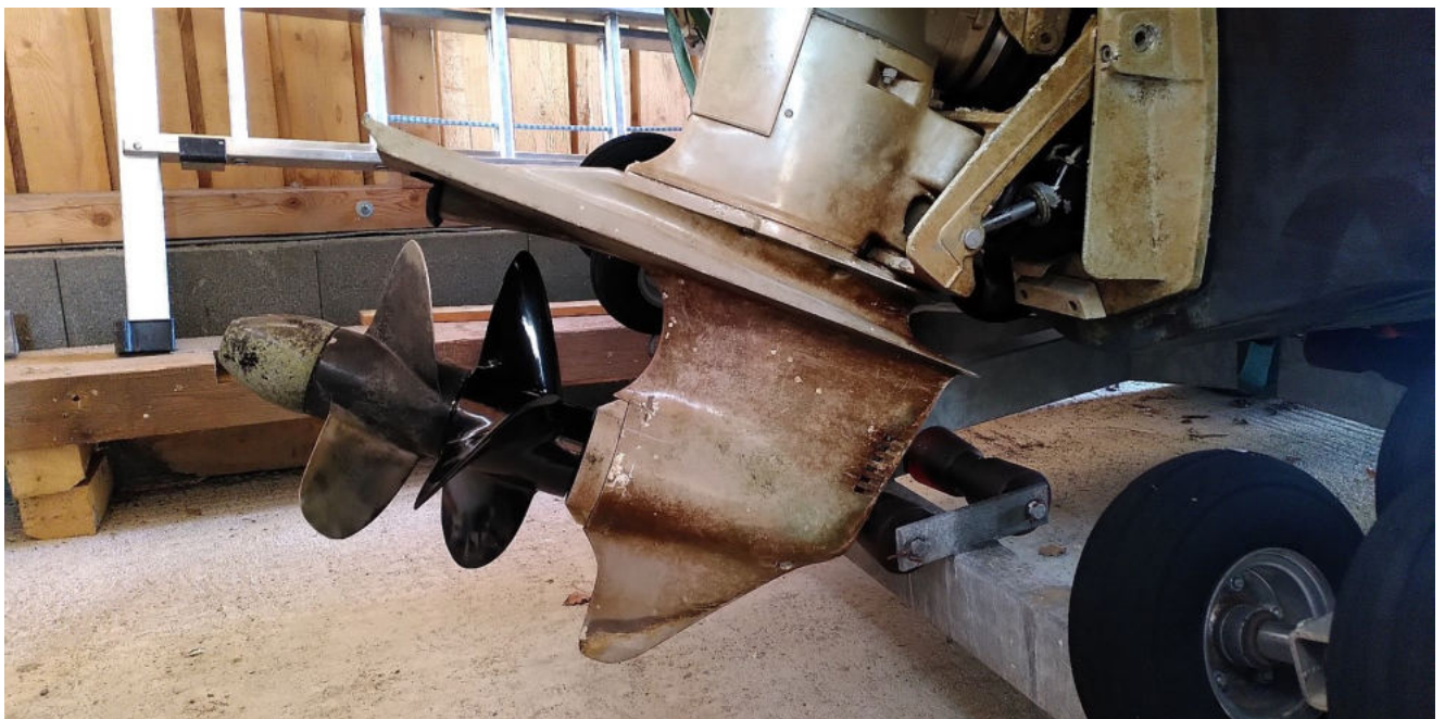
Ansicht Duo-Prop-Antrieb nach Wechsel Propeller
