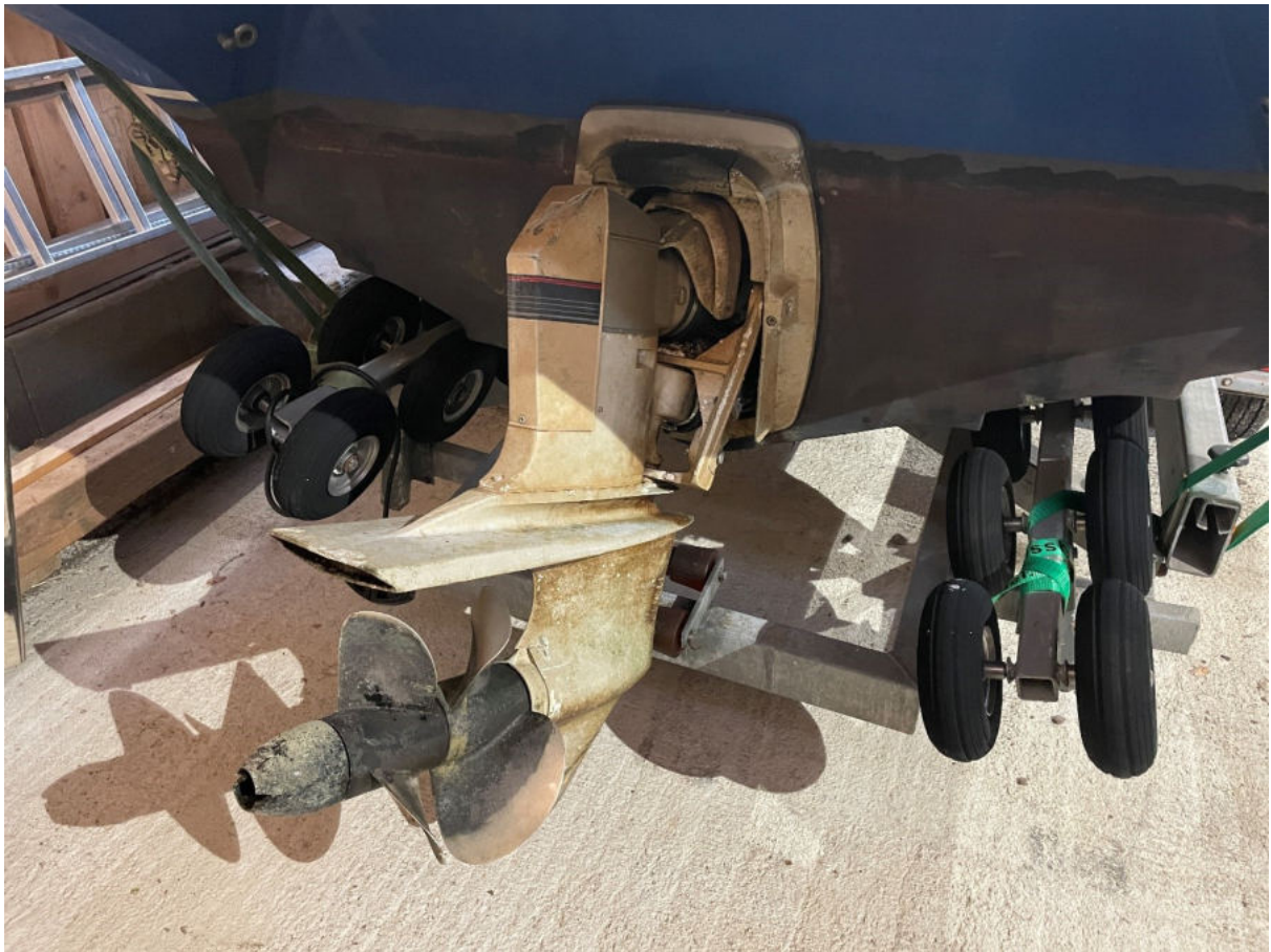
Ansicht Duo-Prop-Antrieb (Vor Wechsel des defekten Propellers)
