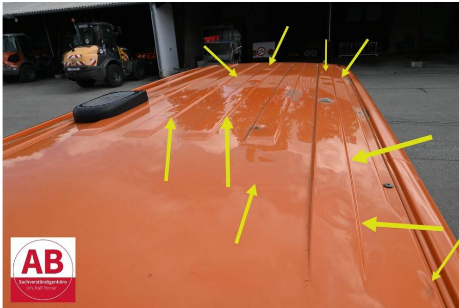
Das Dach ist mehrfach eingedrückt und großflächig verformt.
