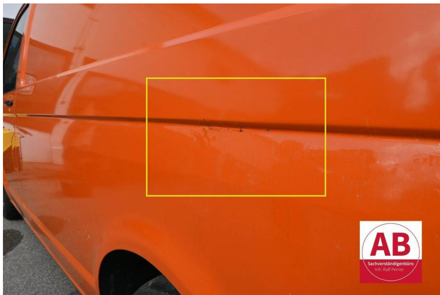
Instandgesetzte Seitenwand mit Rostbildung.
