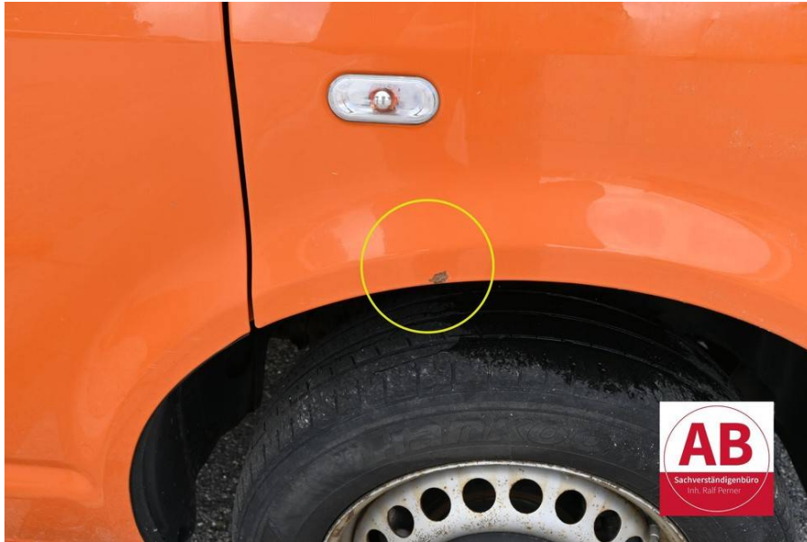
Lackschaden unterrostet am Kotflügel rechts.
