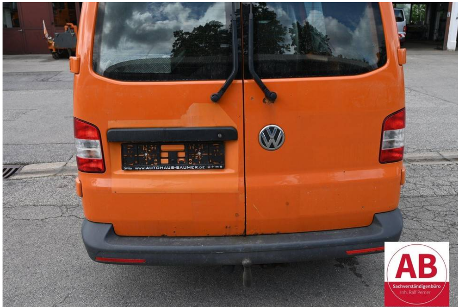
Lackausbesserung an der Tür links, beide Türen sind mehrfach unterrostet.
