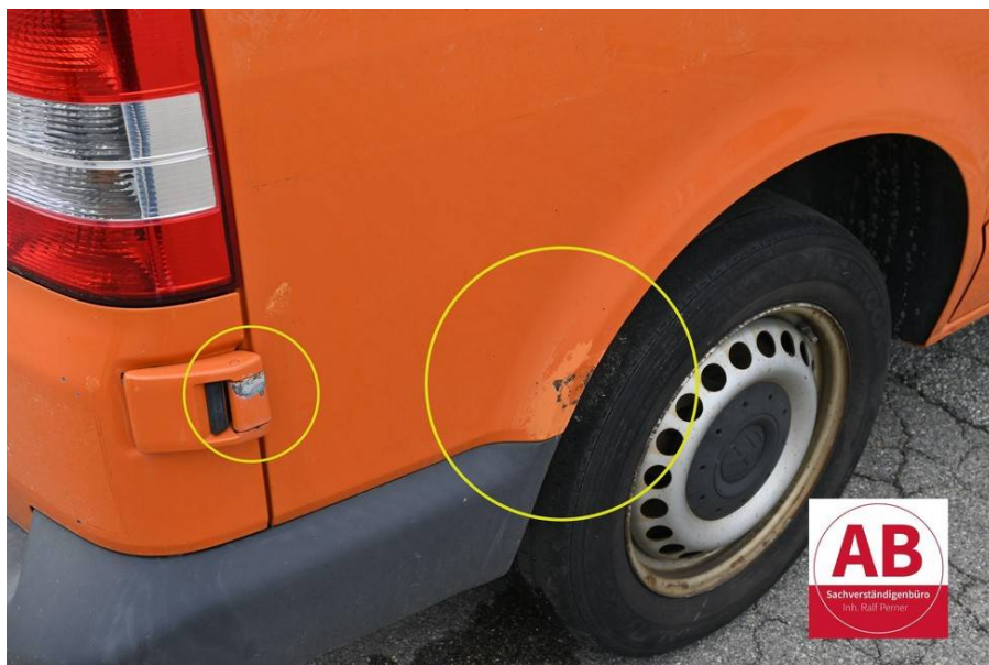
Scharnier Oxidiert, Lackierung Seitenwand unterrostet.
