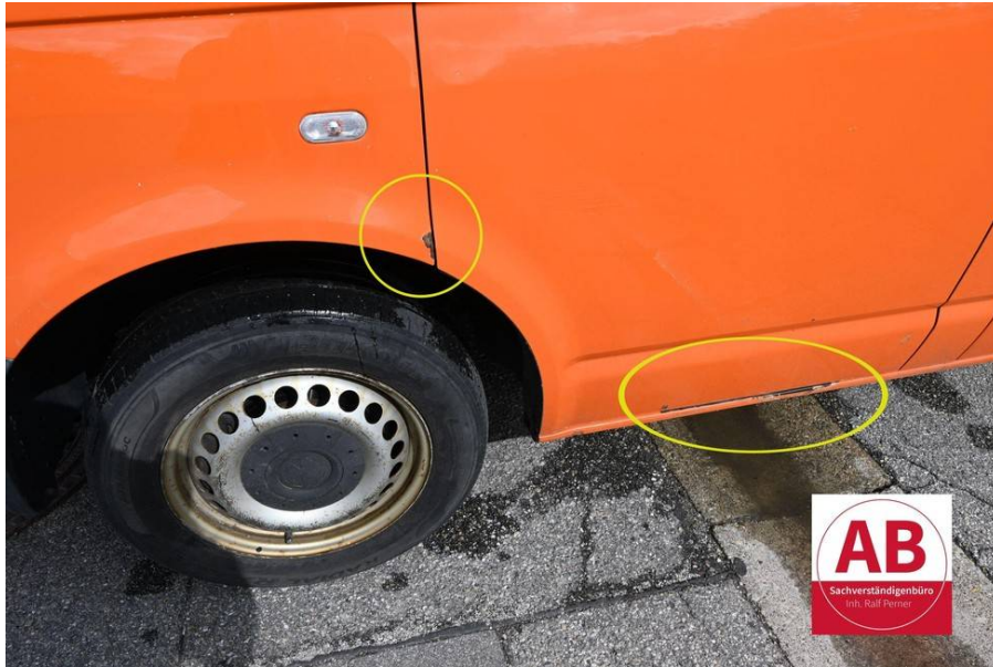
Lackschäden mit Rostbildung
