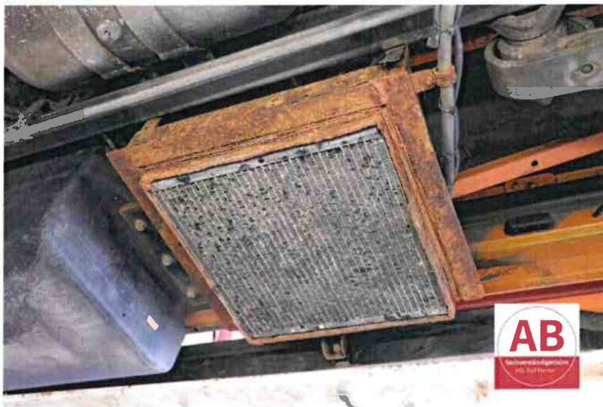
Klimakühler oxidiert Klimaanlage ohne Funktion.
