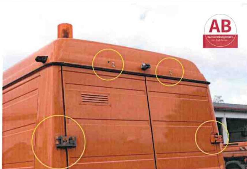
Scharniere oxidiert, Türen und D-Säule unterrostet, Löcher am Dach mit Schrauben verschlossen, Kabeldurchgang gebohrt.
