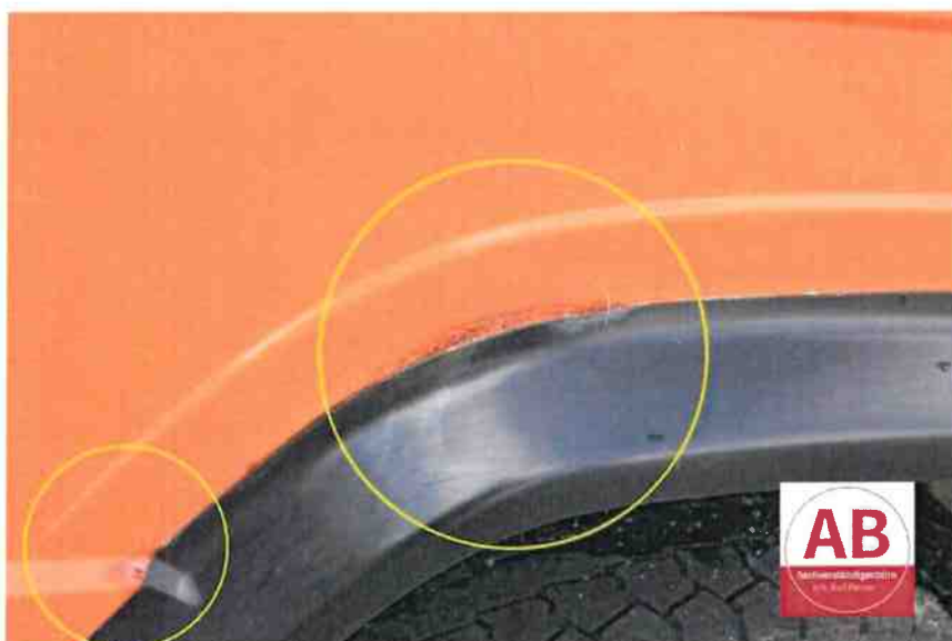
Rost an der Seitenwand links.
