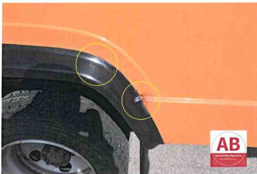
Rost an der Seitenwand rechts.
