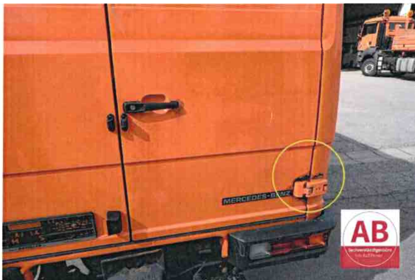
Scharniere oxidiert, Türen und D-Säule unterrostet, Löcher am Dach mit Schrauben verschlossen, Kabeldurchgang gebohrt.
