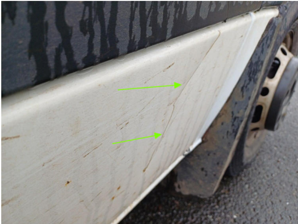
Bild 19 : Tür vorne rechts angerostet und verformt
