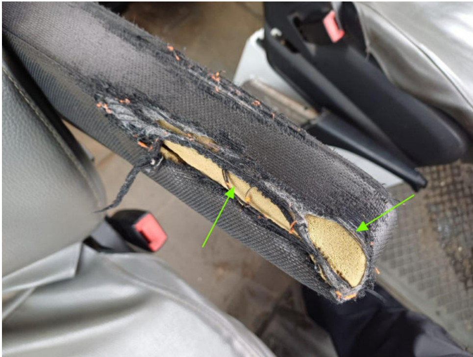
Bild 9 : Beifahrersitz, Arnlehne links gerissen
