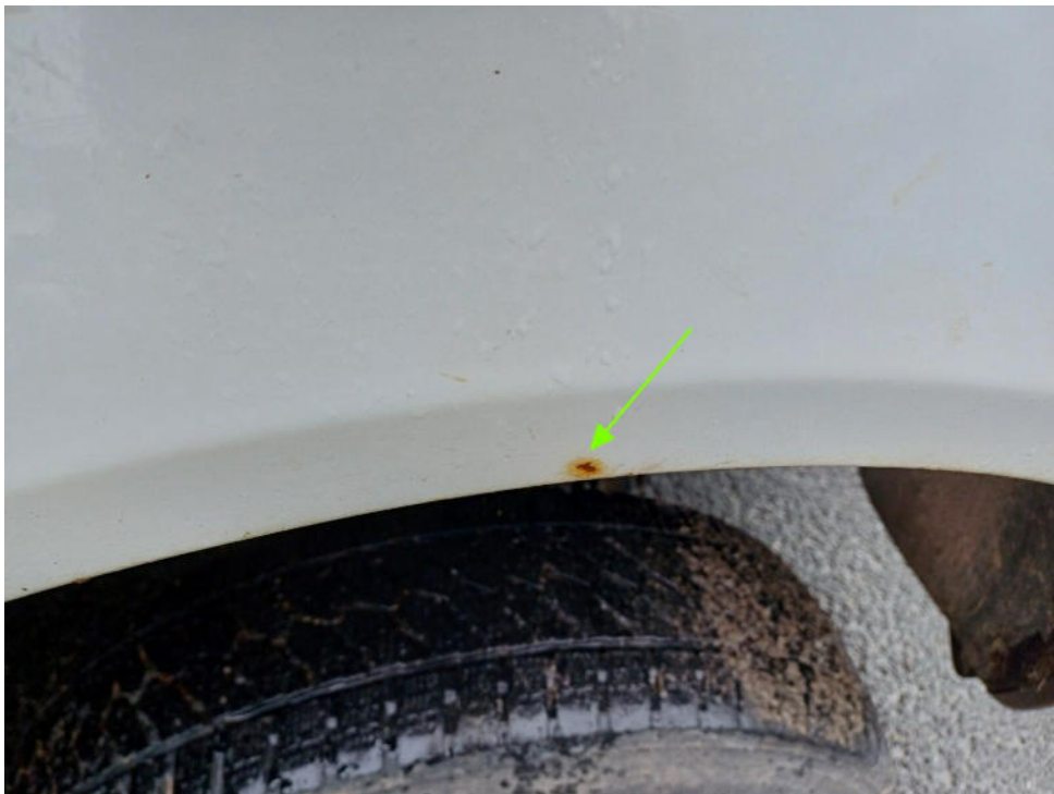
Bild 20 : Kotflügel vorne rechts angerostet
