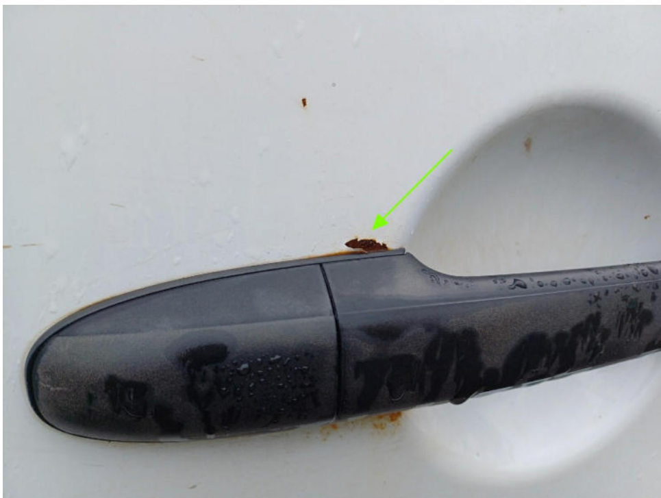
Bild 18 : Tür vorne rechts angerostet und verformt
