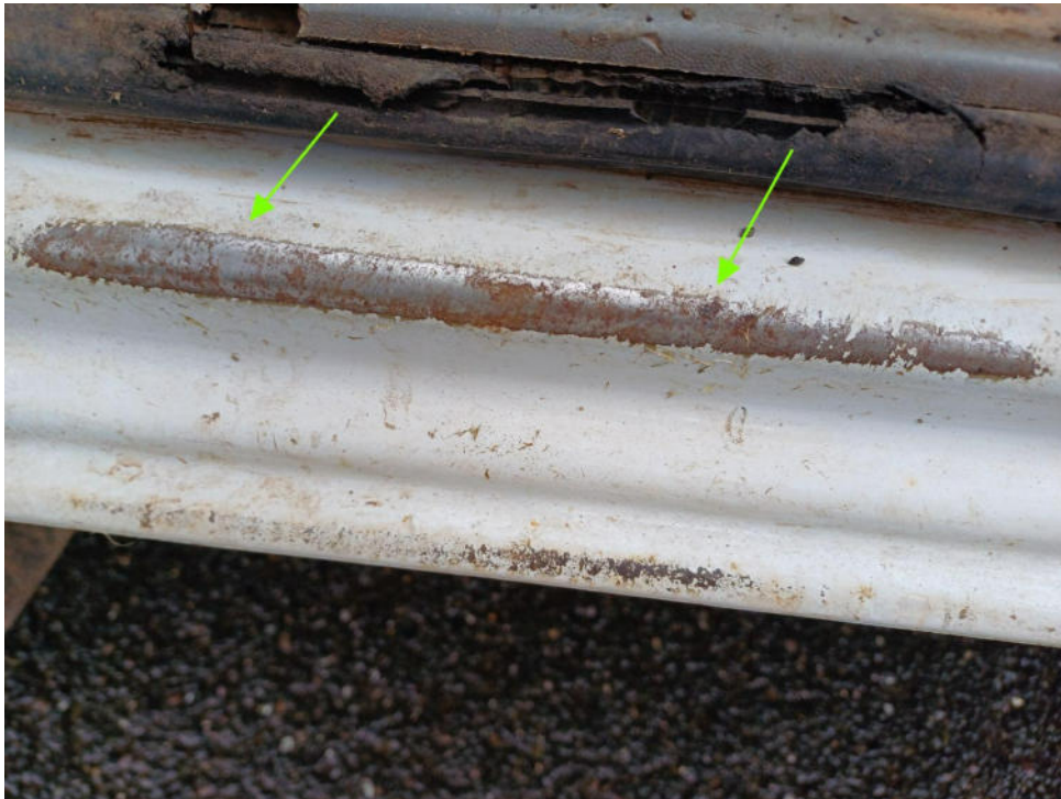
Bild 11 : Einstieg links zerkratzt
