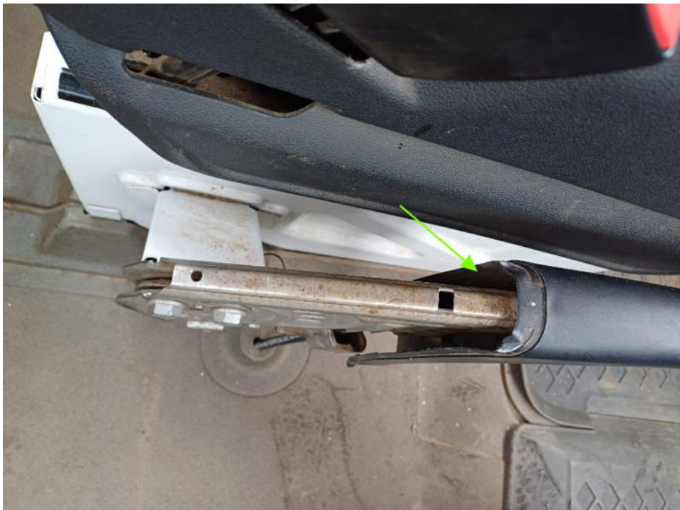
Bild 10 : Handbremshebel, Verkleidung gebrochen
