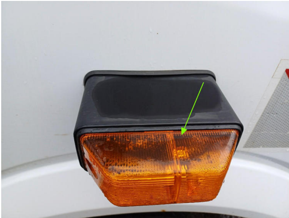
Bild 21 : Kotflügel, vorne rechts, Blinker Wassereintritt
