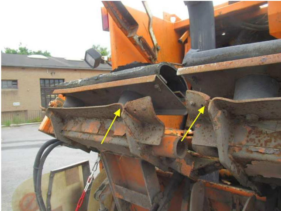
Bild 13 : Lifter an mehreren Stellen deformiert
