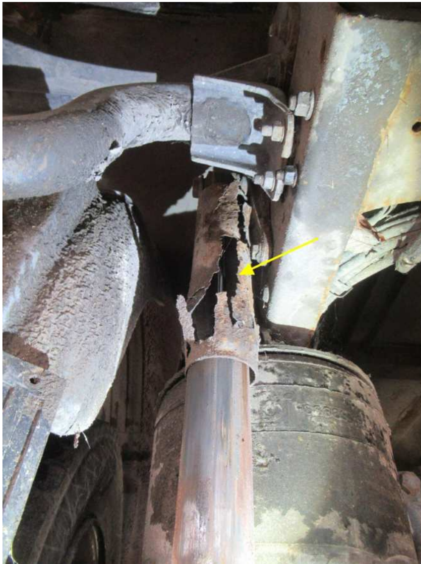
Bild 25 : Schutzkappen Stoßdämpfer hinten gebrochen
