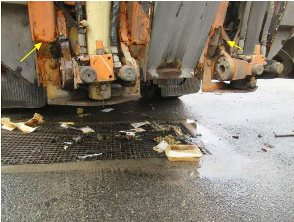
Bild 17 : diverse Rostunterwanderungen am gesamten Fahrzeug
