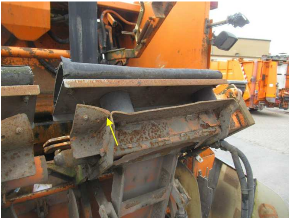
Bild 14 : Lifter an mehreren Stellen deformiert
