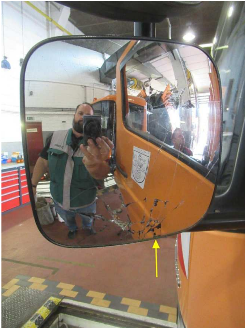
Bild 20 : Weitwinkelspiegel links gerissen
