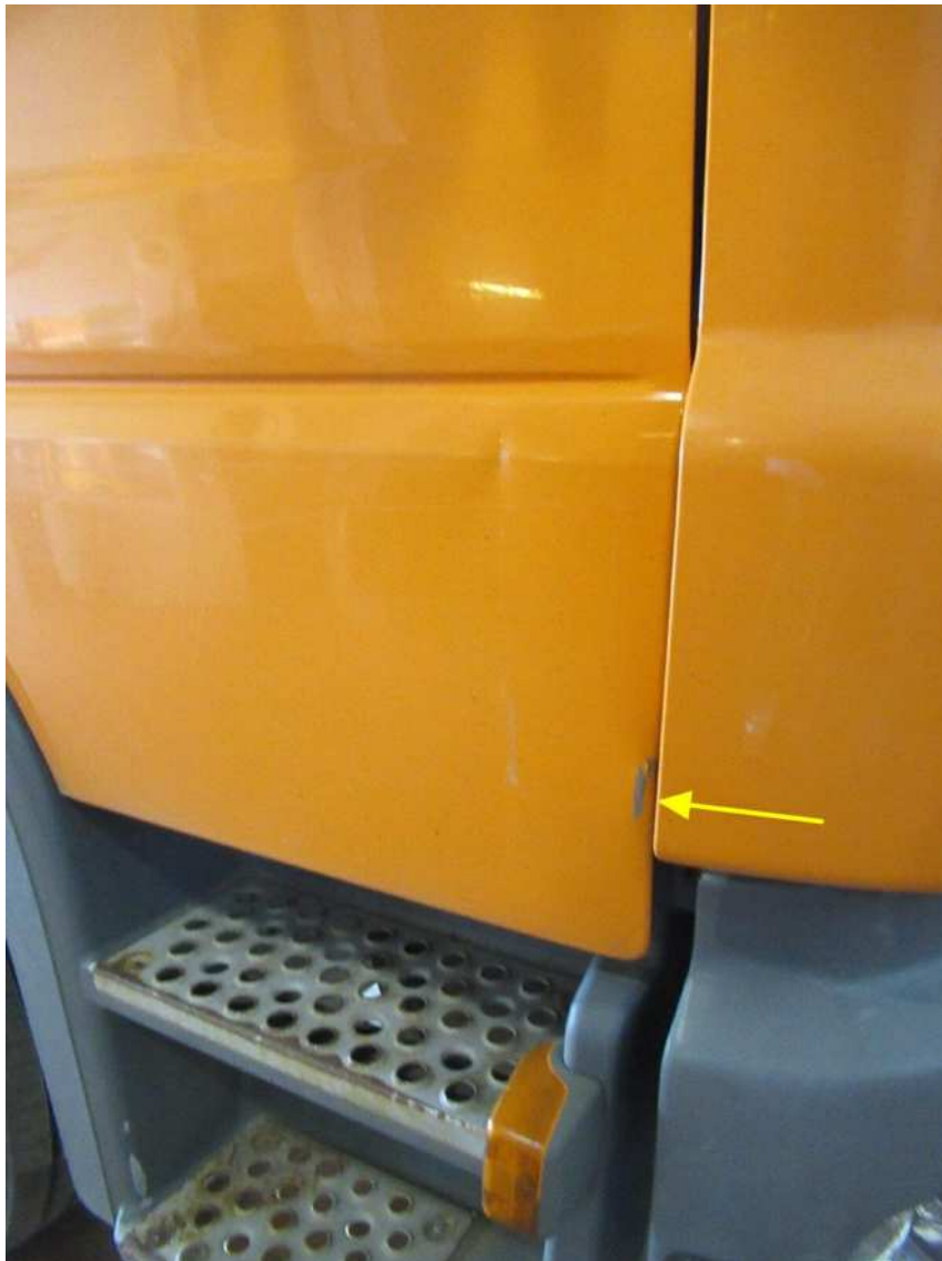
Bild 23 : Tür rechts geknickt
