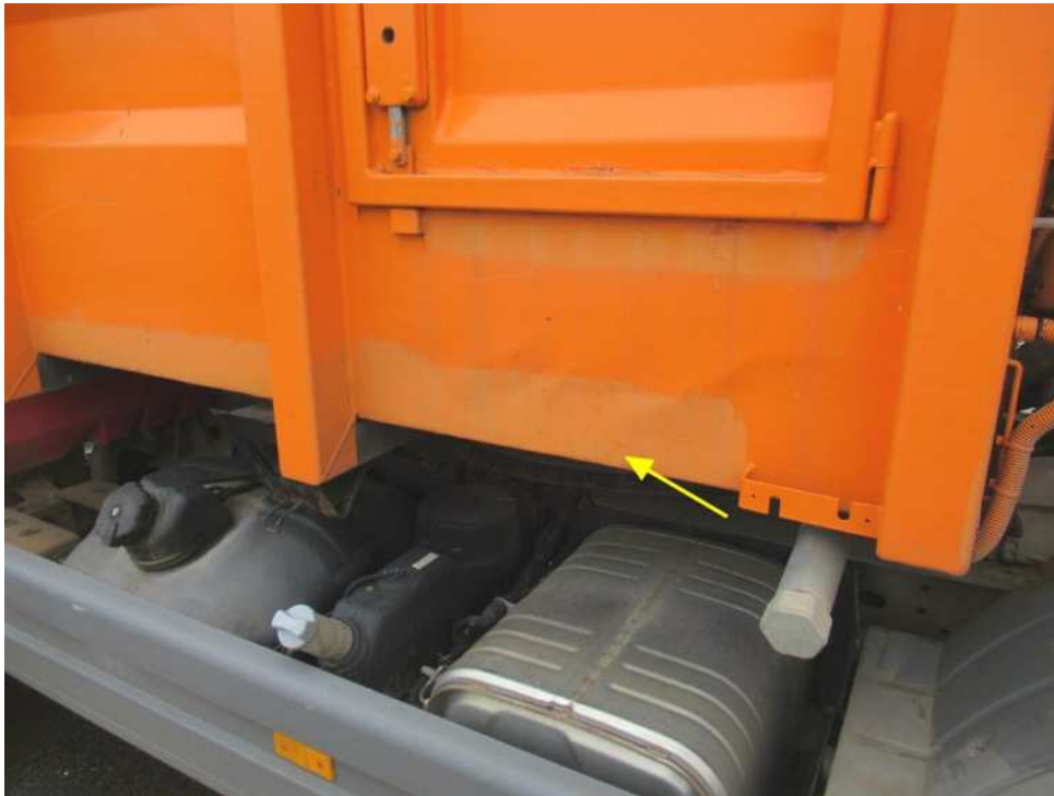
Bild 19 : diverse Rostunterwanderungen am gesamten Fahrzeug
