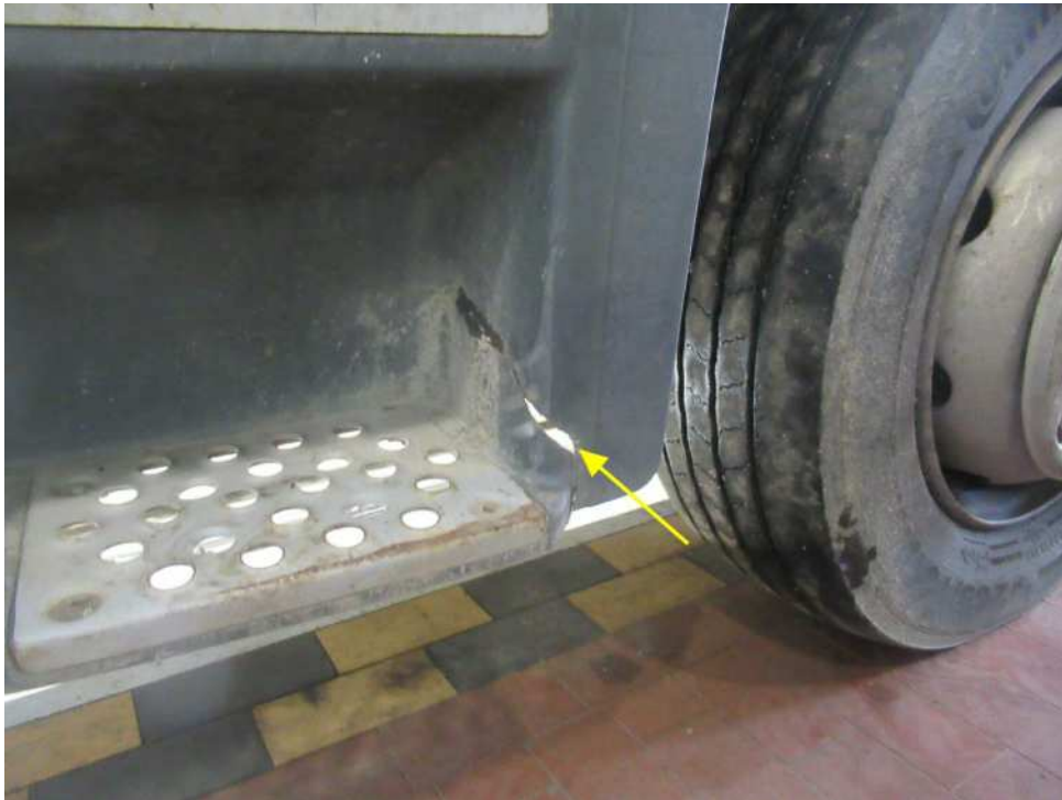
Bild 21 : Trittstufe links gerissen
