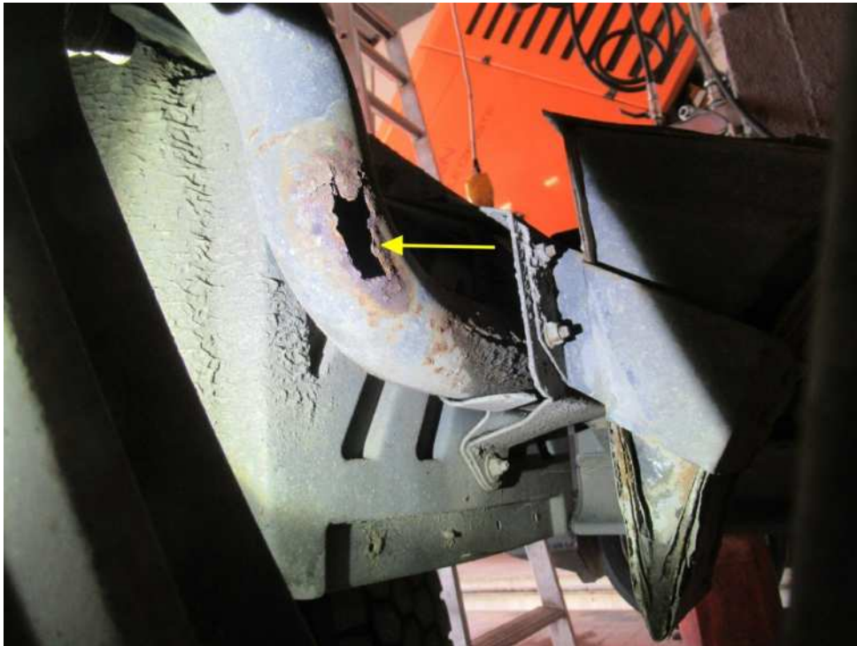
Bild 26 : Kotflügelhalter links Rostgeschwächt
