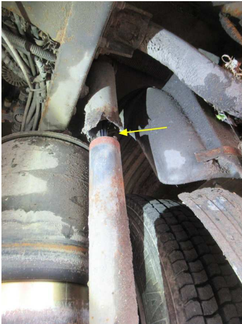
Bild 24 : Schutzkappen Stoßdämpfer hinten gebrochen
