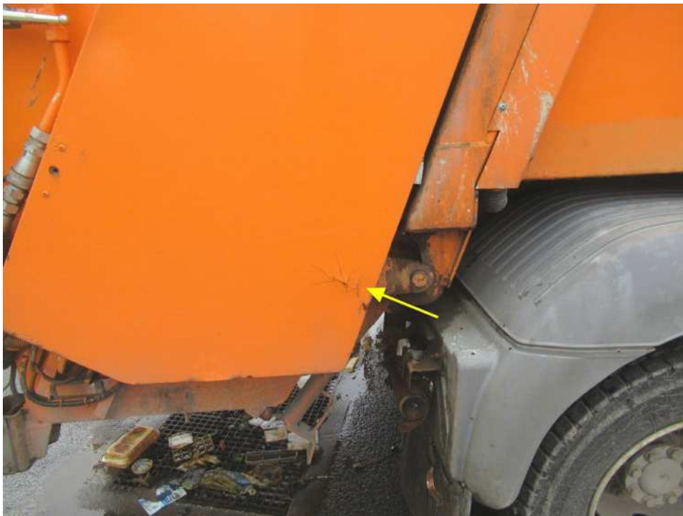
Bild 18 : diverse Rostunterwanderungen am gesamten Fahrzeug
