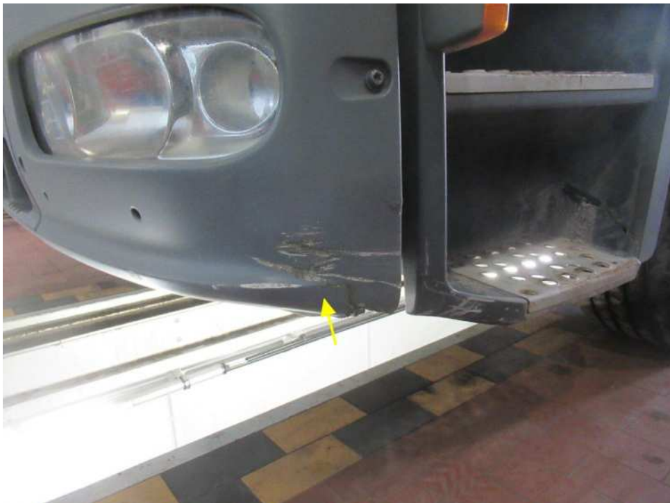
Bild 22 : Stoßfänger vorne gerissen
