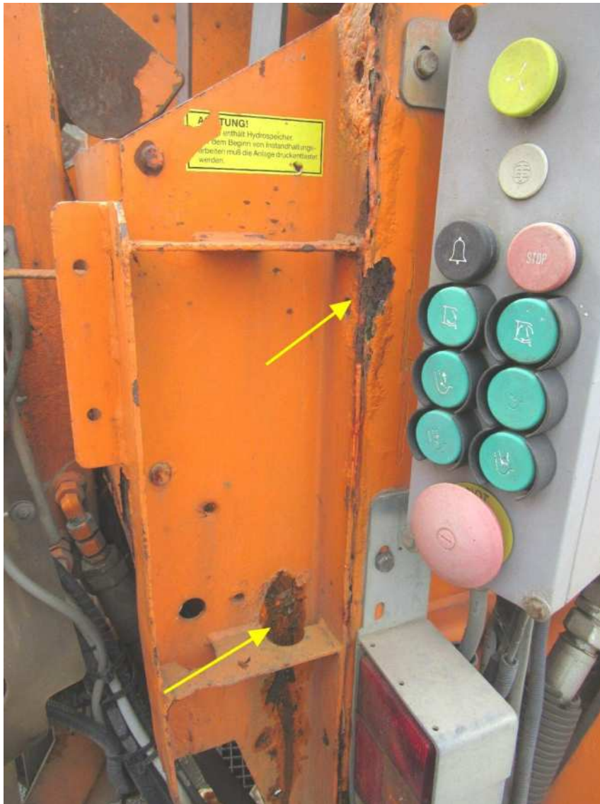
Bild 16 : diverse Rostunterwanderungen am gesamten Fahrzeug
