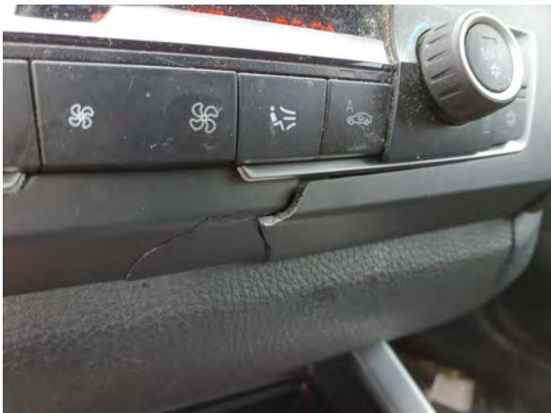
Beschädigung 12: Interieur: Innenraum (Rahmen Radio Bedienteil) - gebrochen / gerissen - erneuern
