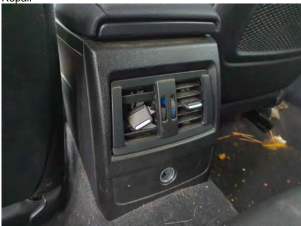
Beschädigung 8: Heizungssystem: Heizungssystem - gebroche... gerissen - erneuern
