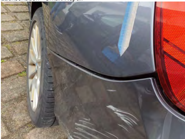
Beschädigung 21: Stossfänger hinten: Stossfänger hinten (+ Kratzer) - verformt - erneuern
