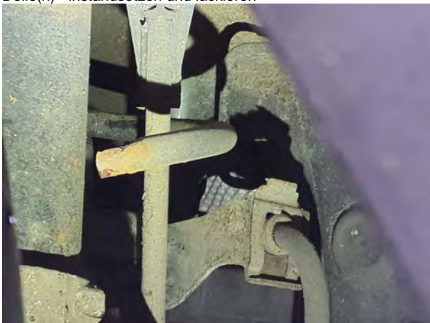
Beschädigung 18: Vorderachse: Feder rechts - gebrochen / gerissen - erneuern
