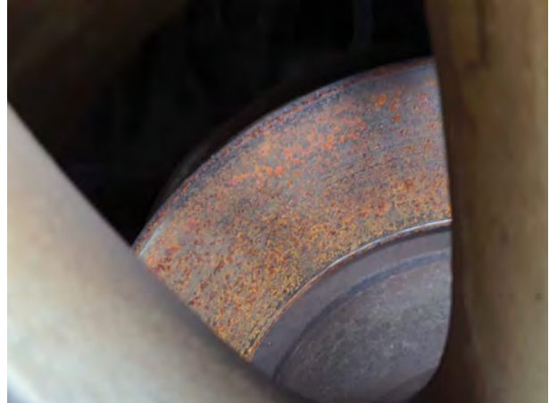
Beschädigung 15: Bremsanlage: Bremsscheiben und Beläge vorn - fällig - erneuern
