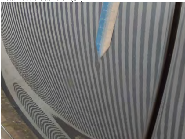
Beschädigung 17: Tür hinten rechts: Tür (+ Lackmangel) - Delle(n) - instandsetzen und lackieren
