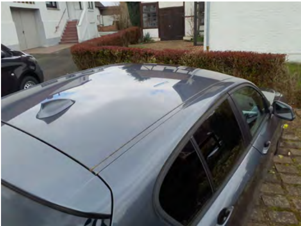
Beschädigung 3: Fahrzeugdach: Dach - Delle(n) - sanft instandsetzen
