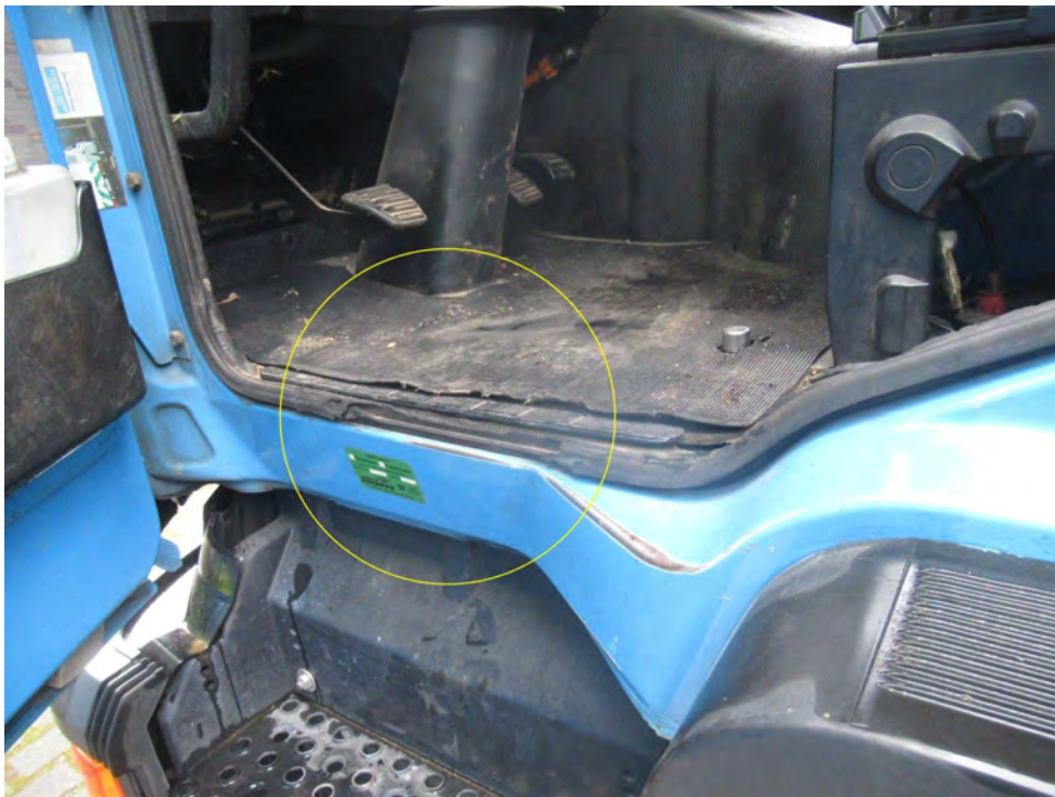
Bild 10 : Türdichtung links ein gerissen
