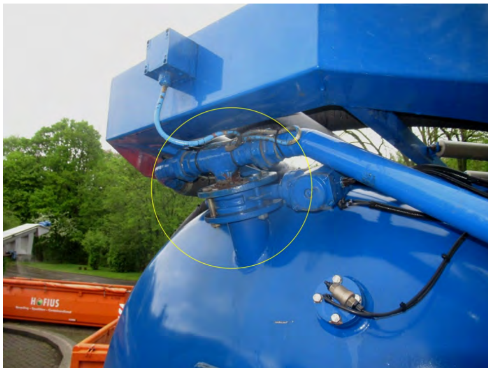
Bild 12 : Wasserverteiler vorne oben gerissen, prov. geschweißt, undicht
