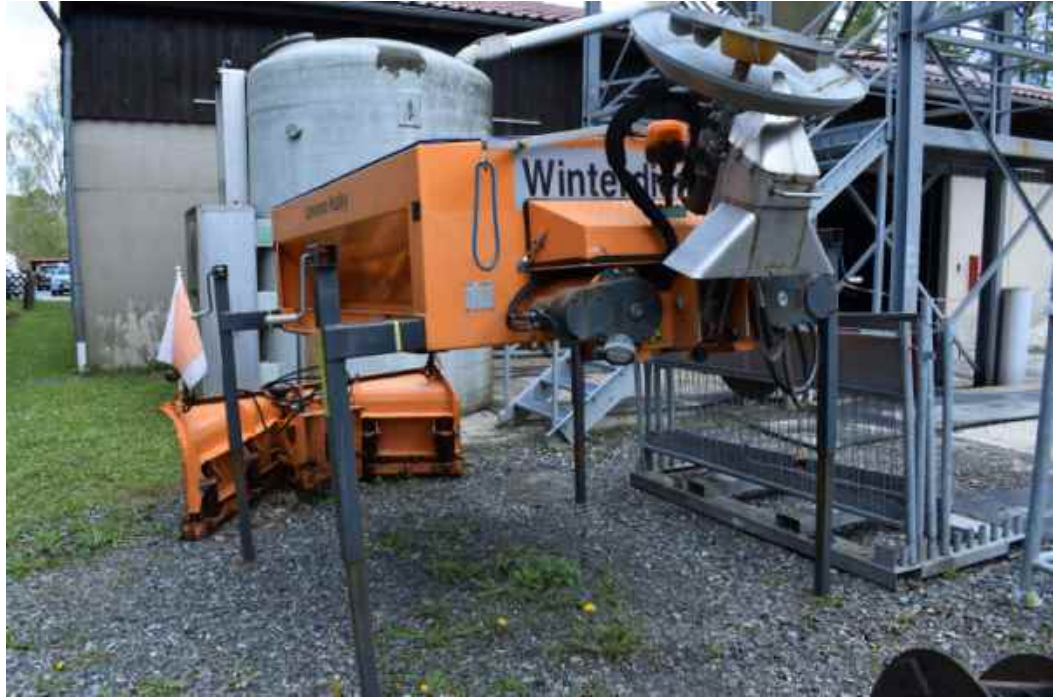
Übersicht vom Streuautomat/Keilräumschild
