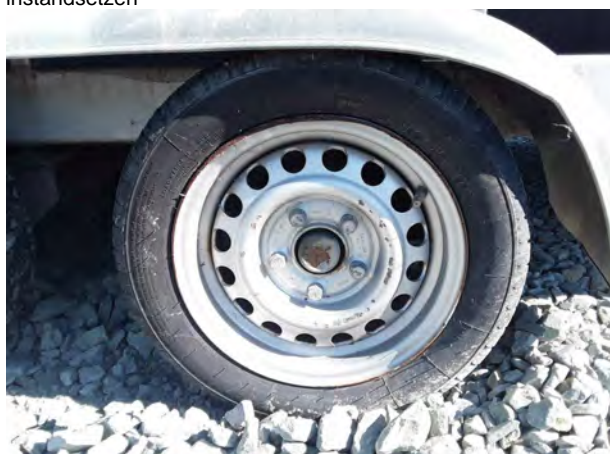
Beschädigung 9: Bremsanlage: Bremsanlage (Rad vorne rechts sitzt fest, Zusatzkosten möglich) - Funktion / Zulässigkeit -
