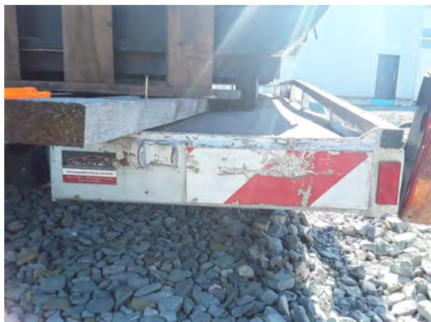
Beschädigung 8: Sonstiges: Fahrzeug (Rahmen) - Korrosion - instandsetzen
