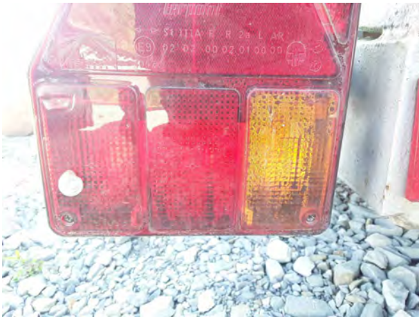
Beschädigung 5: Heckleuchte: Heckleuchte links - undicht - erneuern
