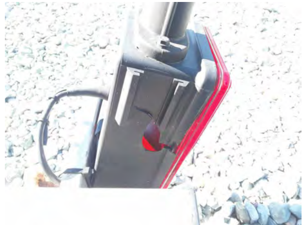
Beschädigung 6: Heckleuchte: Heckleuchte rechts - gebrochen / gerissen - erneuern
