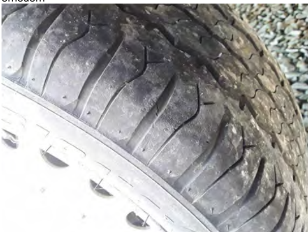
Beschädigung 7: Rad/Reifen: Reifen vorn links (+ hinten links) - porös / rissig - erneuern
