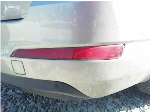
Beschädigung 4: Stossfänger hinten: Stossfänger hinten (Reflektor/Rückstrahler) - gebrochen / gerissen - erneuern
