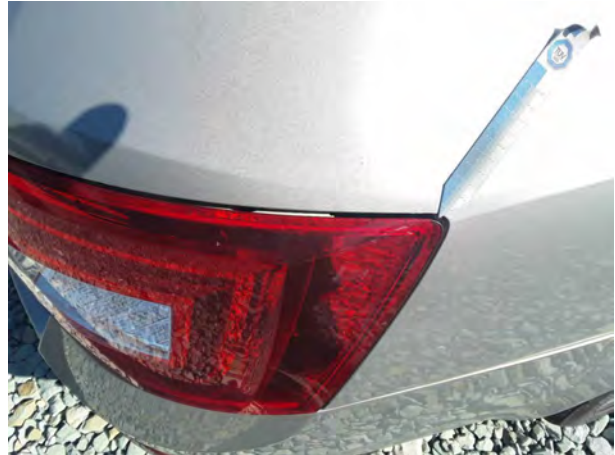
Beschädigung 3: Heckleuchte: Heckleuchte rechts - Fehlstellung - instandsetzen
