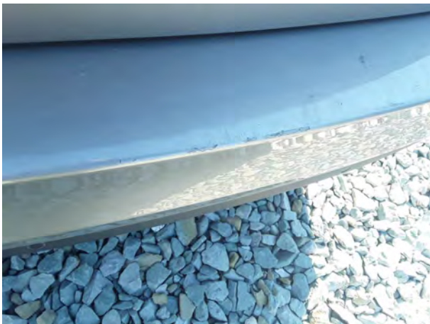
Beschädigung 6: Stossfänger hinten: Stossfänger hinten (Ladekante) - verkratzt / verschürft - Smart Repair
