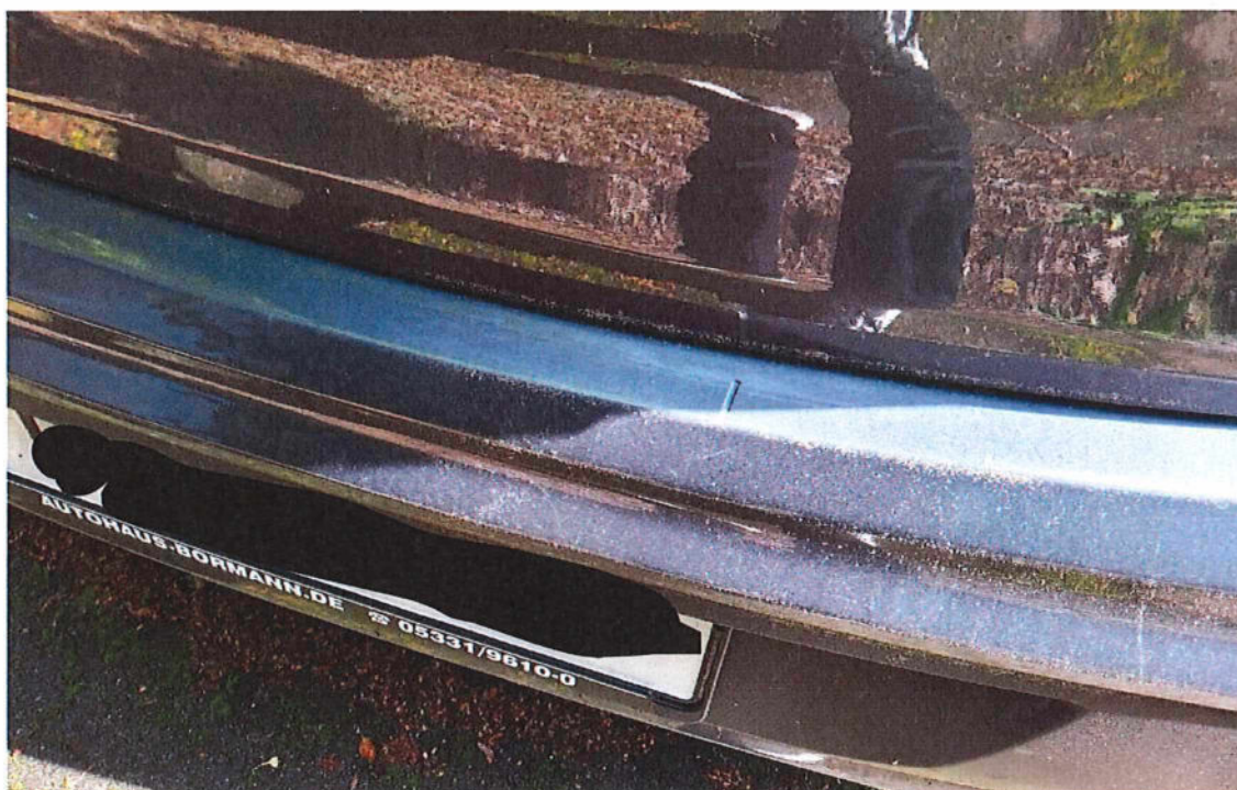
Bild 5 : Stoßfänger hinten verschrammt und verformt
