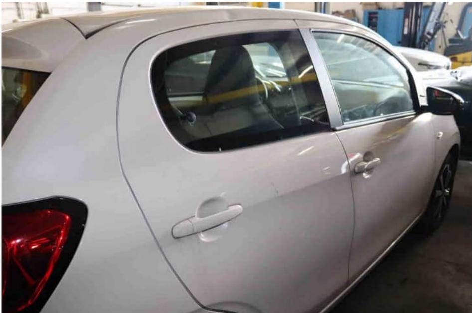
Bild 24 Schadenbereich deformierte Tür hinten rechts
