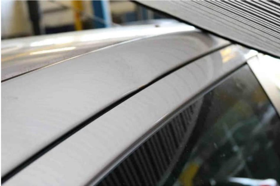
Bild 23 Detailaufnahme verformter Dachholm rechts hinten
