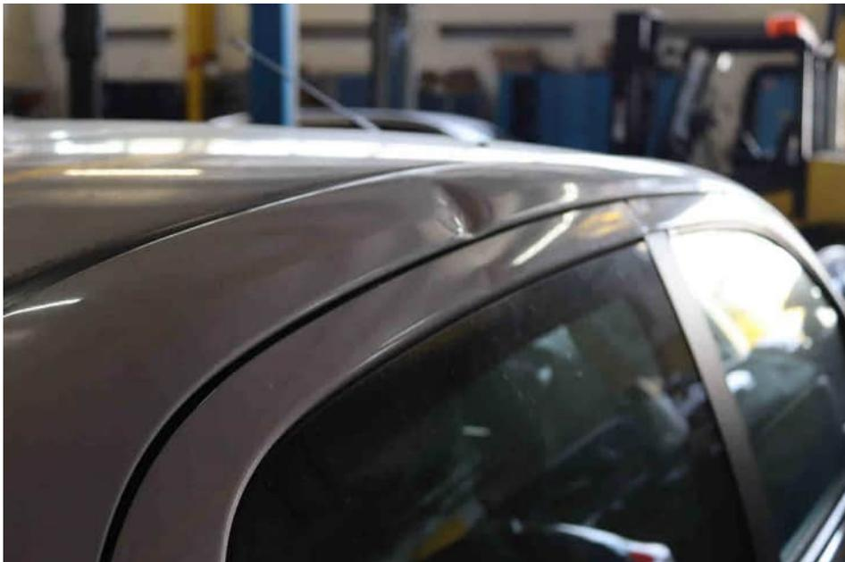
Bild 22 Schadenbereich verformter Dachholm rechts hinten
