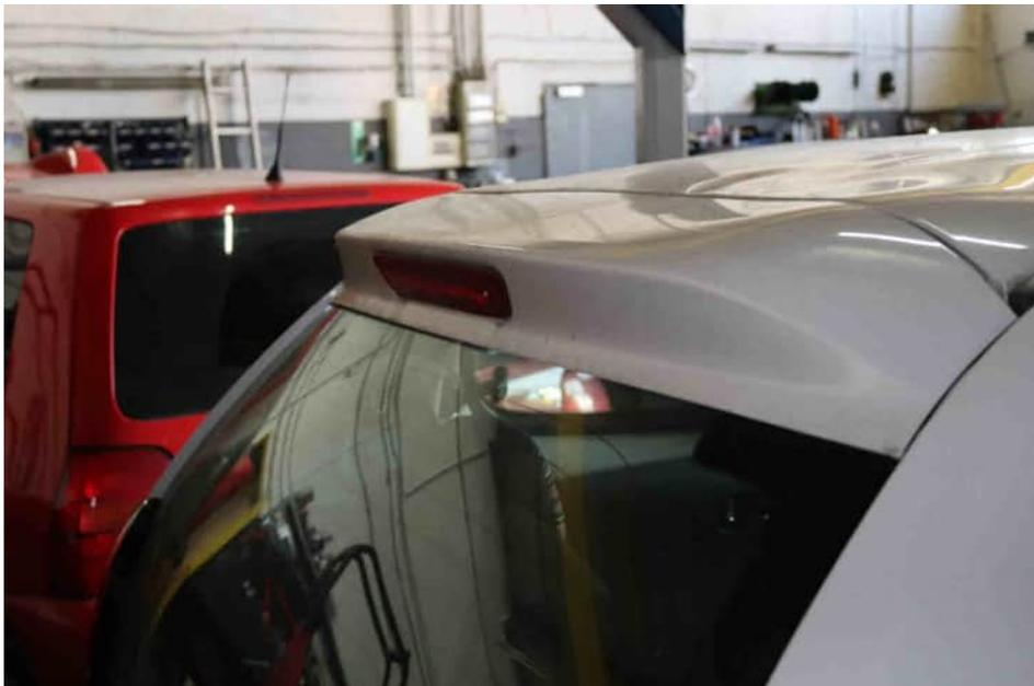
Bild 18 Schadenbereich verformter Dachspoiler hinten
