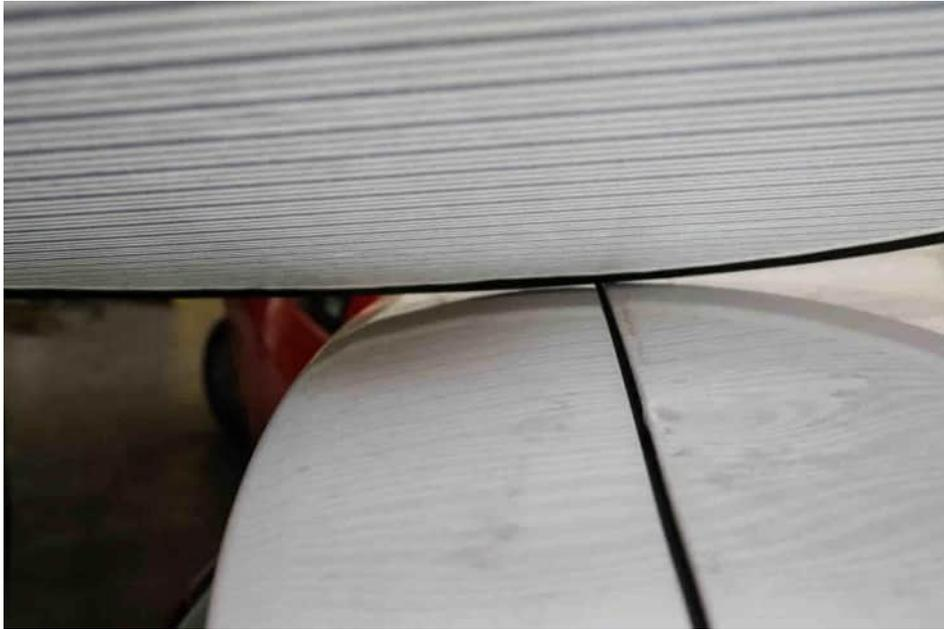
**Bild 19** Detailaufnahme verformter Dachspoiler hinten
