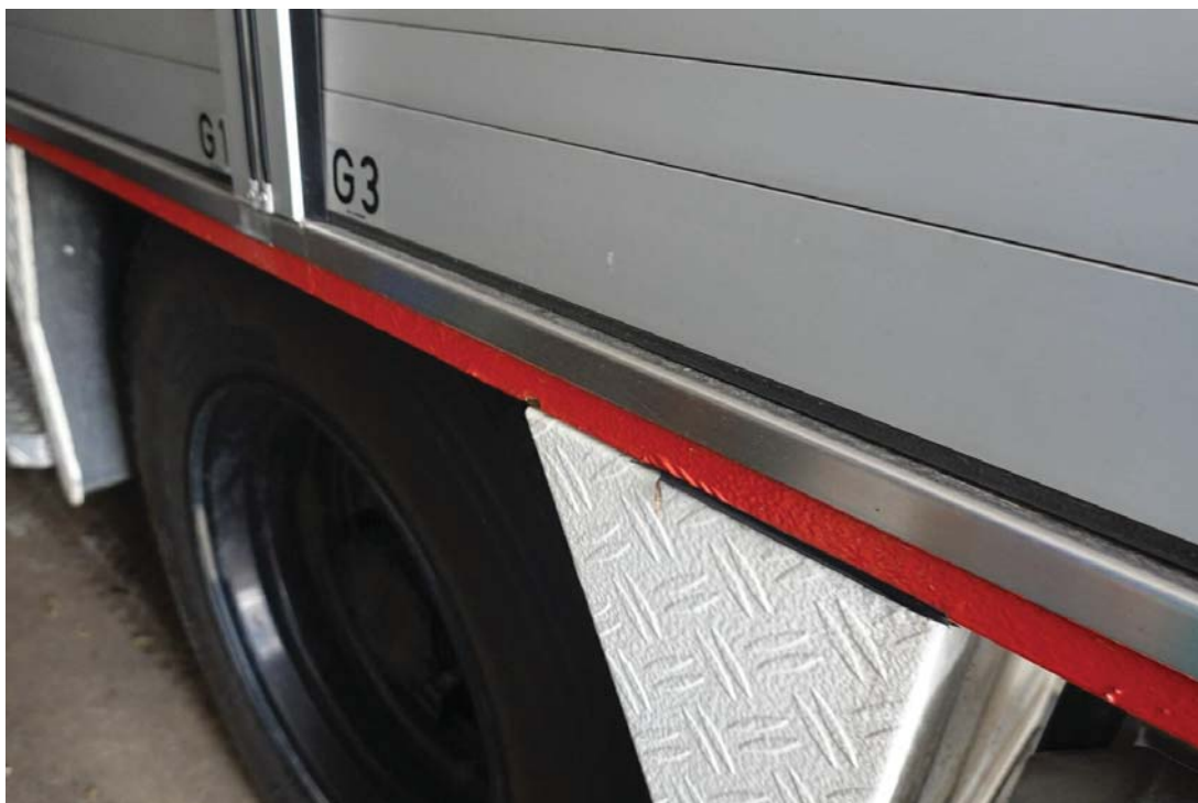
Bild 11 : Korrosion Aufbau seitlich links
