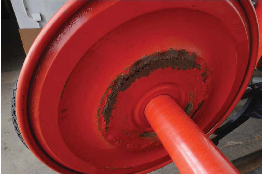
Bild 13 : Korrosion fahrbare Schlauchhaspel
