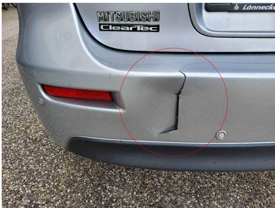
Bild 8 : Stoßfängerverkleidung hinten, zerbrochen
