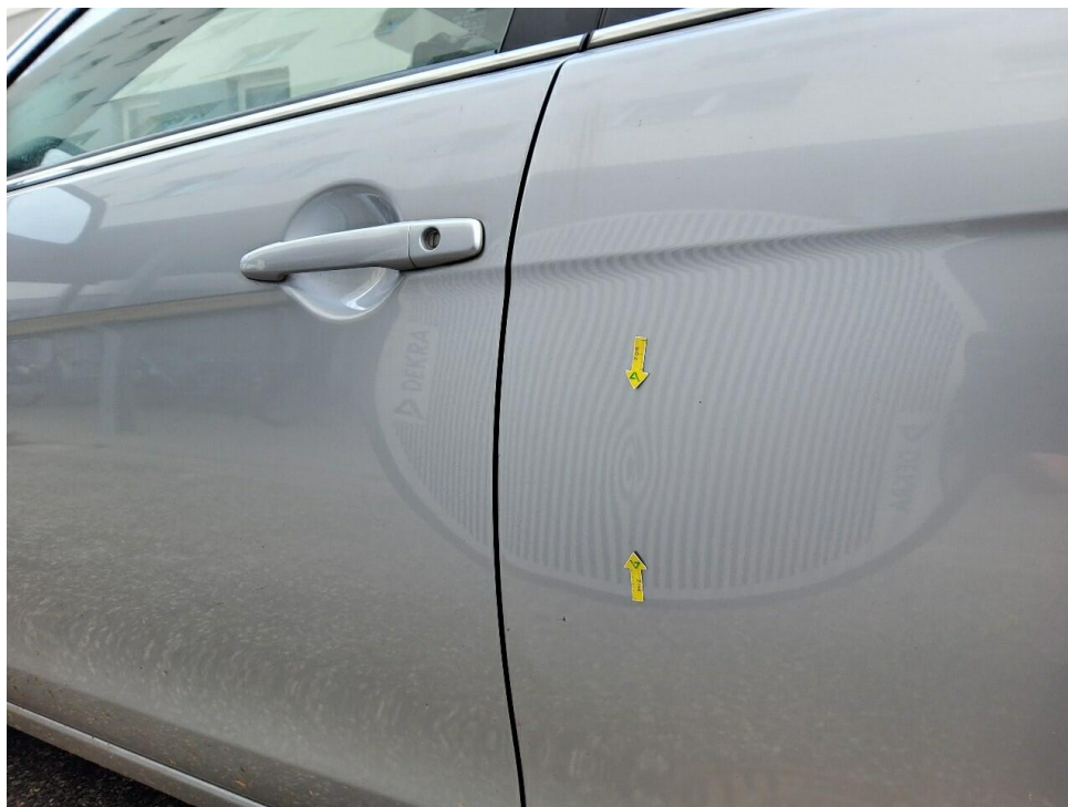
Bild 7 : Tür hinten links, eingedellt
