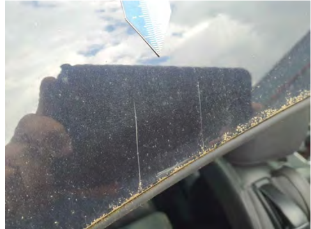
Beschadigung 2: Fahrzeugdach: Dachholm rechts - Kratzer - Smart Repair
