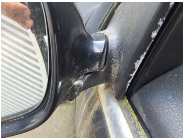
Beschädigung 12: Außenspiegel links: Außenspiegel - defekt - erneuern
