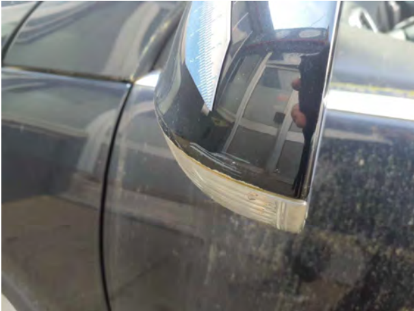
Beschadigung 1: AuBenspiegel links: Abdeckkappe - Kratzer - lackieren
