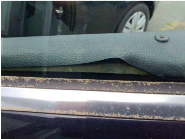
Beschädigung 17: Verkleidungen/Abdeckungen: Türverkleidung vorn links - lose - erneuern
