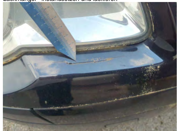
Beschädigung 16: Stossfänger vorn: Stossfänger vorn - Lackmangel - instandsetzen und lackieren
