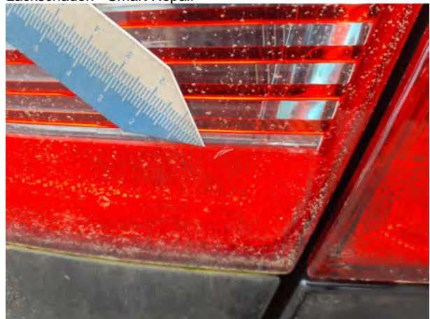
Beschädigung 9: Heckleuchte: Heckleuchte rechts - beschädigt - erneuern
