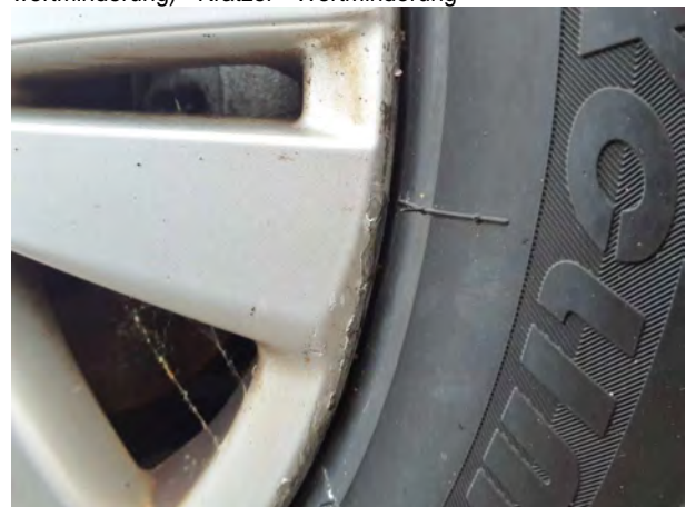
Beschadigung 5: Rad/Reifen: Leichtmetallfelge vorn rechts - Kratzer - Smart Repair
