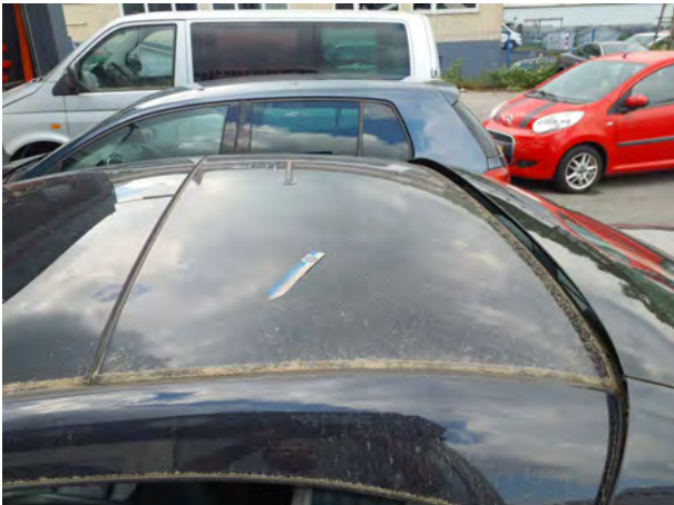
Beschadigung 3: Fahrzeugdach: Dach (+ Scheibe wertminderu... - Kratzer - Wertminderung
