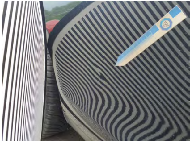
Beschädigung 6: Seitenwand rechts: Seitenwand - Delle / Lackschaden - Smart Repair
