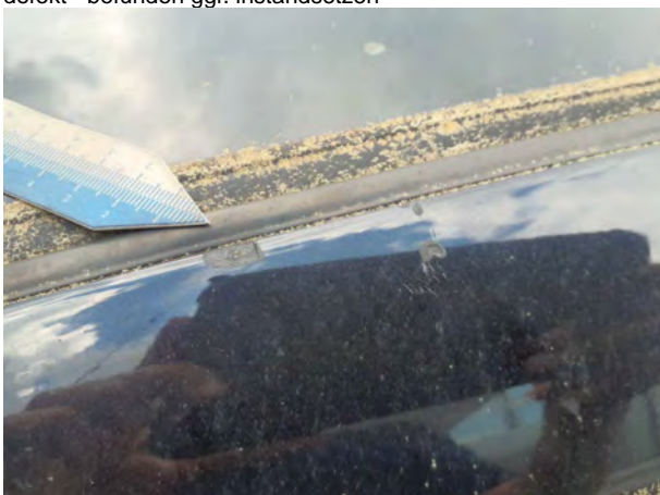
Beschädigung 15: Fahrzeugdach: Dachholm links - Kratzer - lackieren
