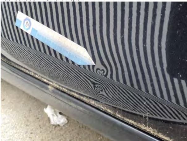
Beschädigung 7: Tür vorn rechts: Tür - Delle / Lackschaden - Smart Repair
