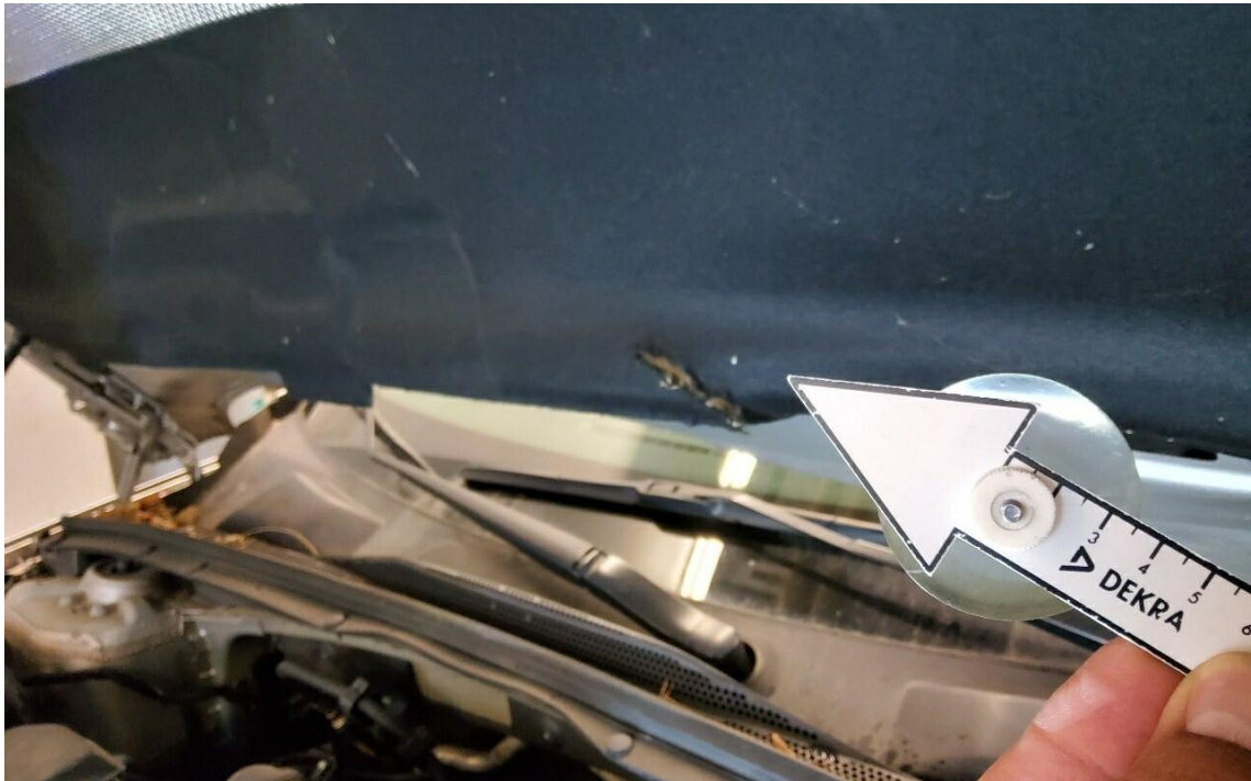
Bild 5 : Dämmmatte der Motorhaube, gerissen
