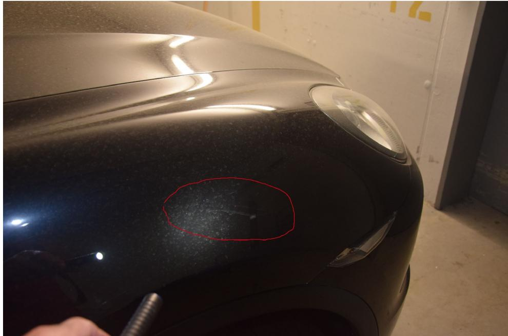
Bild 3 Kratzer im Kotflügel vorne rechts
