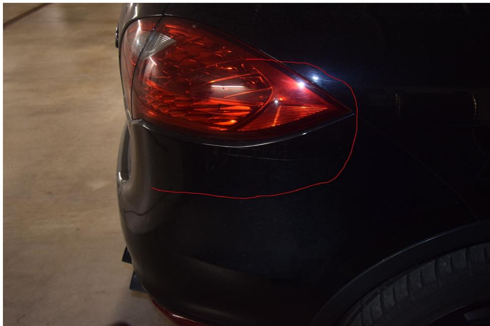
Bild 4 Kratzer in Seitenwand hinten rechts
