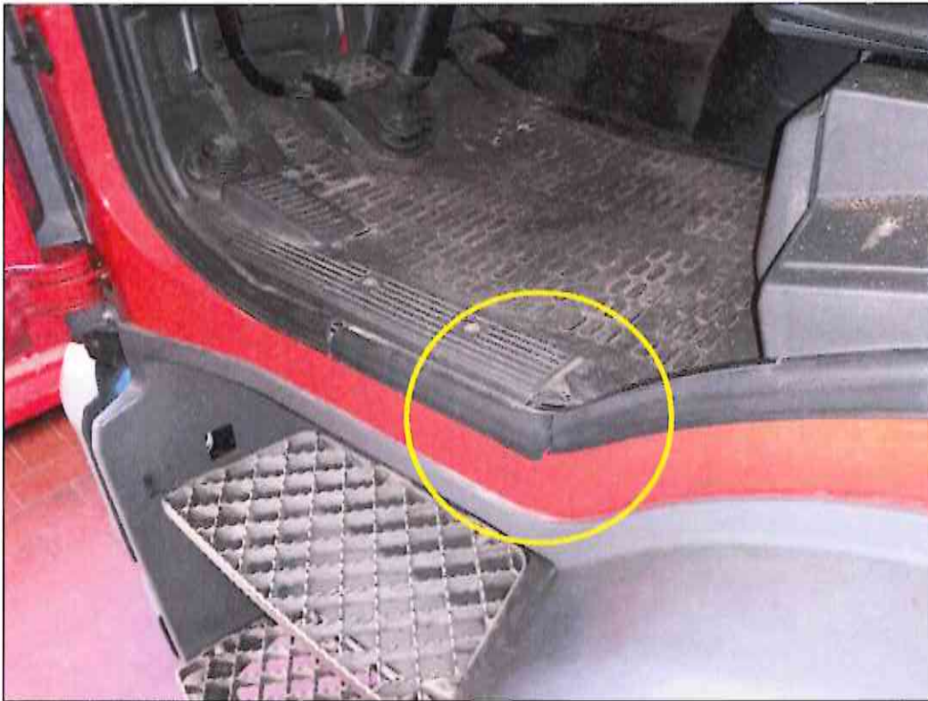
Bild 23 Türdichtung Einstieg links defekt
