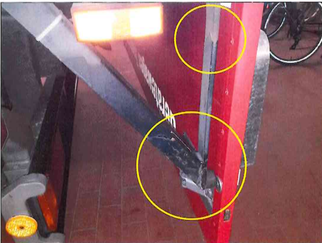
Bild 28 Anschlag Heckklappe verformt
