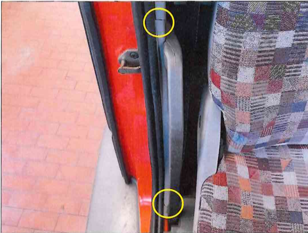
Bild 19 gebrochene B-Säulenverkleidung am Beispiel der rechten Fahrzeugseite
