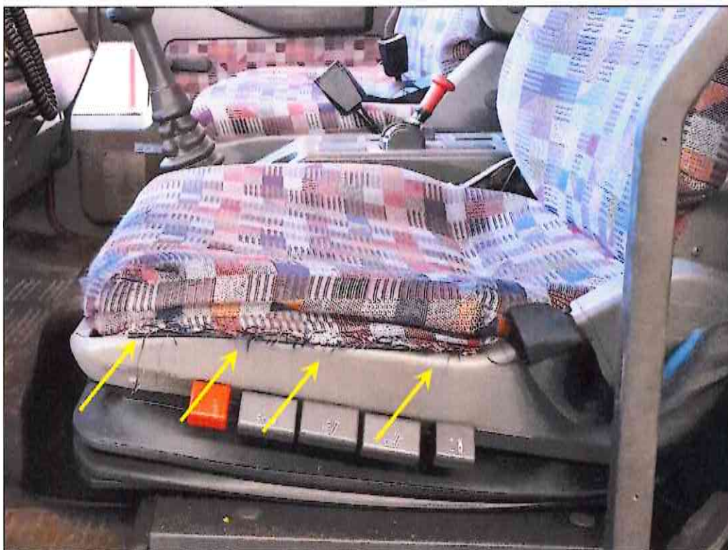
Bild 22 Sitzkissen links beschädigt
