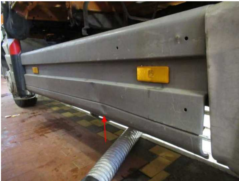
Bild 35 : Seiteneinfahrtschutz links verformt
