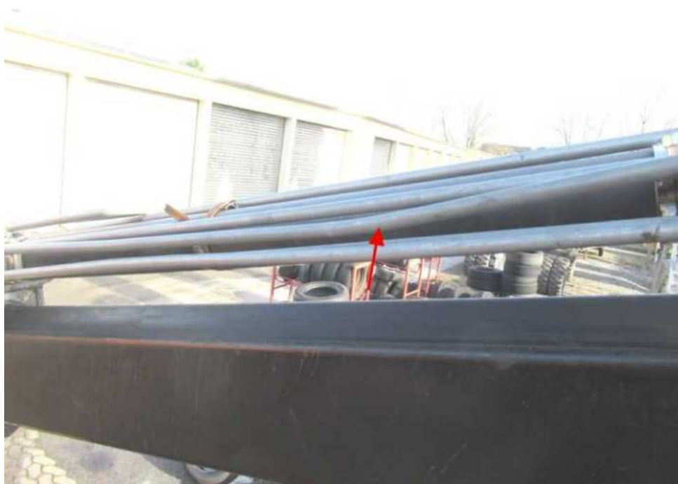
Bild 26 : diverse Hydraulikleitungen deformiert und teilweise lose, prüfen und erneuern
