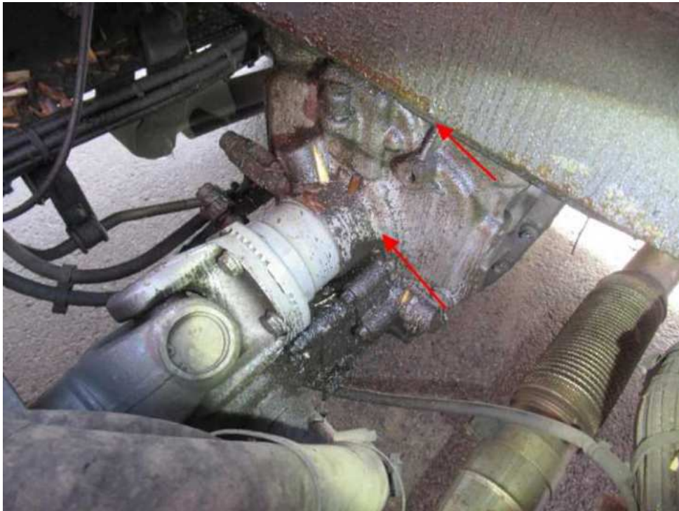
Bild 15 : Kranhydraulik ölundicht reinigen und prüfen
