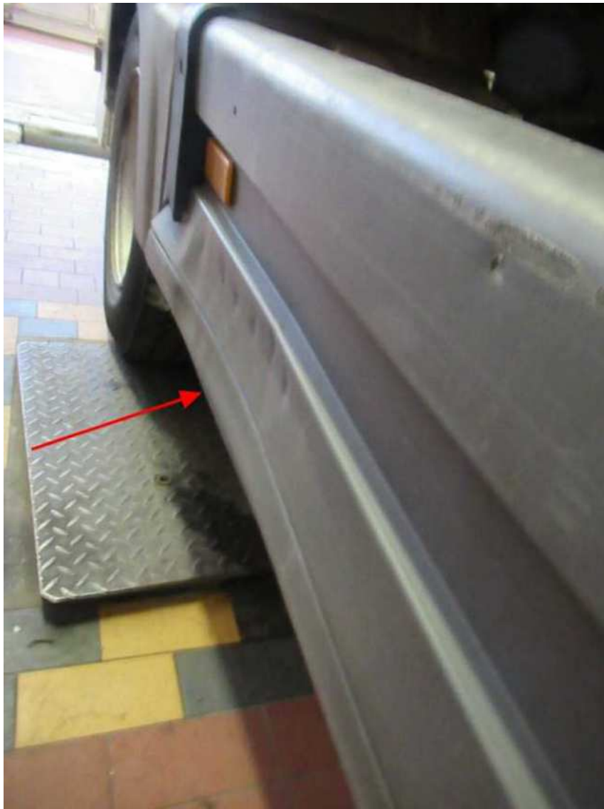
Bild 31 : Seiteneinfahrtschutz rechts verformt
