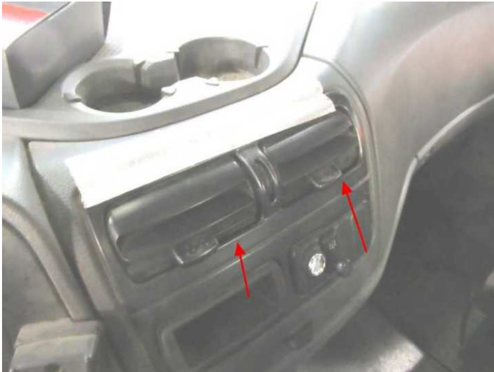
Bild 29 : Luftdüsen mitte gebrochen
