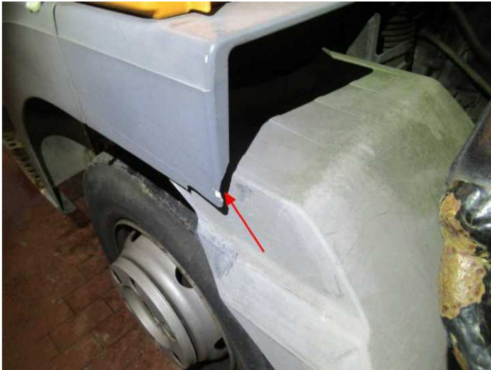
Bild 36 : Kotflügel vorne links oben gebrochen
