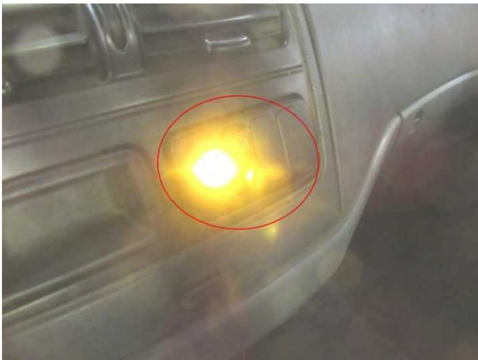
Bild 30 : Warnlampe Nebenaggregat leuchtet sporadisch
