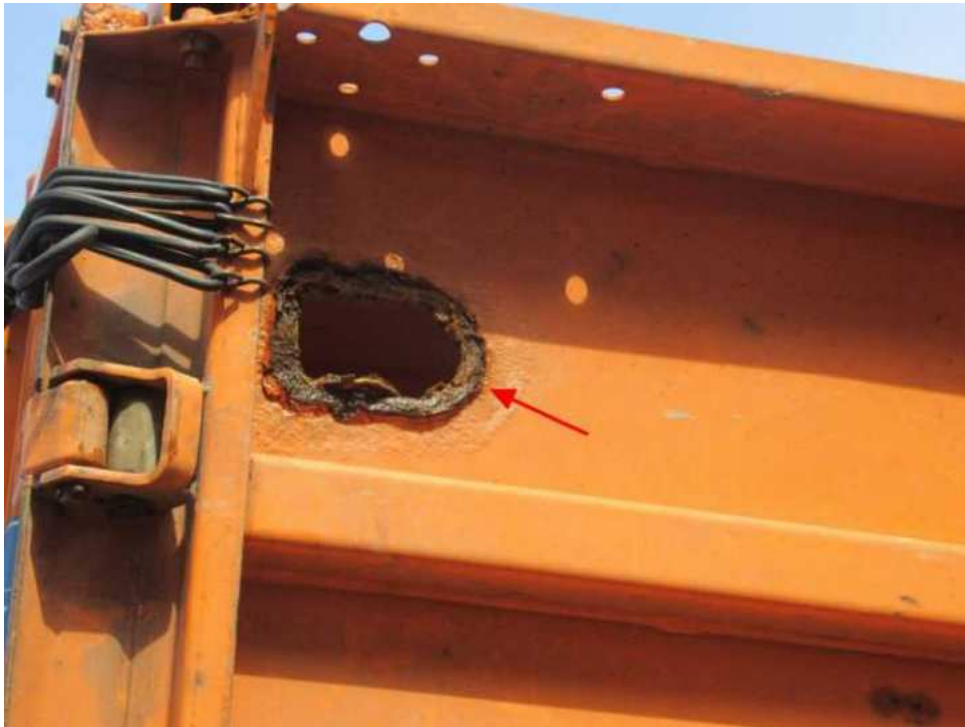
Bild 19 : Zurlasche Ladeboden ausgerissen
