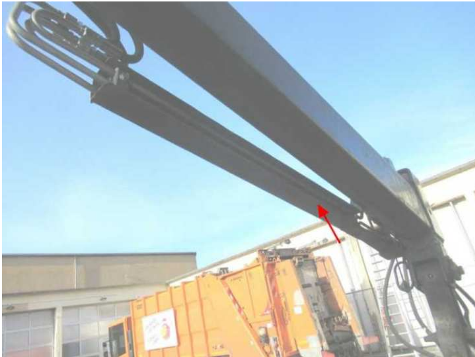
Bild 21 : Schutzblech Hydraulikleitungen Kranausleger verformt
