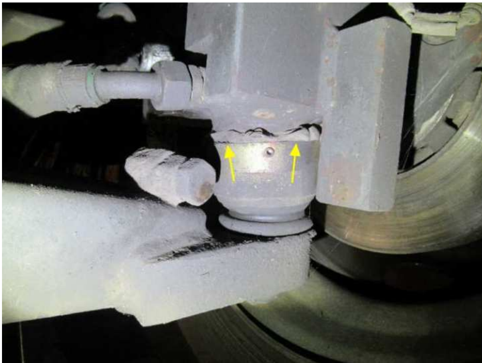
Bild 16 : Querlenkerlager vorne rechts mit Silikon abgedichtet
