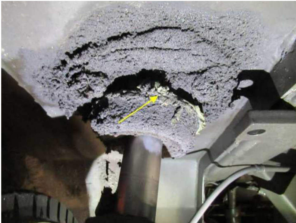
Bild 15 : diverse Schmierpunkte stark mit Fett verschmutzt
