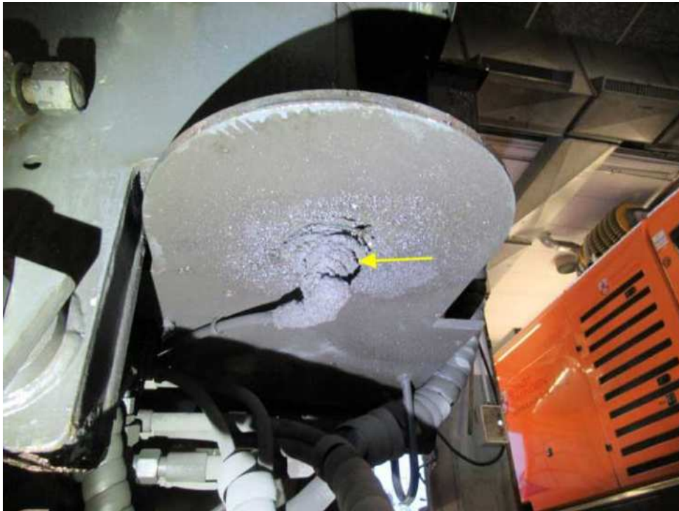
Bild 13 : diverse Schmierpunkte stark mit Fett verschmutzt
