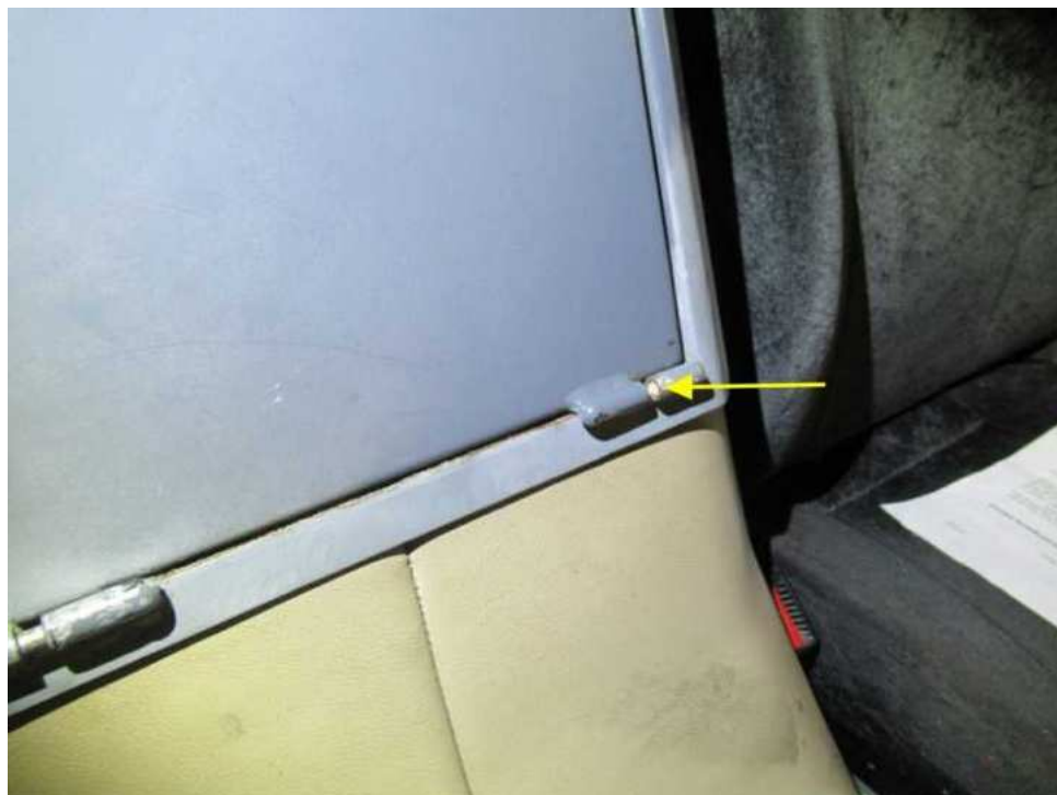
Bild 12 : Scharnier Stauklappe Kabine gebrochen
