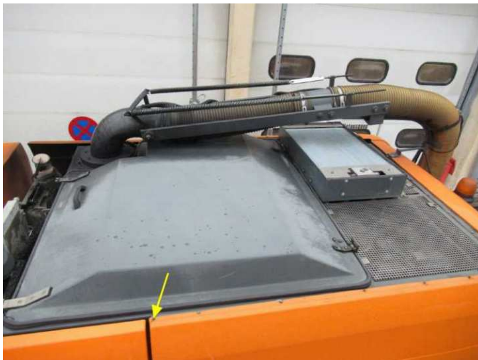
Bild 22 : Behälterverkleidung links gerissen
