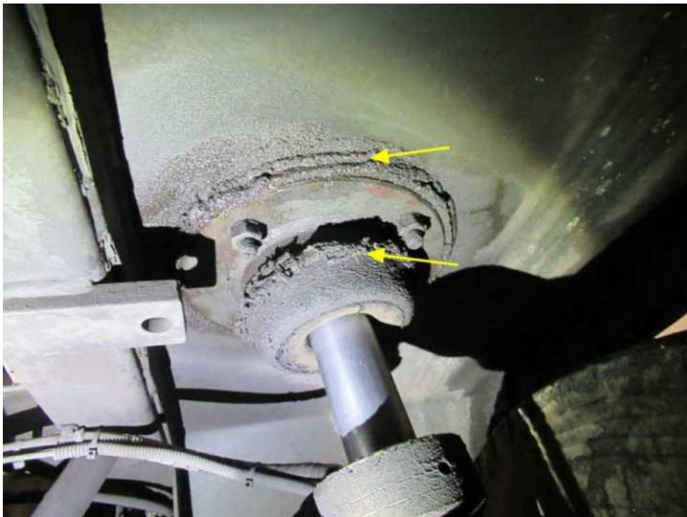
Bild 14 : diverse Schmierpunkte stark mit Fett verschmutzt
