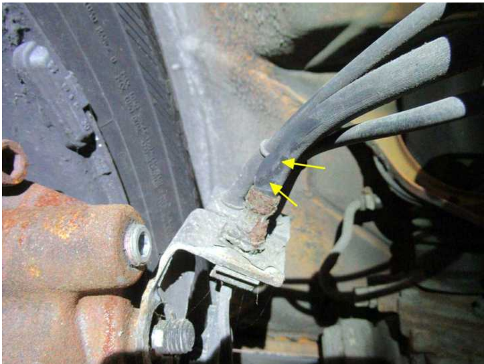
Bild 36 : Blasenbildung Bremsschläuche vorne
