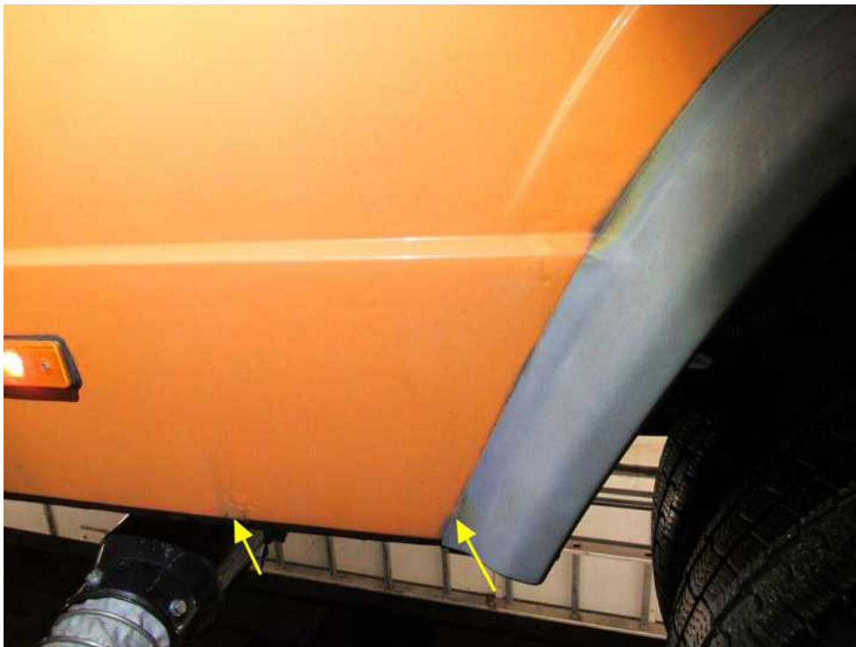
Bild 24 : Radläufe der hinteren Seitenwände starker Rostbefall
