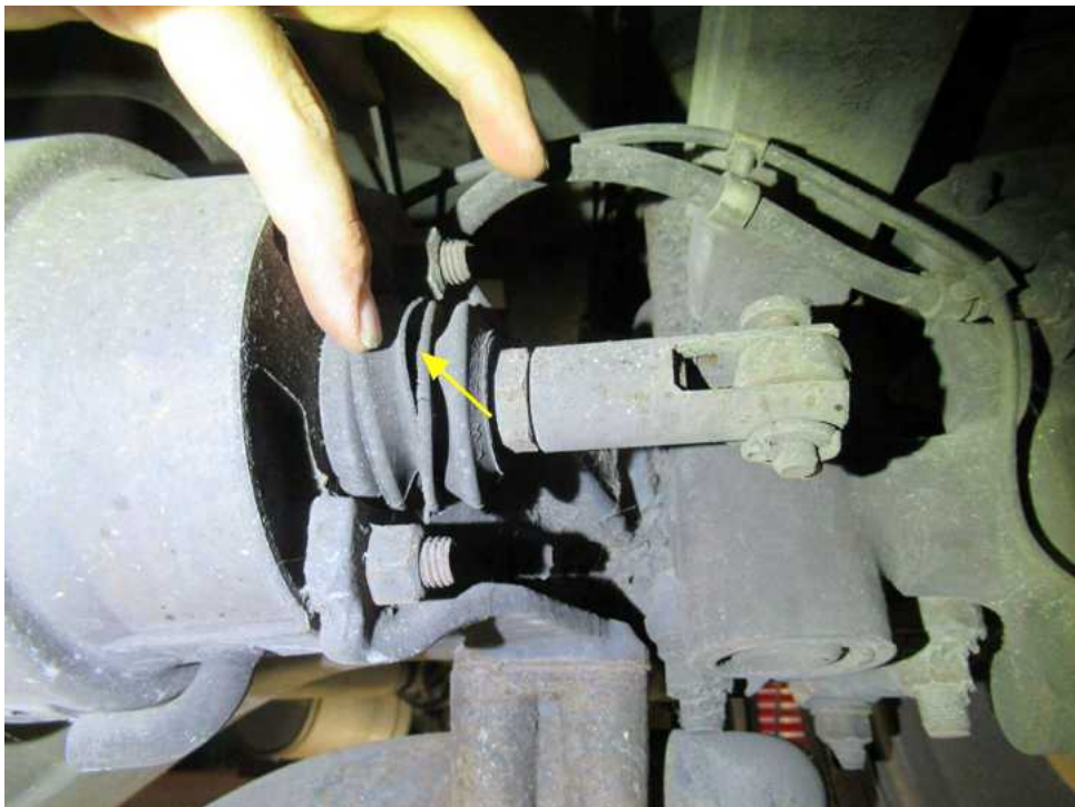
Bild 38 : Gummimanschette Federspeicherbremszylinder gerissen
