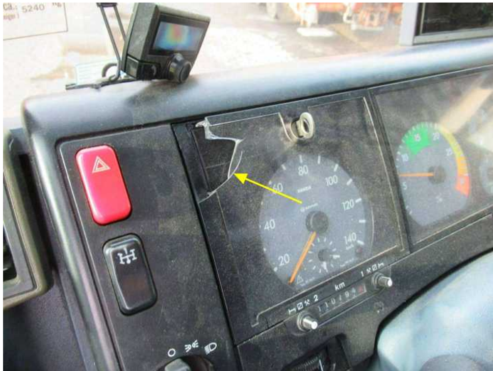
Bild 15 : Cockpitverglasung um Kombiinstrument gebrochen
