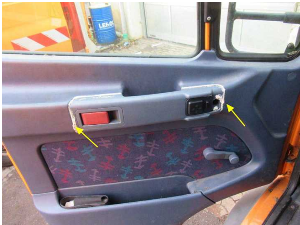
Bild 16 : Türverkleidungen vorne links und rechts provisorisch verklebt und getakert
