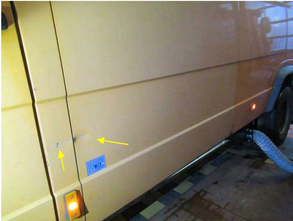
Bild 33 : B-Säule und Seitenwandvorderteil links streifend deformiert
