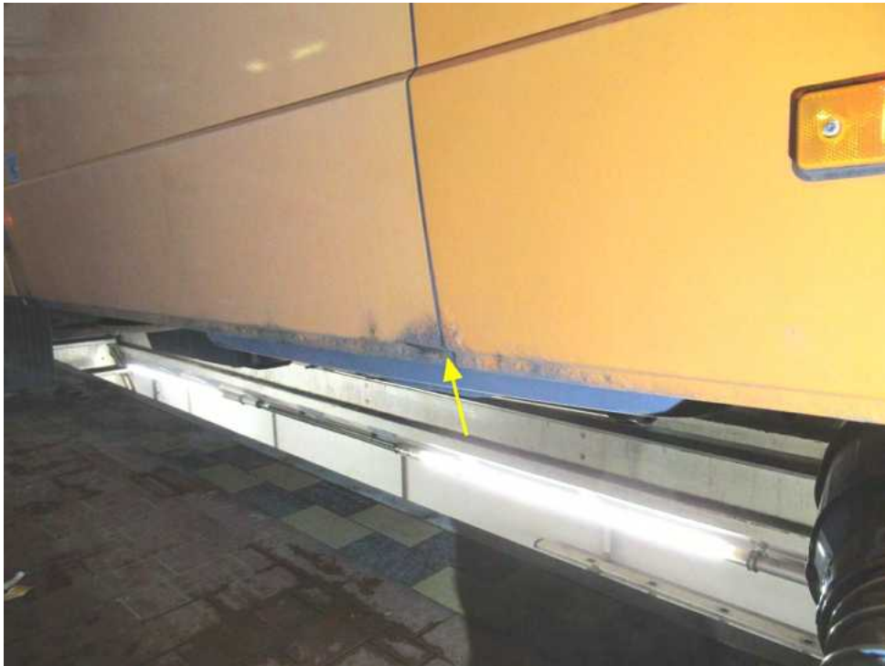
Bild 25 : starker Rostbefall an Karosserieunterkanten rundherum mit Durchrostungen
