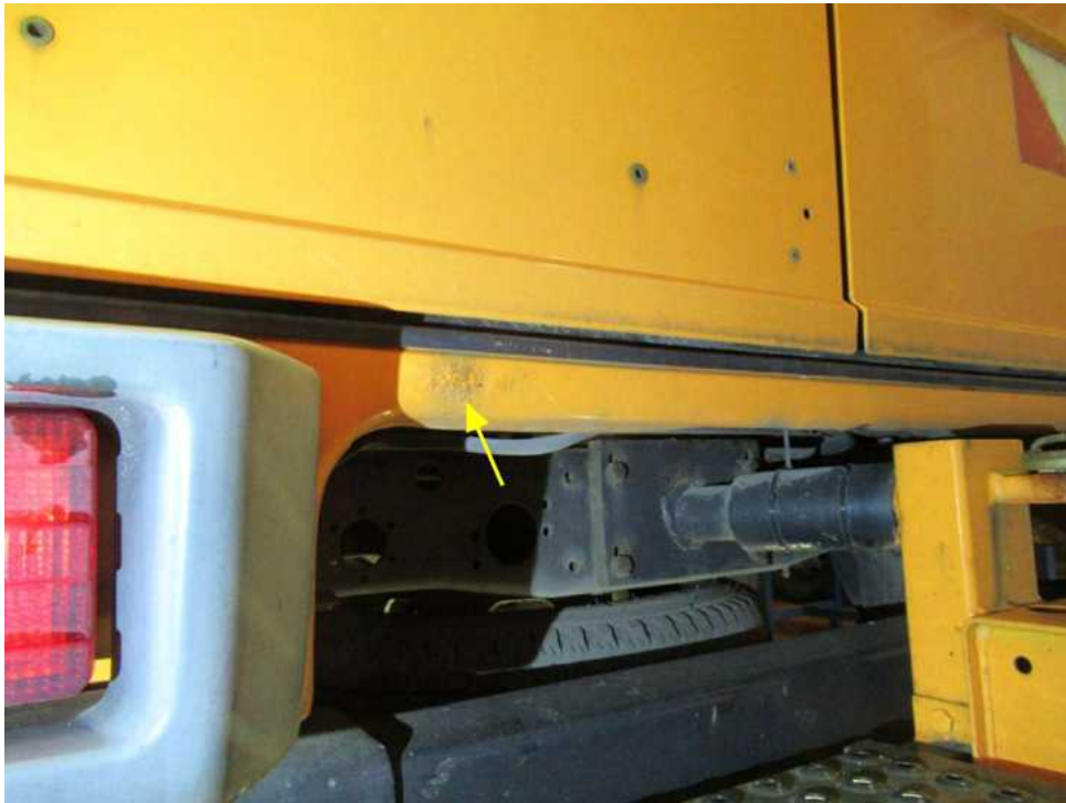
Bild 31 : starker Rostbefall an Karosserieunterkanten rundherum mit Durchrostungen
