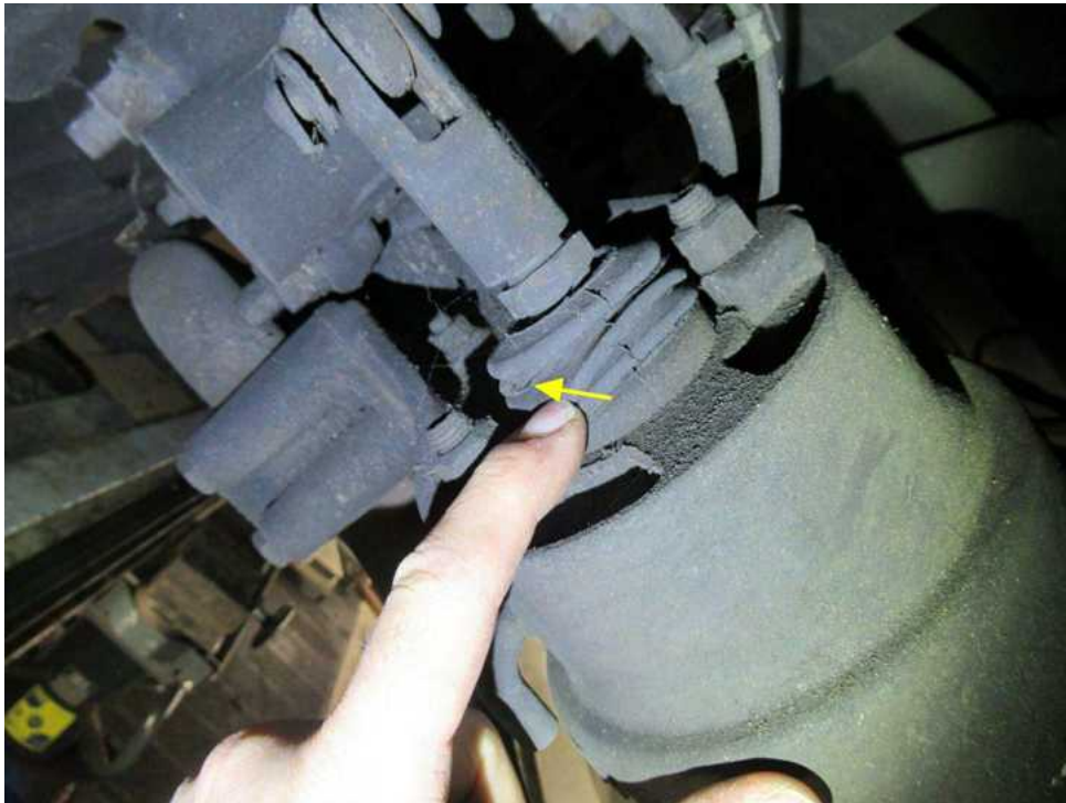
Bild 39 : Gummimanschette Federspeicherbremszylinder gerissen
