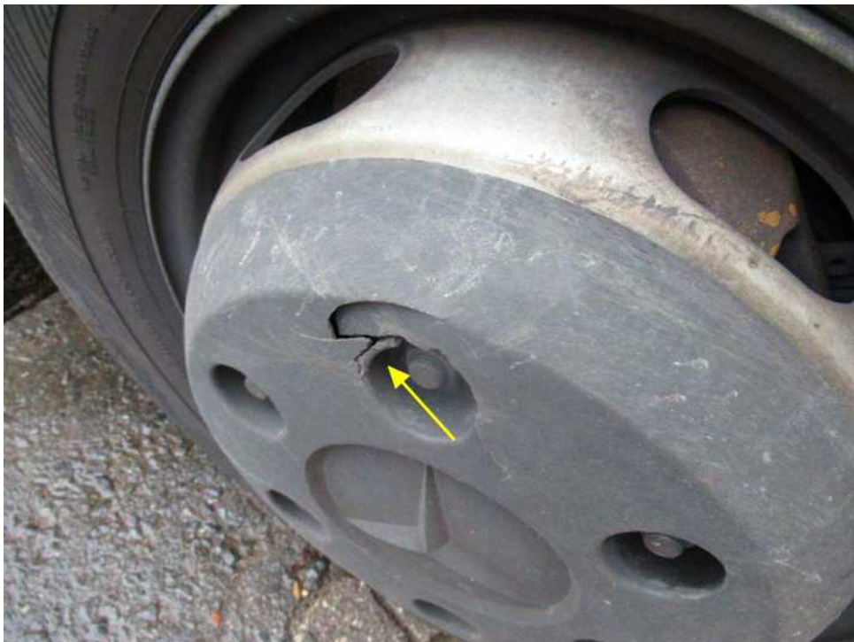
Bild 22 : Radmutternkappe vr gerissen Radmutternschutzkappe vorne rechts gebrochen
