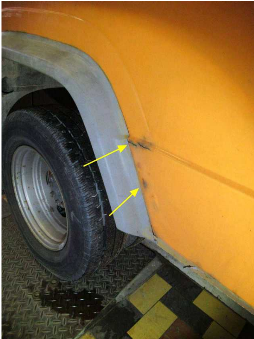
Bild 27 : Radläufe der hinteren Seitenwände starker Rostbefall
