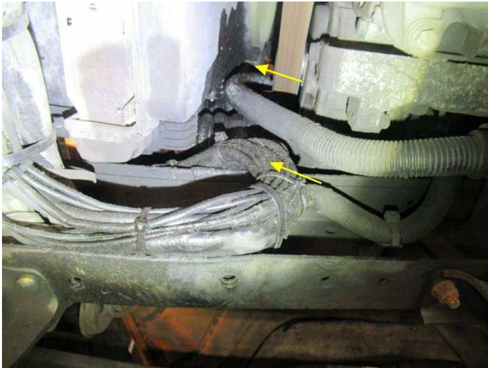
Bild 35 : Motorölverlust im Bereich Ladelufttröhre
