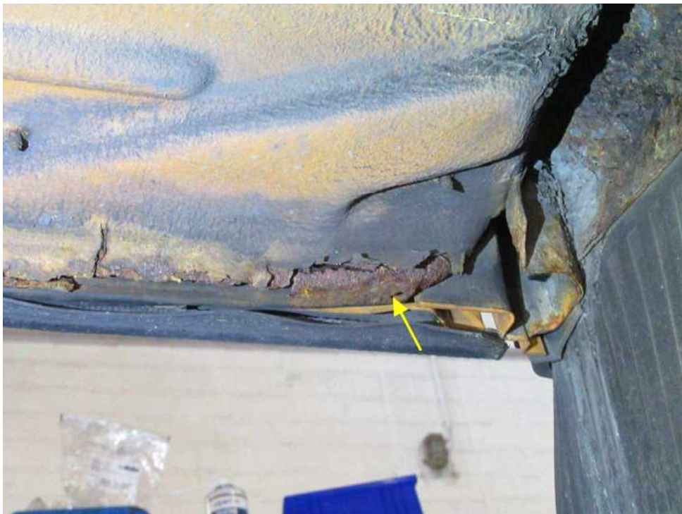
Bild 26 : starker Rostbefall an Karosserieunterkanten rundherum mit Durchrostungen
