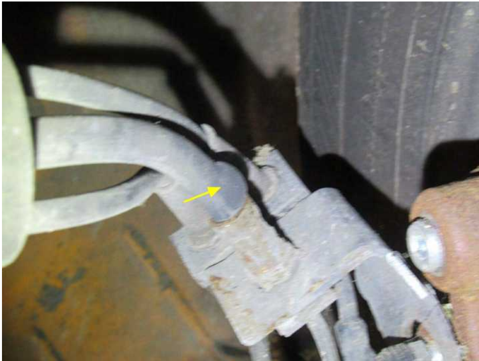
Bild 37 : Blasenbildung Bremsschläuche vorne
