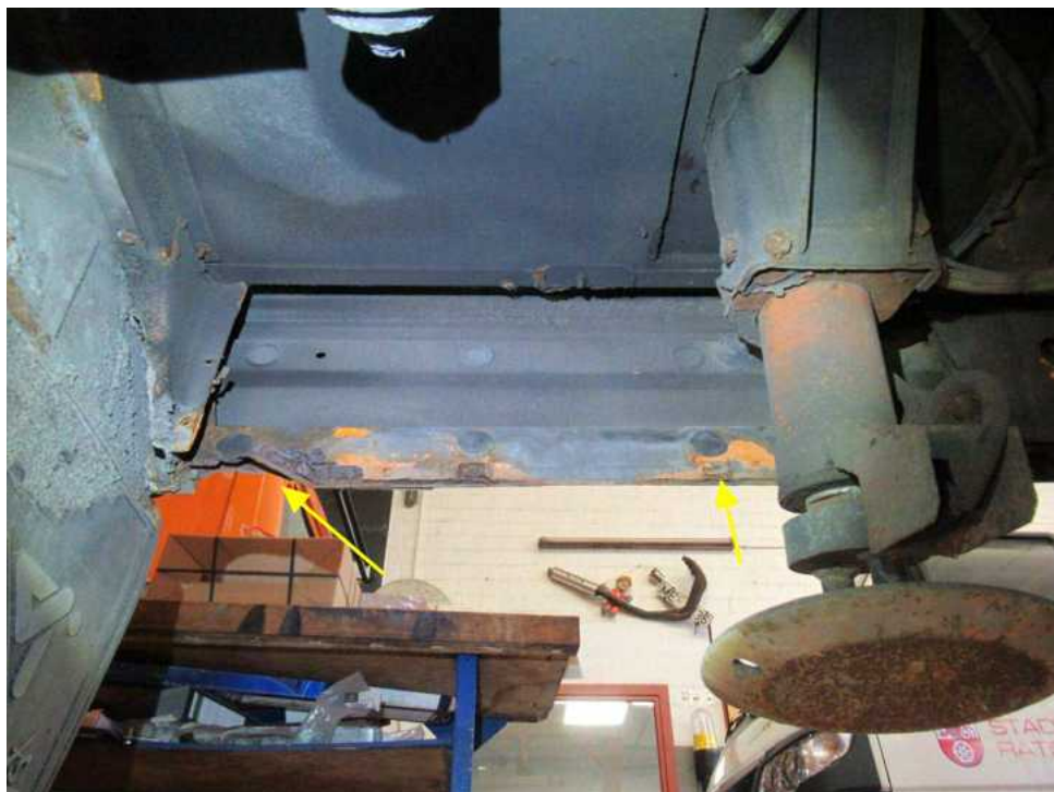
Bild 30 : Radläufe der hinteren Seitenwände starker Rostbefall
