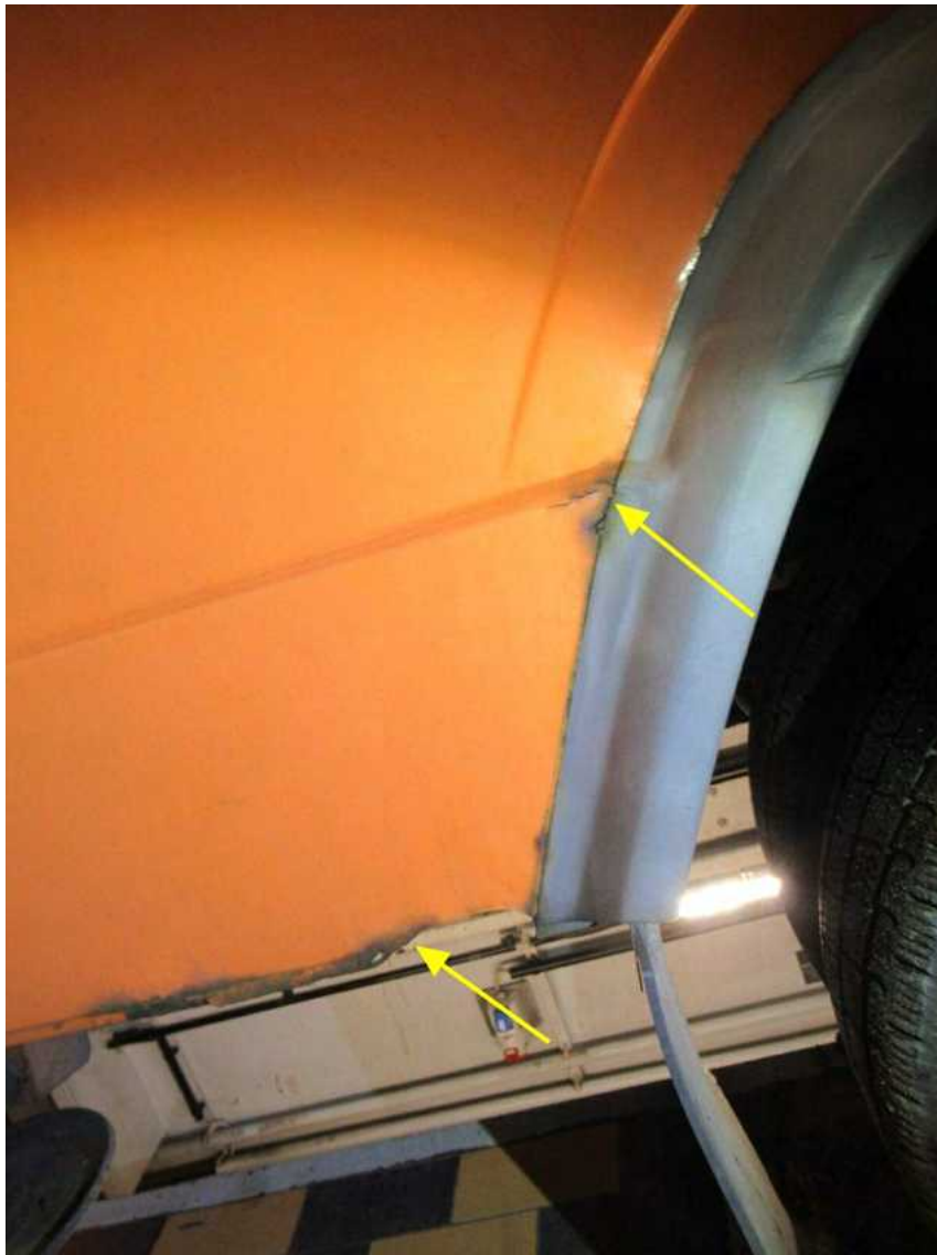
Bild 28 : Radläufe der hinteren Seitenwände starker Rostbefall
