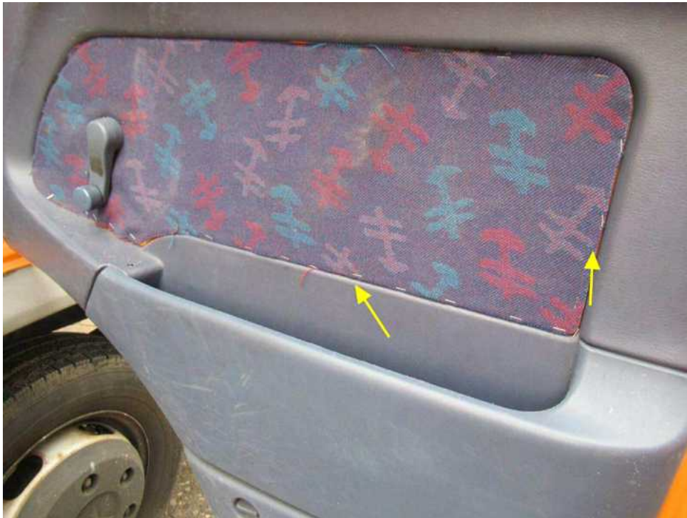
Bild 17 : Türverkleidungen vorne links und rechts provisorisch verklebt und getakert
