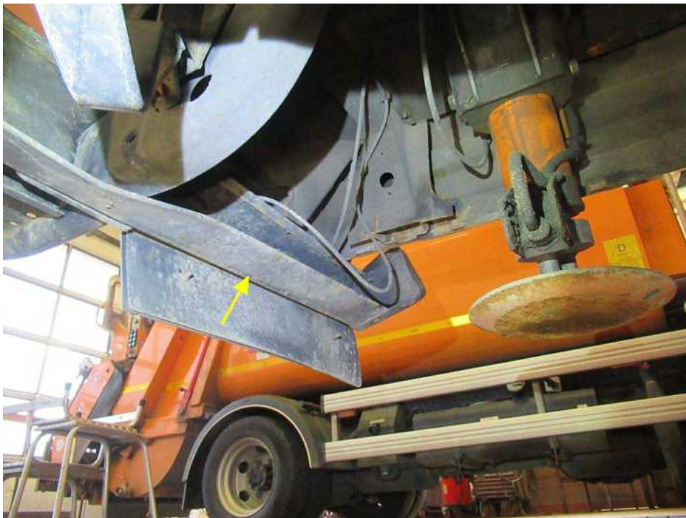
Bild 40 : Heckunterfahrerschutzteil links verformt
