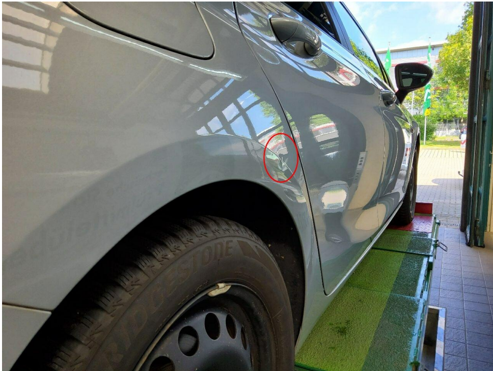
Bild 7 : Seitenwand hinten rechts eingedellt
