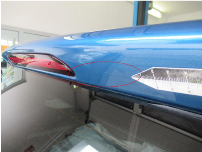
Bild 1: Außen, Heckspoiler - Lackierung, zerkratzt, schleifen und polieren
