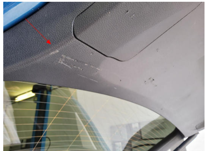
Bild 4: Innen, Verkleidung Heckklappe, verschrommt, erneuern
