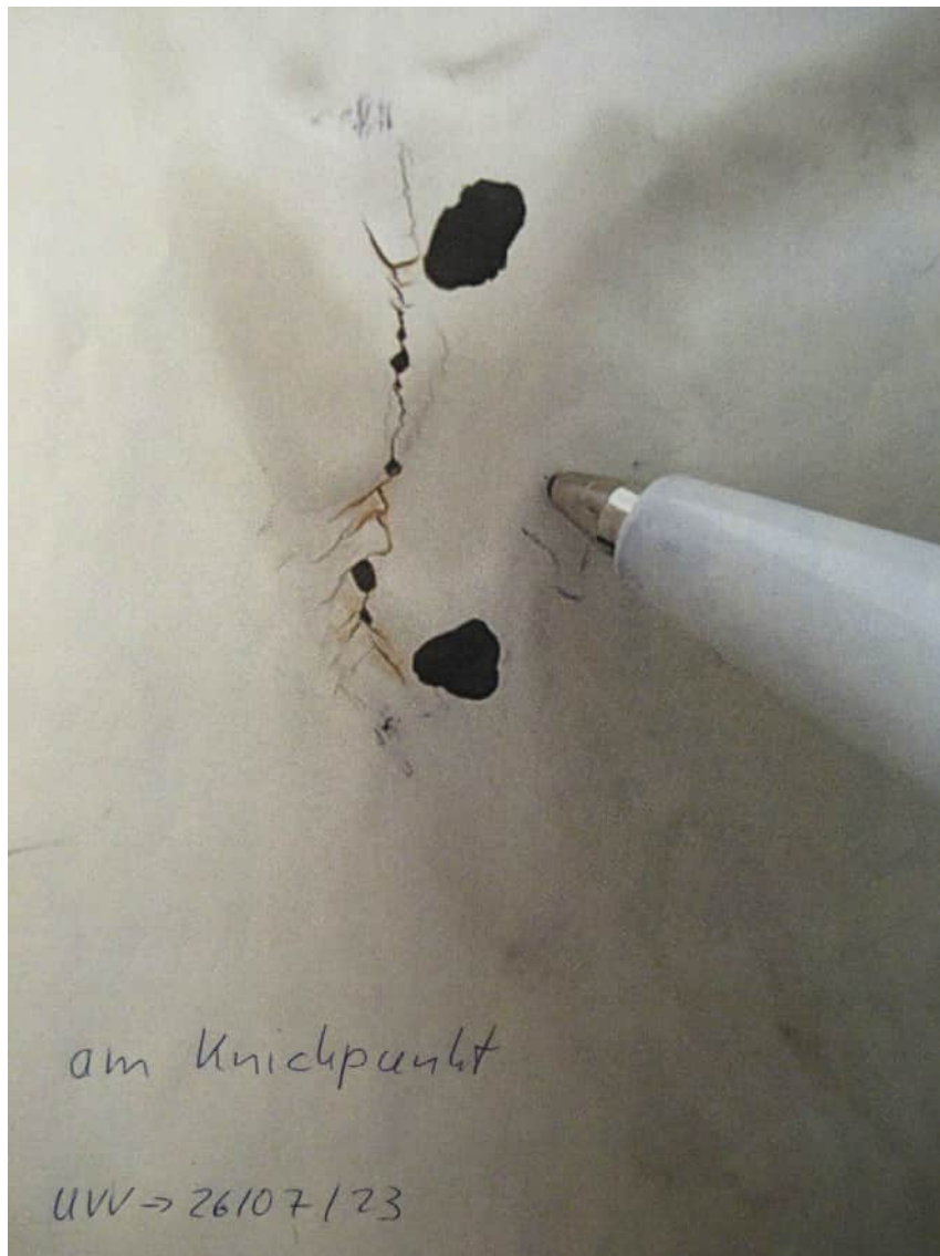
Bild 15 : Haarriss an der Schweissnaht des Korbarms und am Knickpunkt
