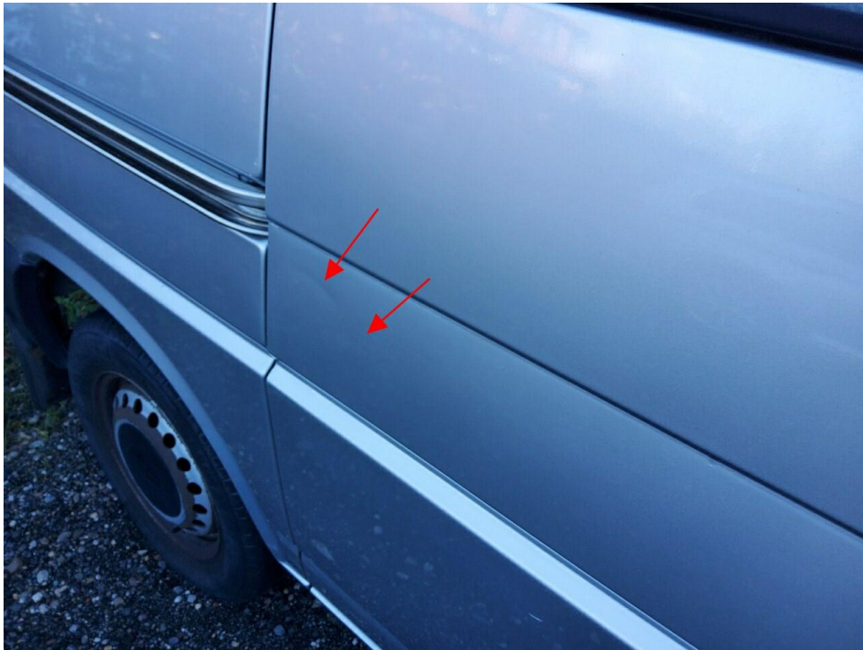
Bild 7 : Tür hinten rechts deformiert
